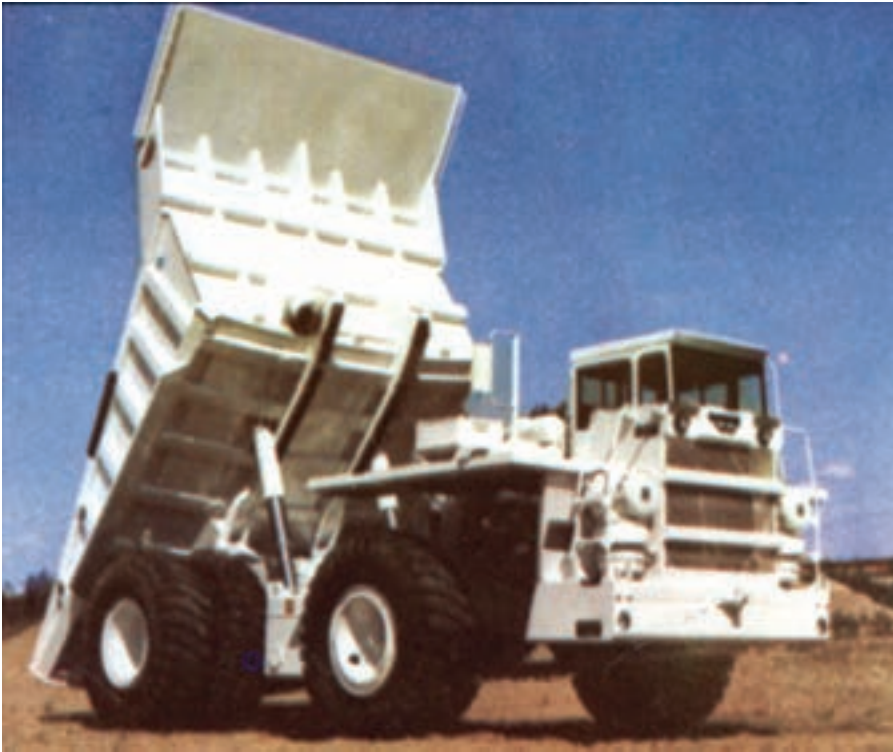
شکل ۴۰-۴- یک کامیون معدنی تخلیه شونده از پشت
