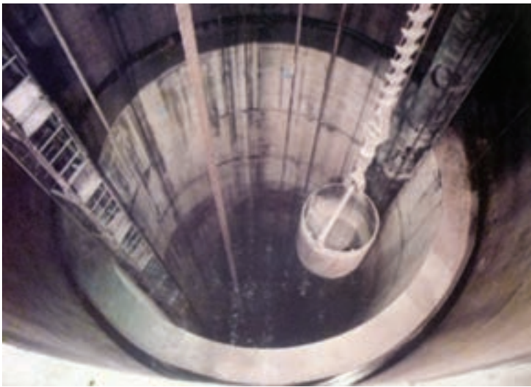
شکل ۶-۶- دهانه چاه اصلی در یک معدن
