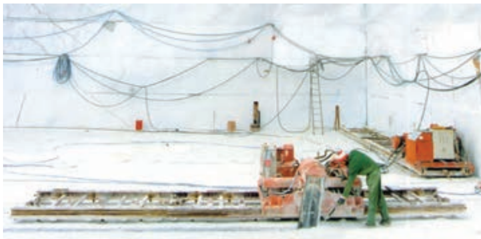
شکل ۱۶-۵- تیغه برنده در حالت برش قائم
