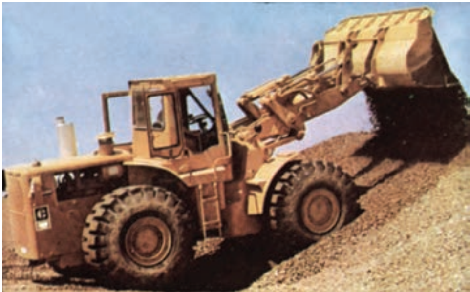
شکل ۱۳-۴- خاک برداری به وسیله لودر
