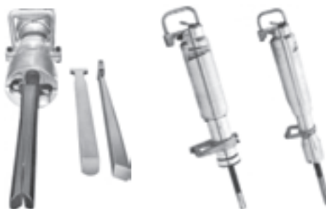
شکل ۷-۵- دستگاه پاس و گوه هیدرولیکی (داردا) و نحوه عملکرد با آن
