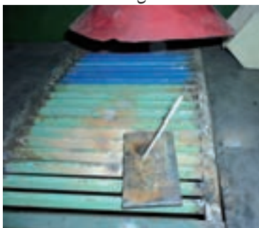
شکل ۴-۸b، الکتروود چسبیده به قطعه کار
