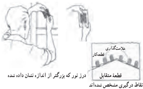
شکل ۳-۸- روش درز نوری
