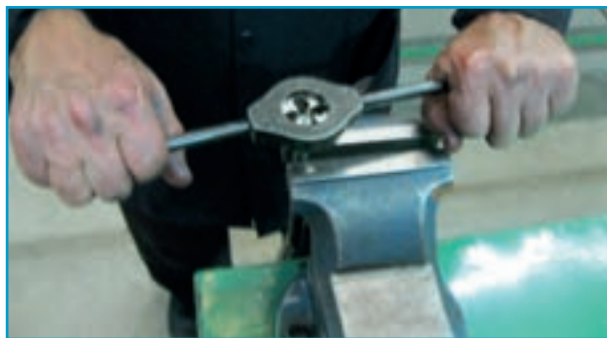
شکل ۶-۱۲ - نحوه اعمال نیرو در حديد‌کاری
