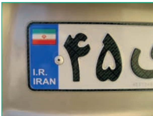
شکل ۲-۷- اتصال پلاک خودرو
