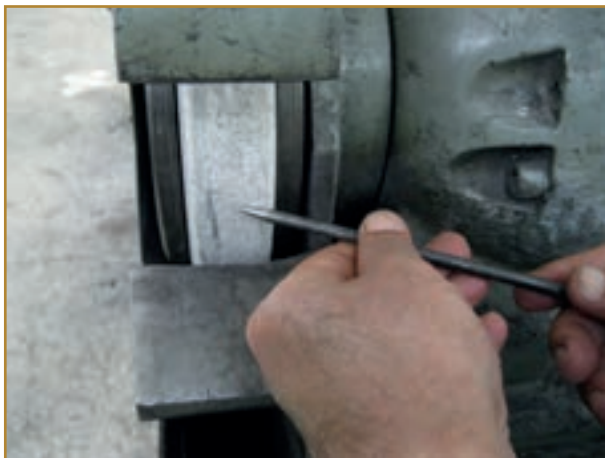
شکل ۹-۱۴- تیزکردن سوزن خطکش
