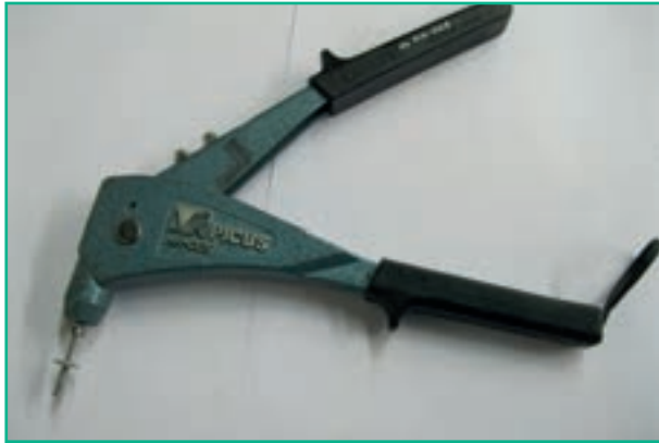
شکل ۷-۱۲- جا زدن پرچ روی انبر پرچ
