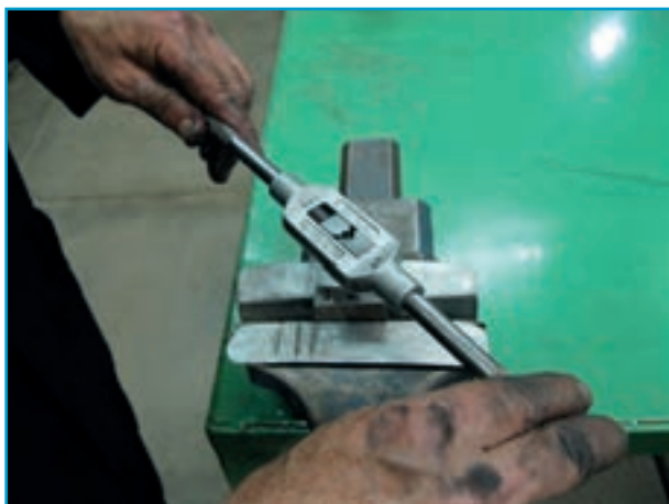
شکل ۶-۲۲- جا انداختن قلاویز
