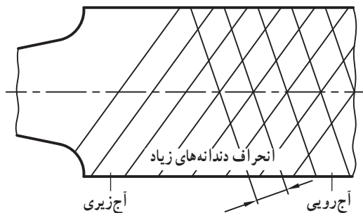
شکل ۴-۹- وضعیت آجها با زوایا و گام های مختلف
