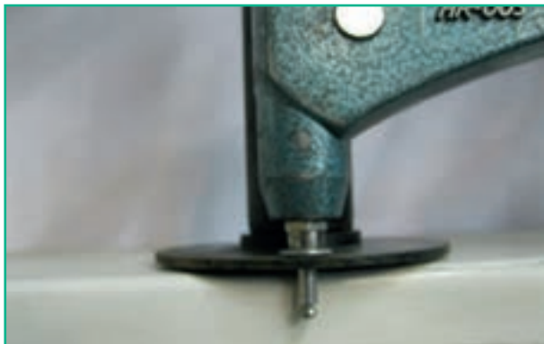
شکل ۷-۱۳- جا زدن پرچ داخل سوراخ
