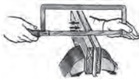
شکل ۱۷-۳- ااره‌کاری قطعات نازک
