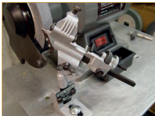
شکل ۱۹-۹- تیز کردن مته به کمک ابزار مخصوص
