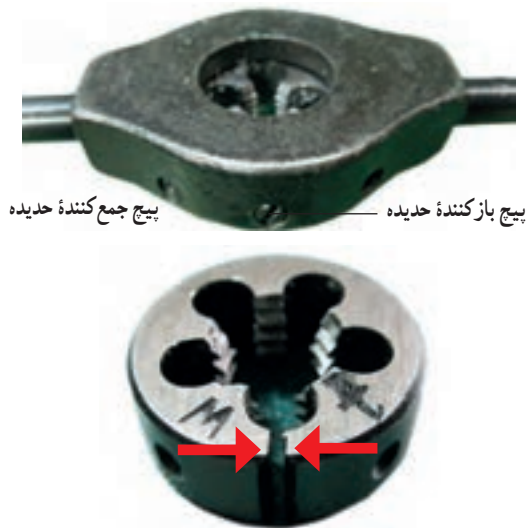
شکل ۶-۱۱ - دسته حديد برای حديد‌های درزدار
