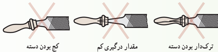
شکل ۲۳-۴ - نامناسب بودن دسته سوهان
