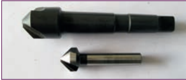
شکل ۱۵-۵- مته‌خزینه‌های دنباله مخروطی و دنباله استوانه‌ای
