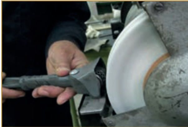
شکل ۸-۹- صاف کردن سنگ
