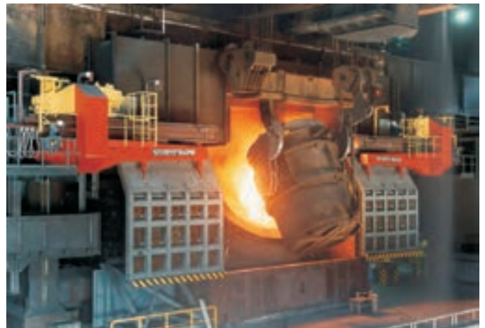
شکل ۱۷-۱ ریختن مذاب در قالب‌های شمش‌ریزی
