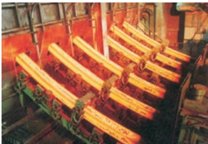
شکل ۲۰-۱ شمش‌ها در حین خروج از کوره‌ی تولید فولاد و نوردکاری
