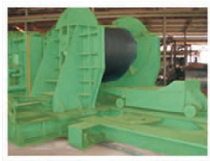
شکل ۴-۱۸ واحد باز کردن ورق ها
