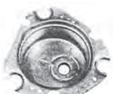
شکل ۲-۳۸ ایجاد برجستگی برای جوشکاری
