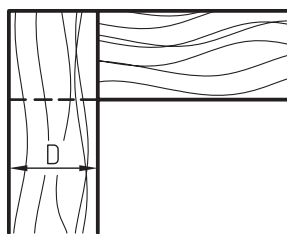
شکل ۹-۳۶- ب) طریقه‌ی ترسیم اتصال دم چلچله‌ی ساده در نما.
