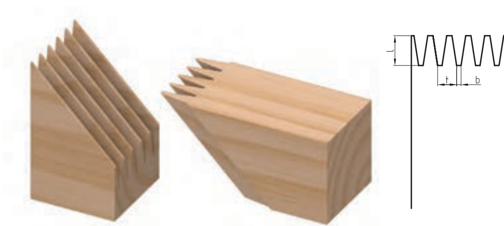
شکل ۹-۳۰. اتصال گوشه‌ای شانه‌ای، در سه اندازه‌ی مختلف
