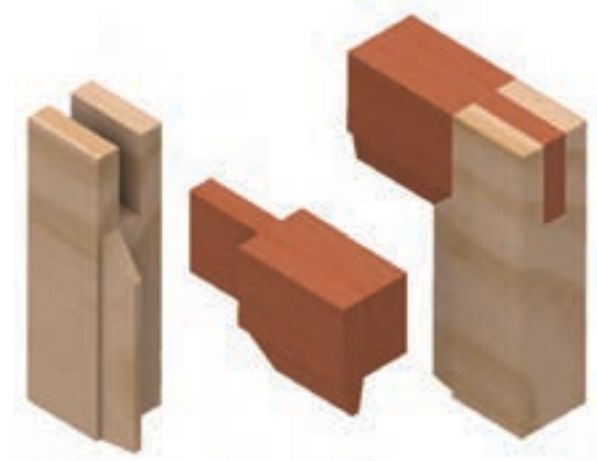
شکل ۹-۱۴- اتصال گوشه‌ای فاق و زبانه‌ی ساده با دوراهی و پیچ فارسی.
