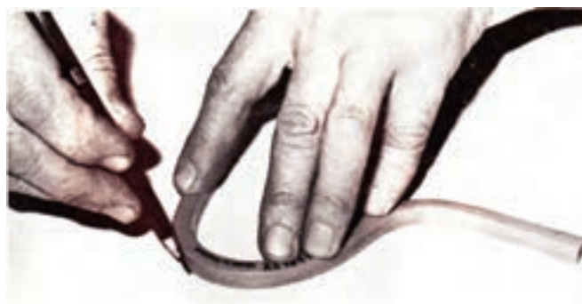
شکل ۲-۵۴- نمونه‌ی ترسیم خط منحنی توسط پیستوله‌ی ماری.
