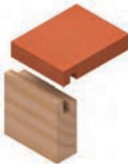
شکل ۹-۱۴۵- اتصال گوشه‌ی صفحات یک رو مخفی، با دو کنشکاف و دو زبانه.
