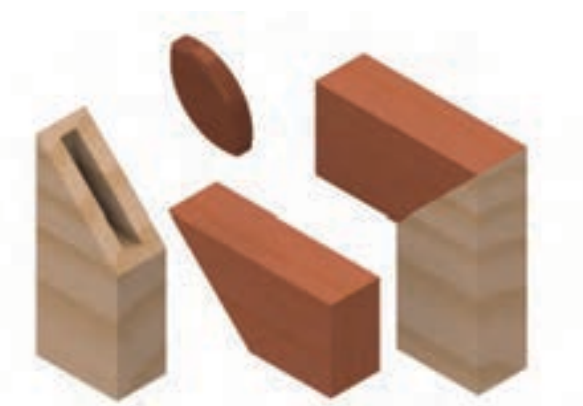
شکل ۹-۲۵- اتصال گوشه‌ای دو رو فارسی مخفی با زبانه‌ی کوتاه بیضی‌شکل (اتصال بیسکوییتی).
