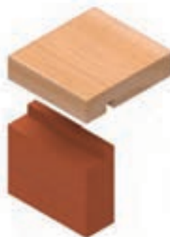
شکل ۹-۱۴۶- اتصال گوشه‌ی صفحات دو رو مخفی (فارس‌ی)، با دو کنشکاف و دو زبانه.
