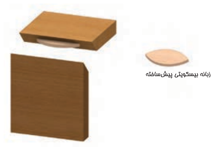
شکل ۹-۶۹- اتصال گوشه‌ی بیسکوییتی.
