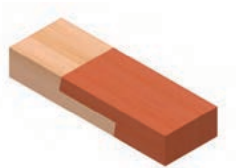
شکل ۹-۷۴- اتصال طولی نیم و نیم سرکج.
