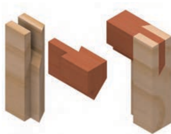
شکل ۹-۱۴- اتصال گوشه‌ای فاق و زبانه‌ی ساده با دوراهی و پیچ فارسی.
