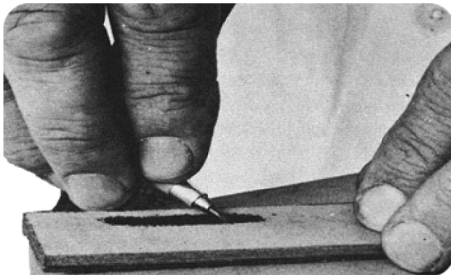
شکل ۲-۸- تیز کردن و فرم دادن مغز مداد توسط تفت‌هی سنباده.
