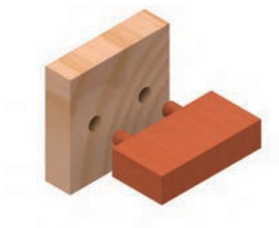
شکل ۹-۵۲- اتصال گوشه‌ی صفمات دوبرل با افتلاف سطح.
