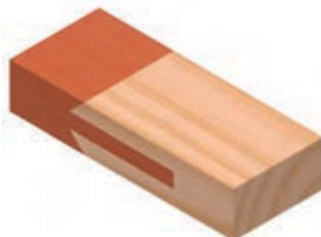
شکل ۹-۷۷- اتصال طولی فاق و زبانه‌ی سرکج.
