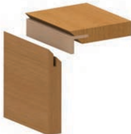
شکل ۹-۶۳- اتصال گوشه‌ی صفحات قلیف، با زبانه‌ی پیش ساخته از مواد مصنوعی.
