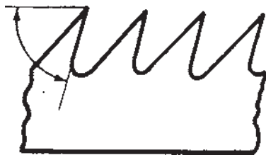
شکل ۱۰-۲- زاویه برش کمتر از ۹۰ درجه
