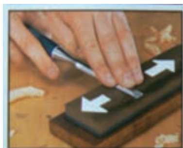
شکل ۵-۴۶ - طریقه تیز کردن مغار
