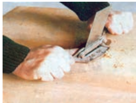
شکل ۳-۶- نحوه استفاده از رنده لیسسه
