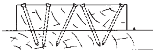
شکل ۵-۷۴- کوبیدن میخ به صورت دم چلچله
