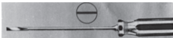
شکل ۷-۱۴ - آچار پیچ گوشتی دو سو (دوپهلو)
