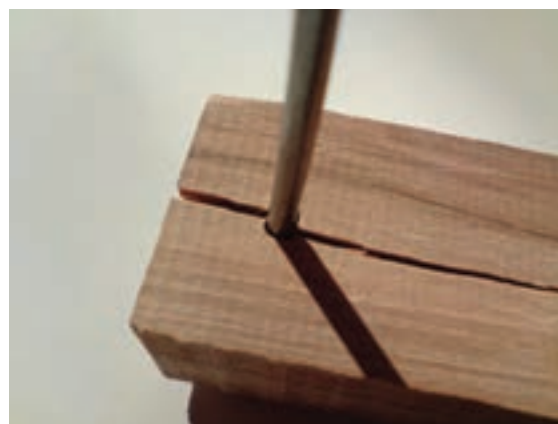
شکل ۵-۷۲- ترک خوردن راه الیاف
