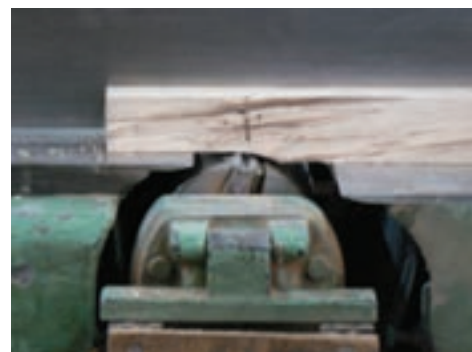
شکل ۵-۲- طریقه صحیح نصب تیغه
