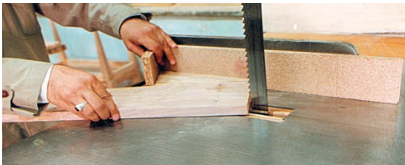
شکل ۱۵-۱- روش استفاده از شابلون برای برشهای مثلی
