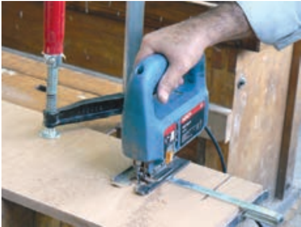
شکل ۲-۲۹- استفاده از گونیا در برش
