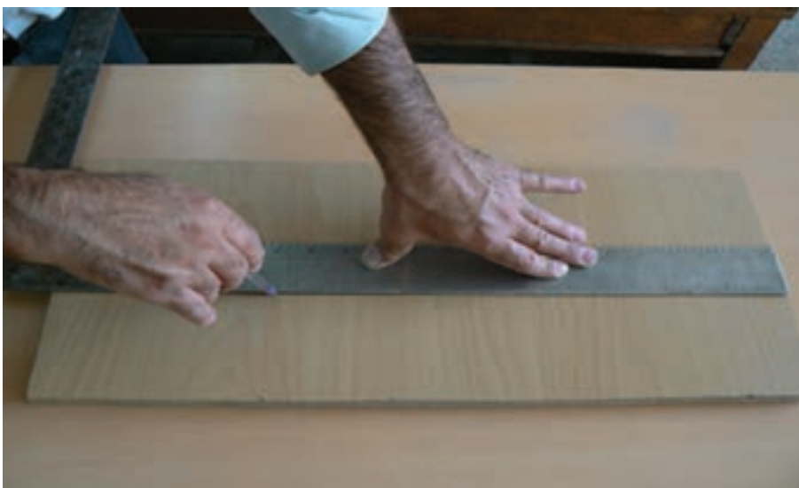
شکل ۹-۱- بر راستی و روش استفاده از آن
