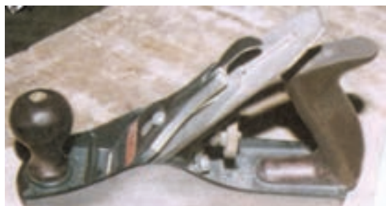
شکل ۲۰-۳- رنده پرداخت آهنی
