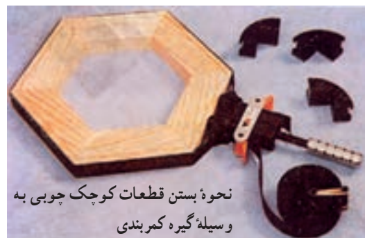
شکل ۲-۸ - گیره کمر بندی تسمه‌ای
