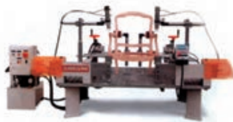
شکل ۶-۷- پرس مونتاز صندلی جهت مبل و صندلی‌سازی
