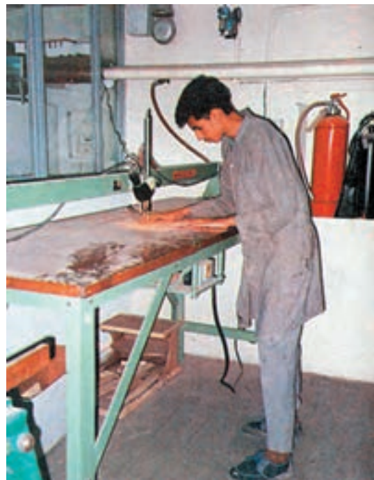
شکل ۱۷-۱- روش کار با اره مشبک‌بری
