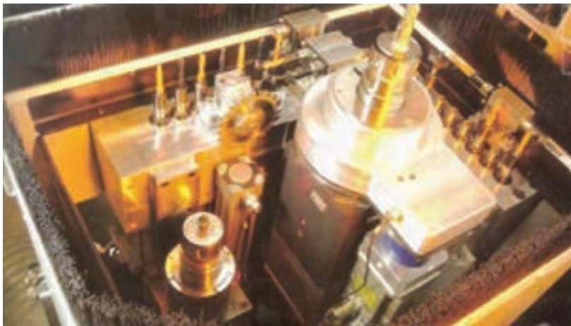
شکل ۸-۳۵- هد ماشین های CNC با ابزارهایی که بر روی آن تعبیه شده و قادر به انجام فرایندهای ماشین کاری مختلفی مانند: برشکاری، سوراخ کاری و شیارزنی است.
