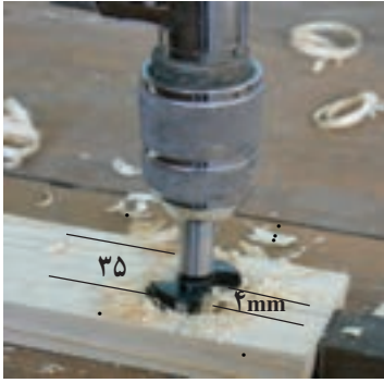
شکل ۴-۲۶- نحوه سوراخ کردن جای لولا فنر
