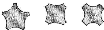
نمای مقطع تغییر شکل یافته میخ‌های سوئدی
