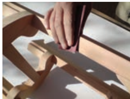
شکل ۶-۶- طرز سنباده زدن بعد از آب زدن بکار
