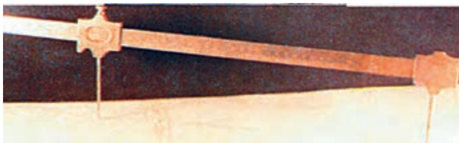
شکل ۱-۱۰- پرگار بزرگ میله ای
