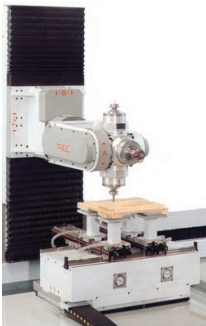
شکل ۸-۲۴- ابزار زدن با دستگاه C.N.C تنظیم شده بر روی فیکسچر
