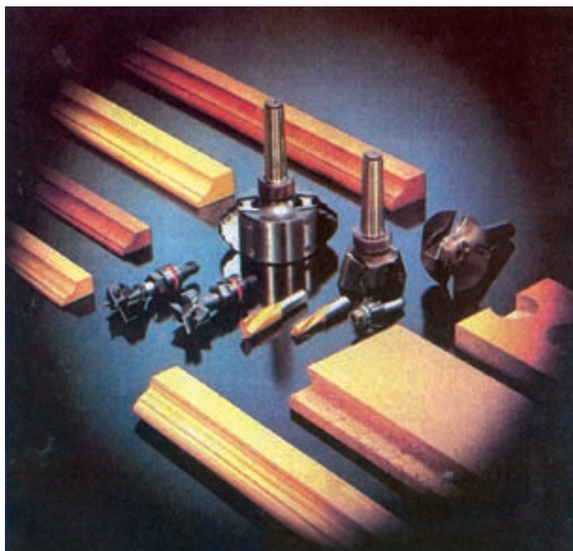
شکل ۸-۸- تیغه‌های اورفرز با فولاد HSS
