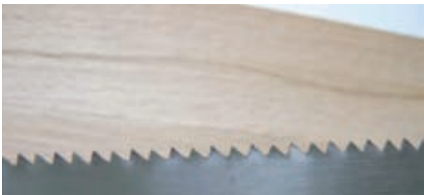
شکل ۱۱-۲- دندانه های اره شکاف زن
