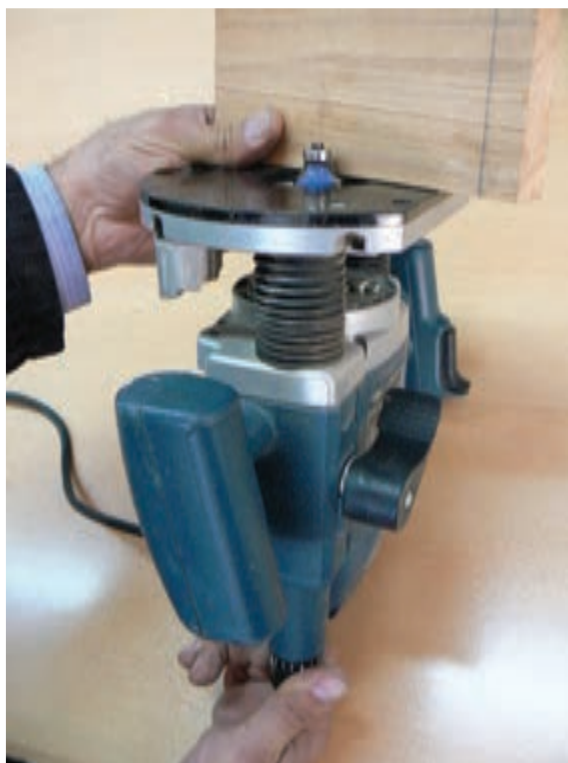
شکل ۱۲۷-۵- روش تنظیم تیغه
