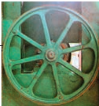
شکل ۴-۱- فلکه پایین اره نواری به همراه بانداز
