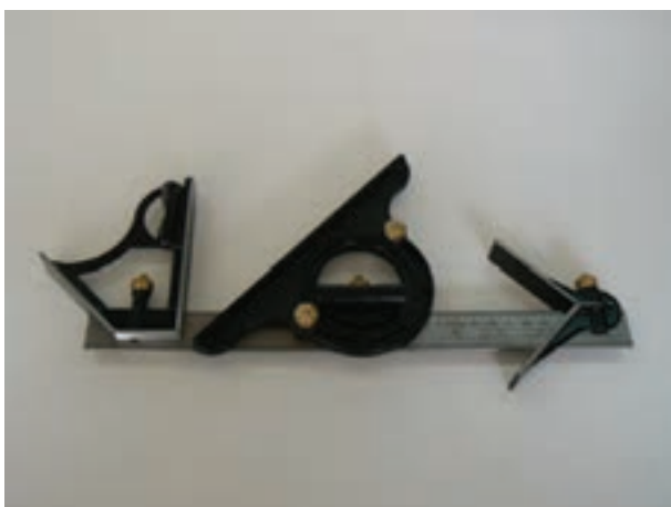
شکل ۱-۵- قسمتهای مختلف یک گونیای ساده و مرکب
