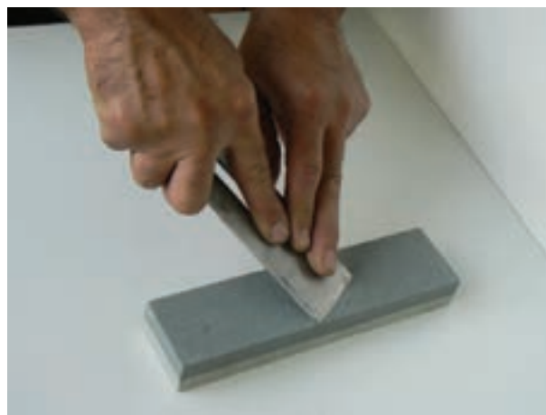
شکل ۳۴-۳- روش سنگ نفت زدن تیغه رنده
