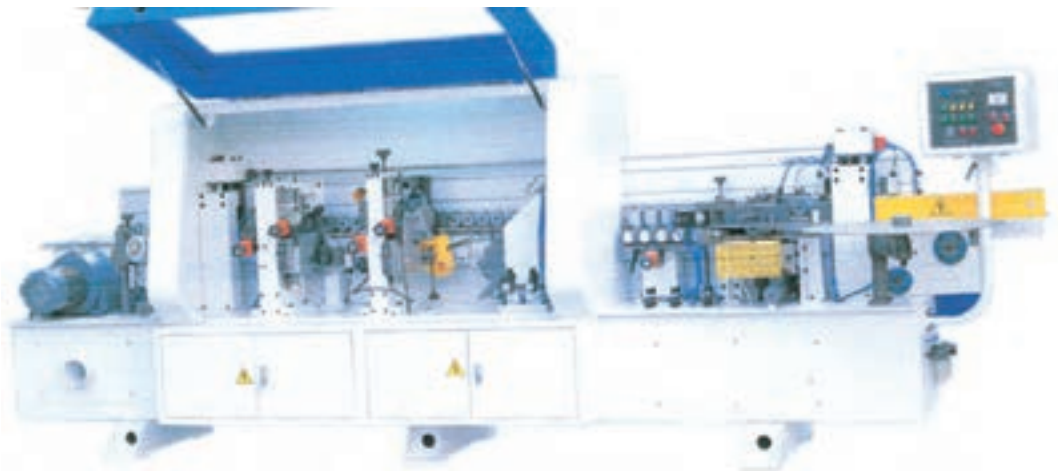
شکل ۱۸-۷- دستگاه C.N.C نوار چسبانی
