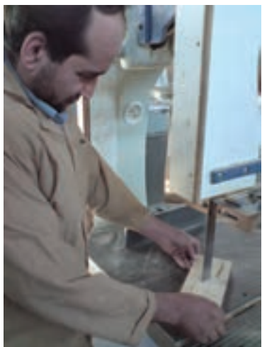
شکل ۱-۱۳- نحوه بریدن قطعات قوسدار
