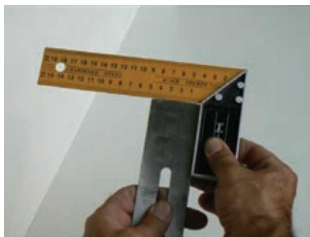
شکل ۳۳-۳- گونبایی کردن سر تیغه رنده
