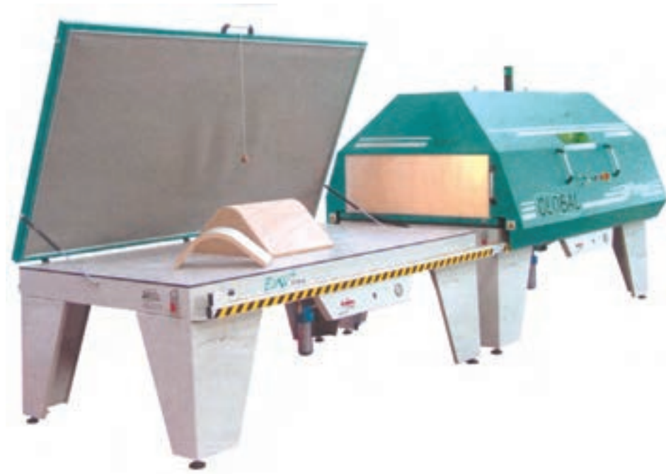
شکل ۹-۷- پرسهای خاص جهت قطعات ویژه با روکشهای آکرلیک یا سنگهای مصنوعی روکشهای آکرلیک
