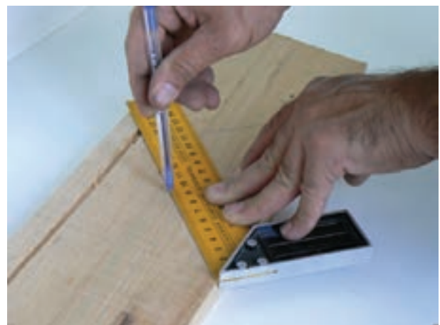
شکل ۱-۵- قسمتهای مختلف یک گونیای ساده و مرکب
