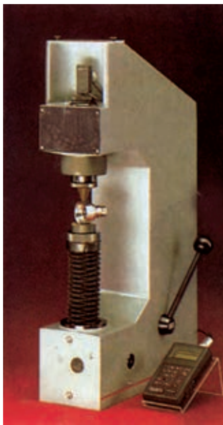
شکل ۸-۱۵ - سختی سنج با نمایشگر دیجیتالی
