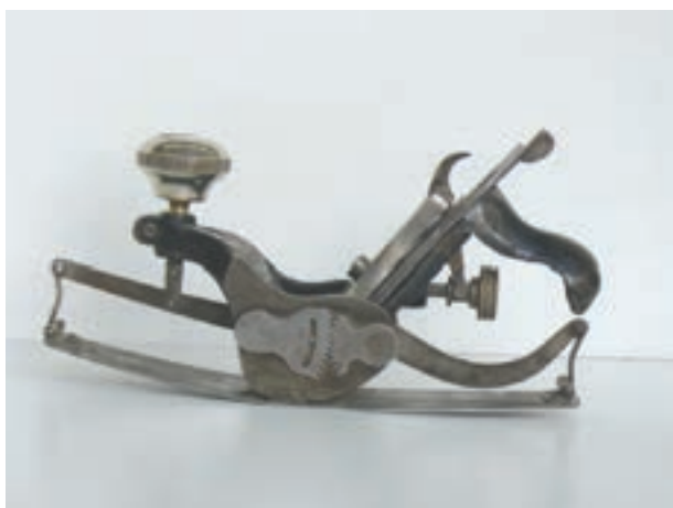
شکل ۳-۳۱ رنده کف گرد (رنده کاس و سینه)
