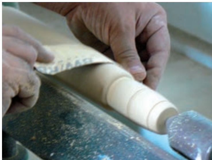
شکل ۹-۵- نحوه سنباده زدن با ماشین خراطی
