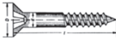
شکل ۲-۹۴- پیچ سرمخروطی برآمده
