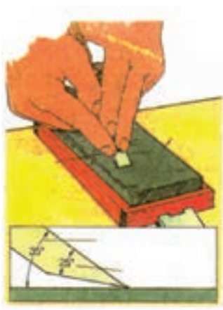
شکل ۳۰-۴- تیز کردن تیغ ابزار با سنگ نفت
