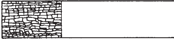
شکل ۴۰-۱- تخته خرده چوب تدریجی
