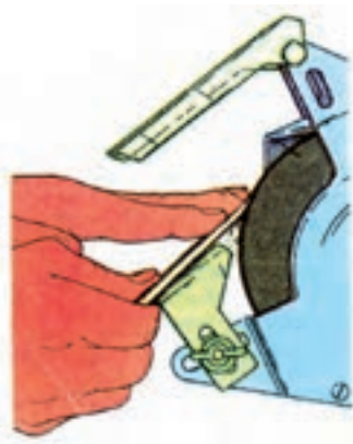
شکل ۱۲-۴ تیز کردن ابزار با سنگ سنباده
