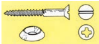
شکل ۲-۹۸- پیچ سرتخت خزینه ای
