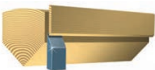
تراشه‌زنی در جهت عمود بر دایر سالیانه (به صورت عرضی)
