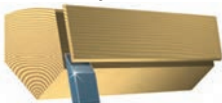
تراشه‌زنی در جهت بینابینی (به صورت عرضی)
