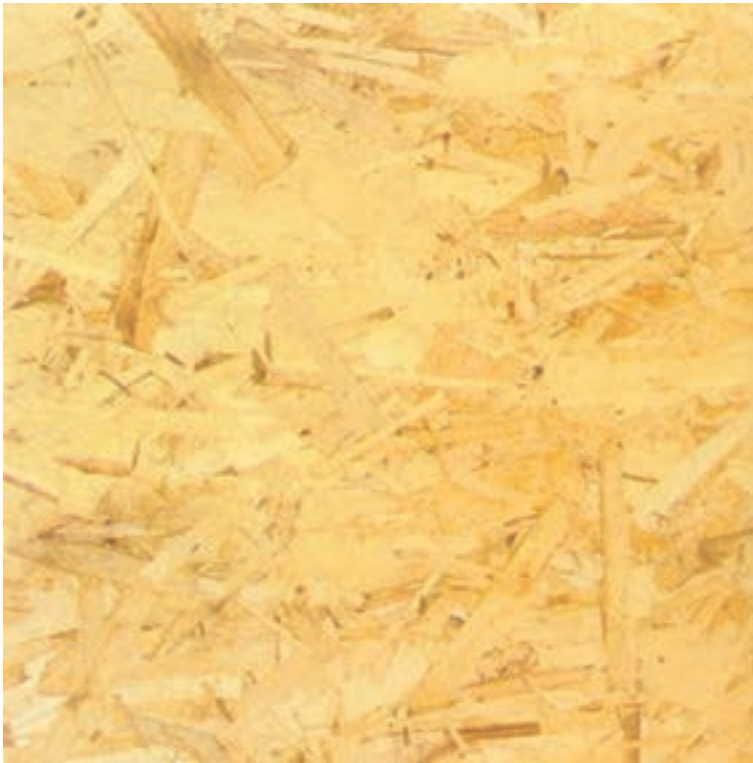
شکل ۲۸-۱- نمونه‌ای از تخته تراشه
