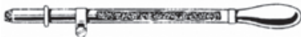
شکل ۳۵-۴- سنگ تیزکن با فرم لوله‌ای پر شده از پودر الماس و کربور تنگستن
