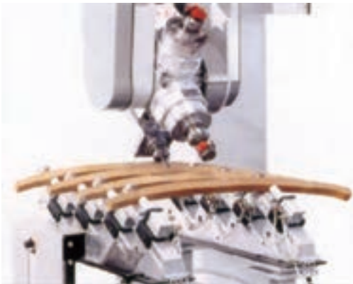
شکل ۱۸-۵- سوراخ‌زنی و کُم‌کنی قطعات گرد و قوسدار به وسیله‌ی فرز کم‌کنی و کم‌کنی متغیر
