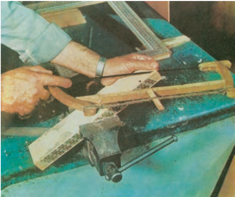
شکل ۱۶-۶- نحوه برش قامه و تهیه دو زاویه
