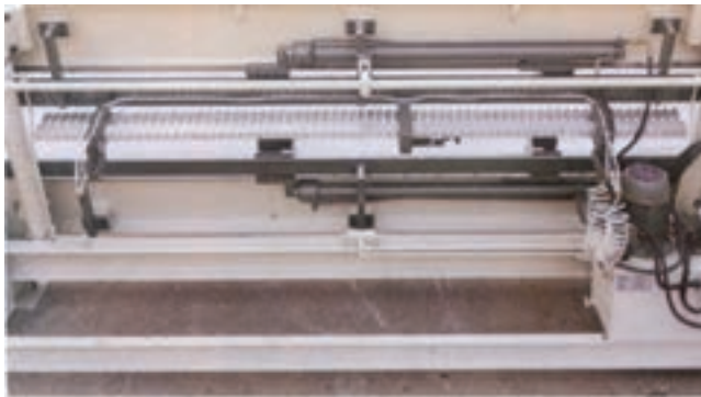
شکل ۷۵-۵- تنگ پنوماتیکی برای مونتاژ قاب
