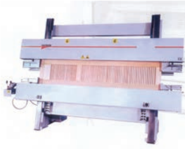
شکل ۵۶-۵- تنگ پنوماتیکی برای جمع کردن و چسباندن قاب چوبی
