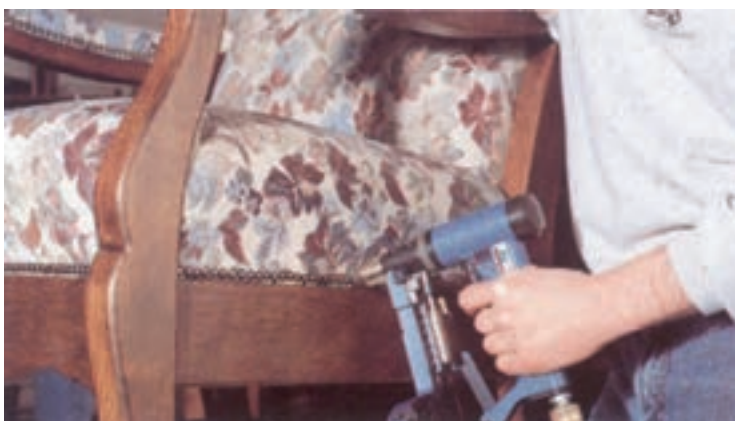
شکل ۷۲-۵- نوارکوبی درز دوخت رویه کوبی
