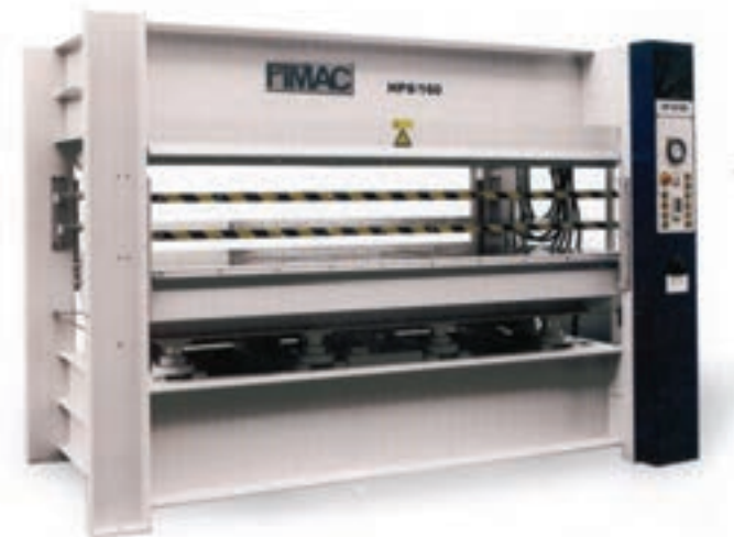
شکل ۵-۷۶ پرس هیدرولیک چارچوب در و پنجره
