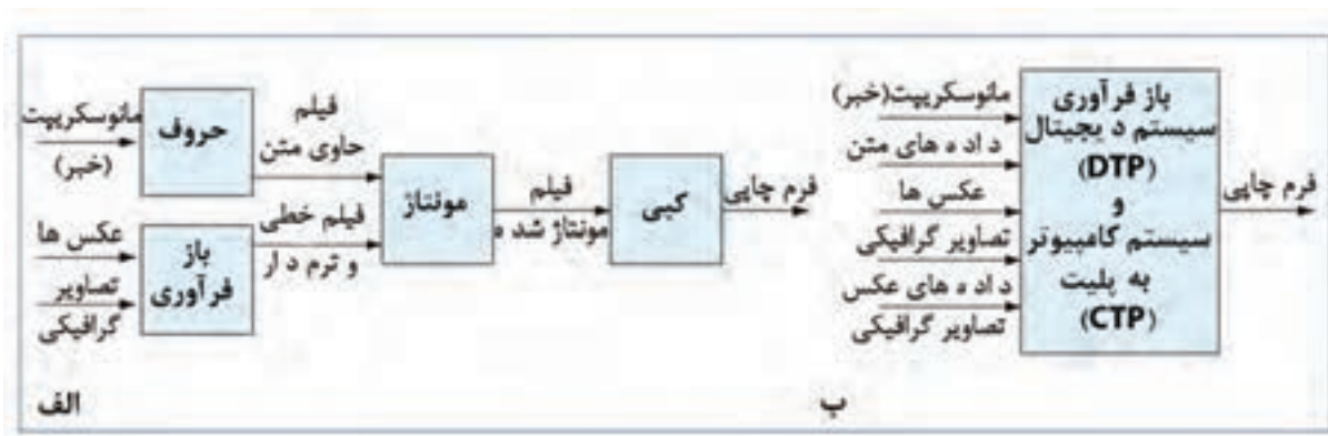
شکل ۱-۲۰- پیشرفت و توسعه در پیش از چاپ با دیجیتالی کردن کارها الف: سنتی پیش از چاپ (۱۹۸۰) ب: مراحل پیش از چاپ دیجیتالی (۱۹۹۷)
