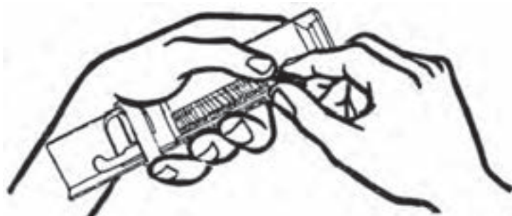
شکل ۵-۱- ورساد و چگونگی چین حروف در آن
