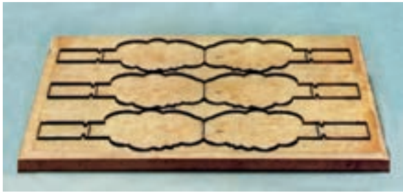
شکل (۳-۱۴) یک نمونه قالب برای فرم غیرهندسی
