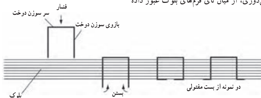
شکل ۵-۵- روش کار دوخت مفتولی و انواع بست مفتولی
