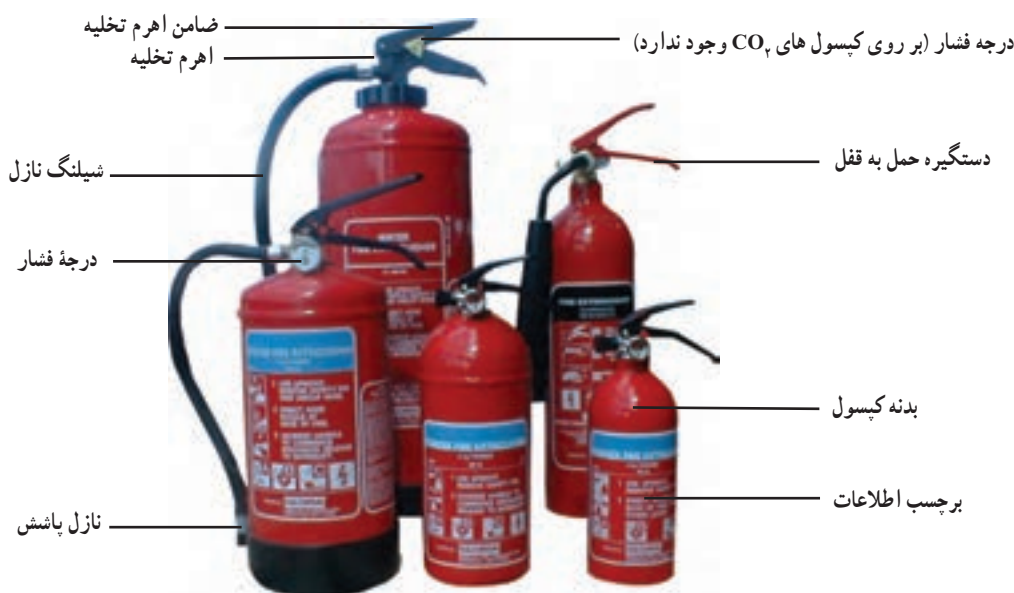
شکل ۲-۲- اجزای کیسول های اطفای حریق
