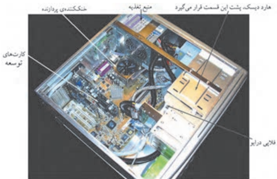
شکل ۱۸-۴ اجزای داخلی یک Case رایانه
