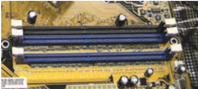
شکل ۳ محل قرار گرفتن RAM روی برد اصلی
