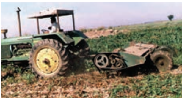
شکل ۲-۱۰- ماشین برگ‌زن با پره لاستیکی
