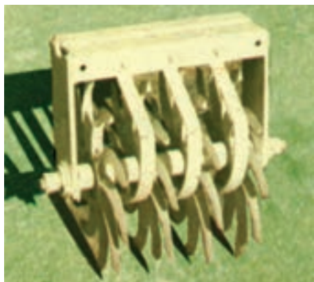
شکل ۱۰-۱- یک واحد چرخ پرده پنجه غلتان
