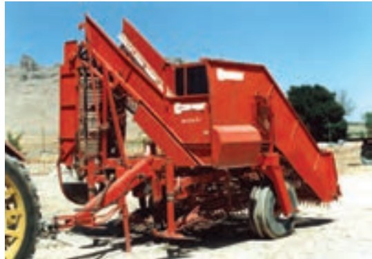
الف- بردارنده بارکن در حالت حمل
