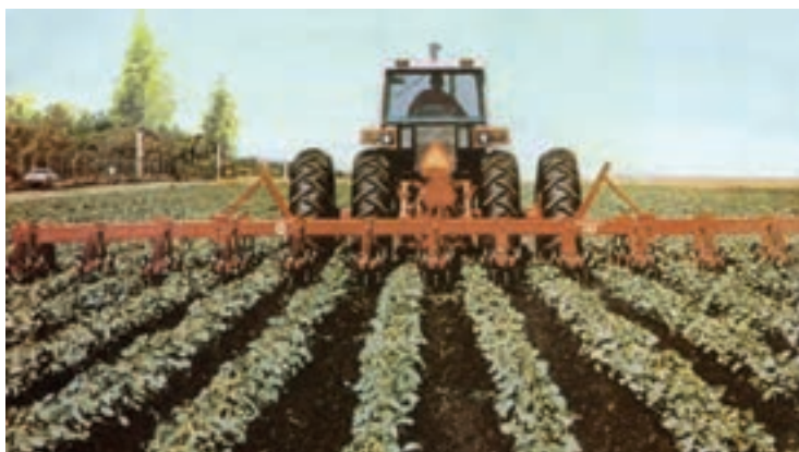
شکل ۱-۱- عملیات وجین با پنجه در کشت ردیفی
