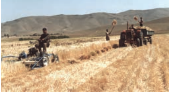
شکل ۱۳-۸ - دستگاه درو دسته‌بند در حین عملیات
