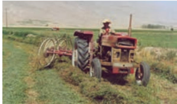
شکل ۸-۵- شانه در حال کار
