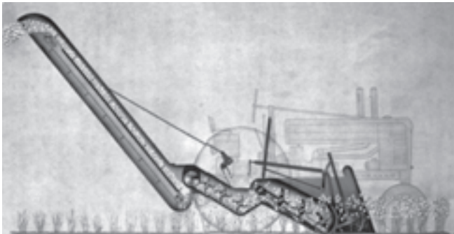
الف — مسیر عبور پنبه در غوزه‌چین
