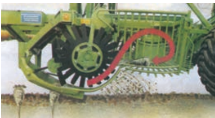
ب - قسمت سرزن و بردارنده کمباین
