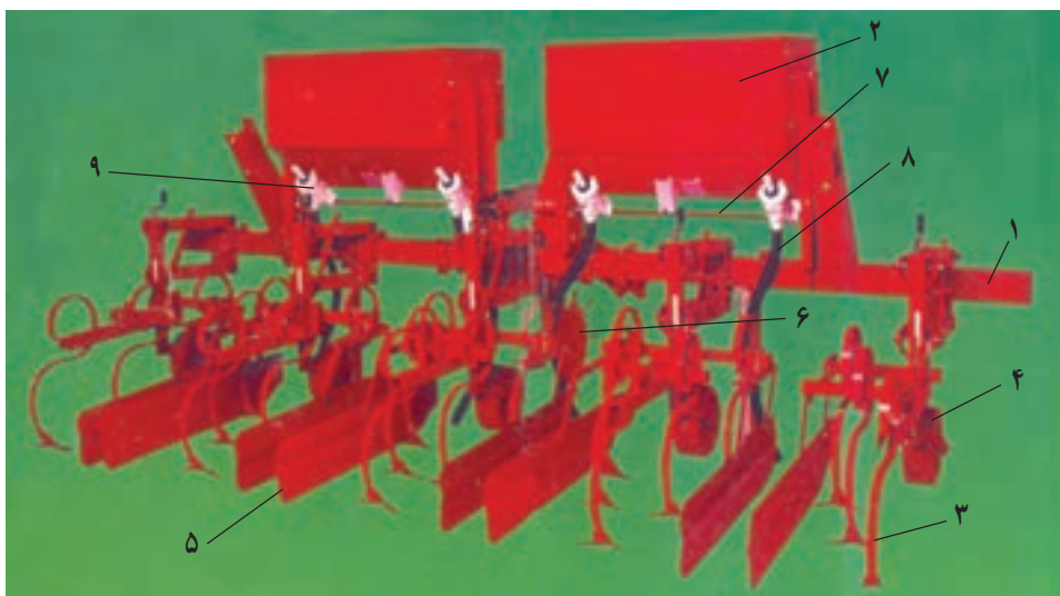
۱- شاسی ۲- صندوق کود ۳- شاخه ۴- چرخ ۵- سپر محافظ ۶- چرخ ستاره ای محرک موزع کودپاشی ۷- محور موزع ها ۸- لوله سقوط کود ۹- موزع
