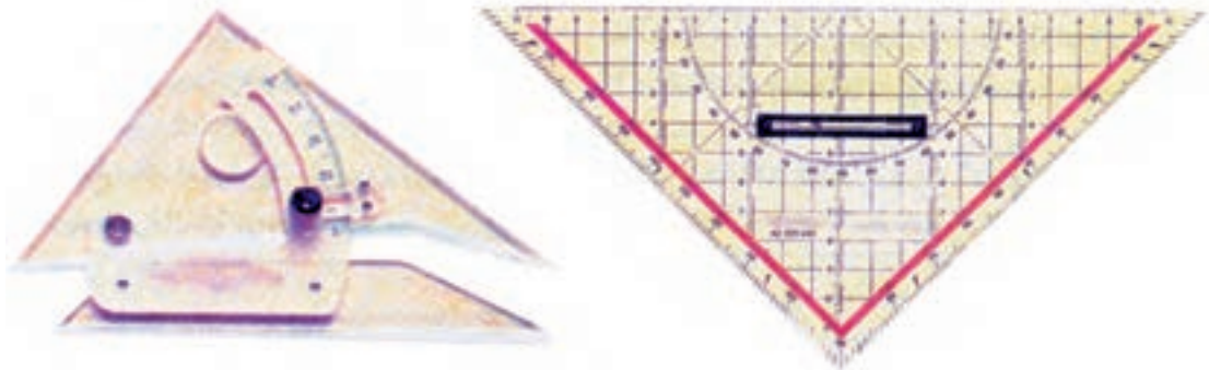
شکل ۱۲- نمونه‌های گونیای ثابت و متغیر نشان داده شده است.
