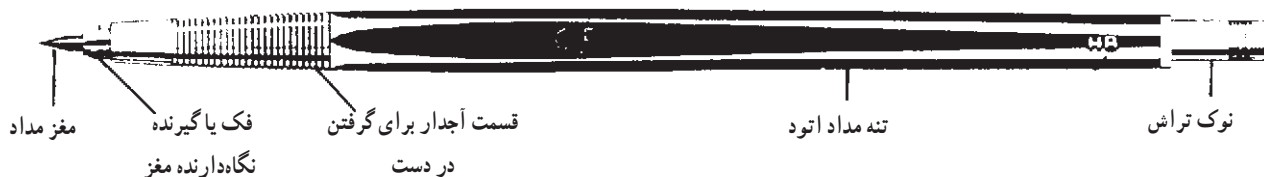
شکل ۷- مداد اتود و قسمت‌های مختلف آن
