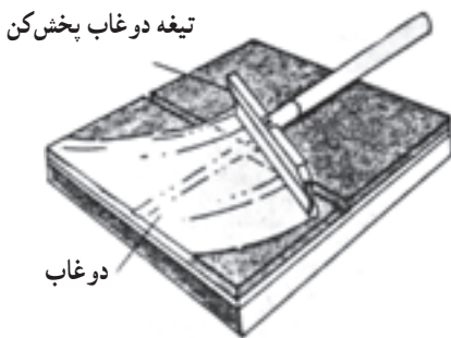
شکل ۲-۸- نحوه بندکشی کاشی شامل مراحل پهن کردن دوغاب و تمیز کردن سطح کاشیها
