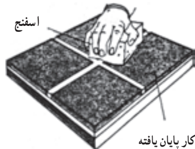
شکل ۲-۸- نحوه بندکشی کاشی شامل مراحل پهن کردن دوغاب و تمیز کردن سطح کاشیها
