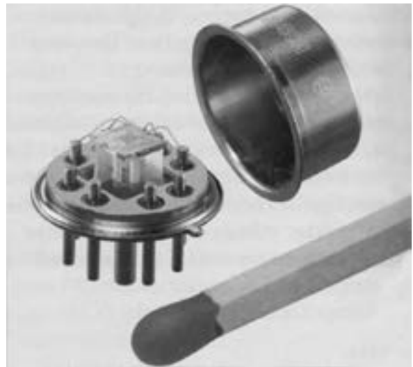
شکل ۲-۶۷- المنت حسگر اندازه‌گیر فشار با درپوش و خلأ مرجع داخلی
