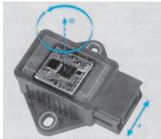
شکل ۲-۵۹- جهت دریافت شتاب \alpha - مقدار انحراف زاویه‌ای یا \Omega
