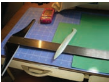
شکل ۱-۳۱ خط کش تی فلزی با سر ثابت
