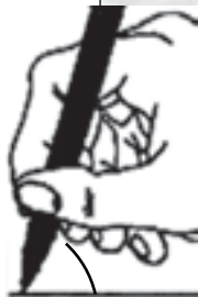
شکل ۳-۱۳ زاویه‌ی قلم کمتر از ۸۰ درجه نباشد.
