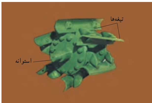
شکل ۲-۳- استوانه خردکننده به همراه تیغه‌ها
