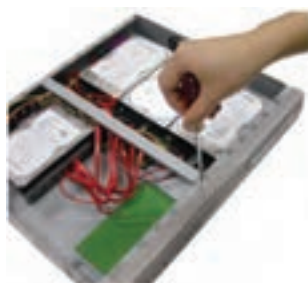
شکل ۶۸-۳ دیسک سخت نصب شده در داخل دستگاه
