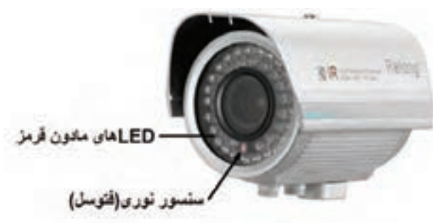
شکل ۹-۳ لامپ (LED) های تولید کننده نور مادون قرمز
