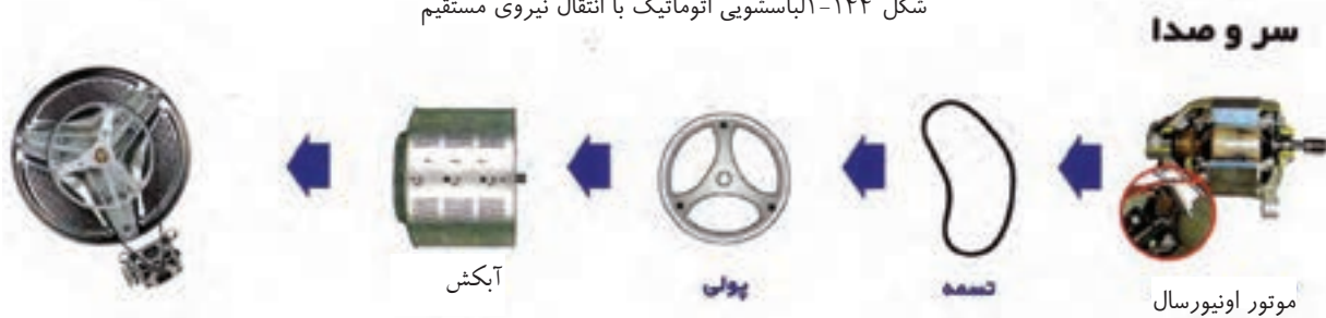
شکل ۱-۱۴۵-الباسشویی اتوماتیک با انتقال نیروی غیرمستقیم
