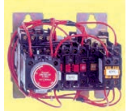
تایمر پنوماتیکی نصب شده روی کنتاکتور (b) شکل ۱-۲۶۳
