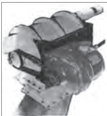
شکل ۱-۱۱۰- انتقال قدرت با چرخ و زنجیر
