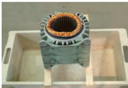
شکل ۴-۲۴- قرار دادن استاتور روی وان
