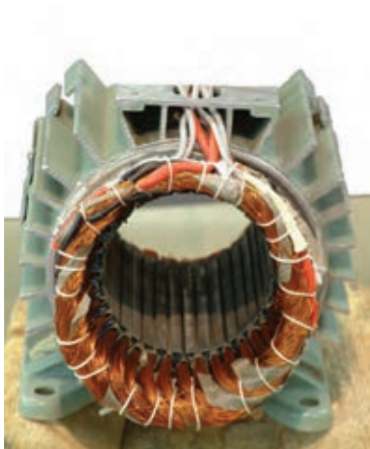
شکل ۴-۱۷– نمایش استاتور نخ‌بندی شده از دو سمت
