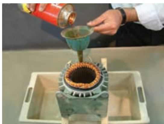
شکل ۴-۲۵- ریختن شارلاک روی سیم‌ها
