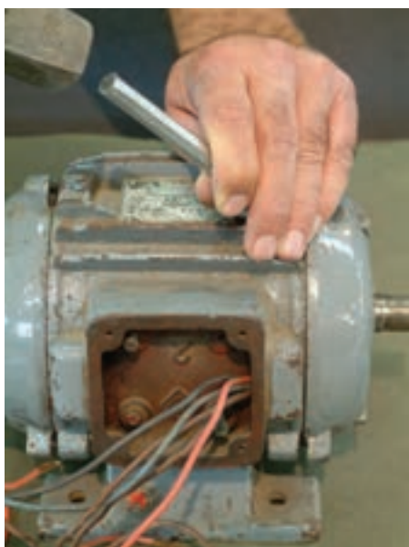
شکل ۱-۲۶- باز کردن درپوش موتور
