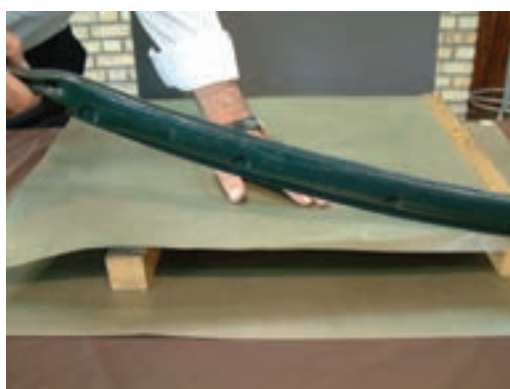
شکل ۲-۲۹ — کاتر یا دستگاه برش دهنده‌ی عایق‌های برشمان
