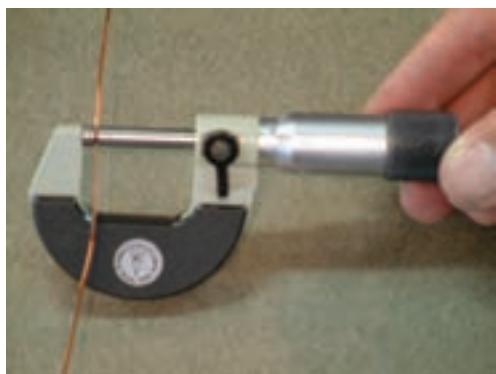
شکل ۱۶-۳ ب- اندازه‌گیری قطر سیم
