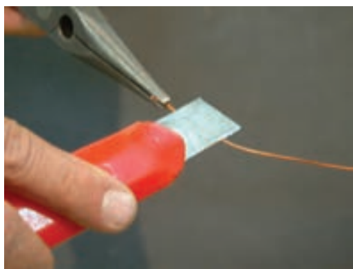
شکل ۴-۱ ج - پاک کردن لاک به روش تراشیدن
