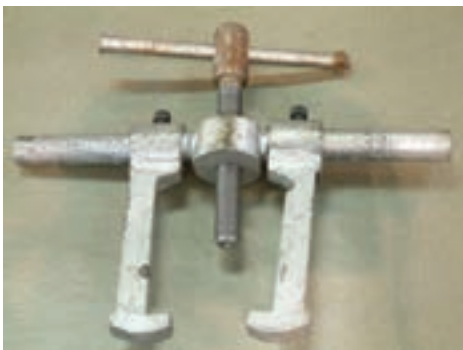
شکل ۱-۴۸- ابزار در آوردن بوش و یاتاقان‌های استوانه‌ای
