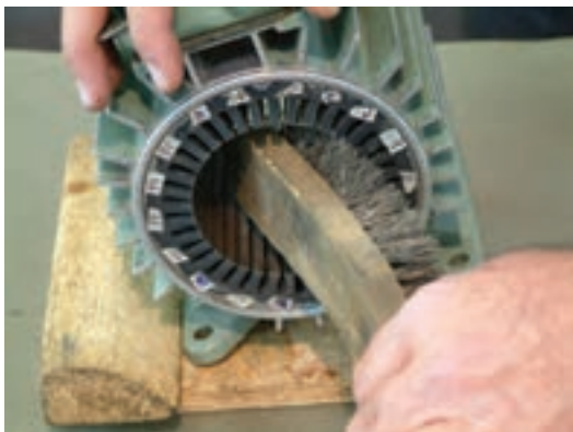
ب – تمیز کردن استاتور با برس سیمی
