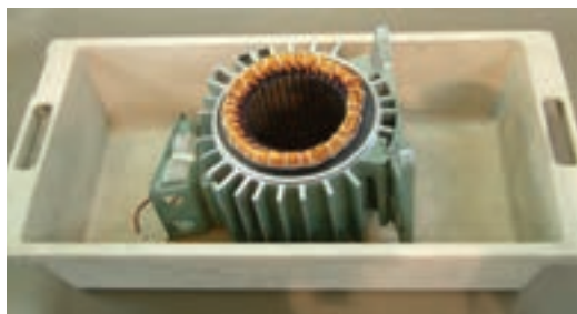
شکل ۴-۲۱- قرار دادن استاتور در درون وان شارلاک
