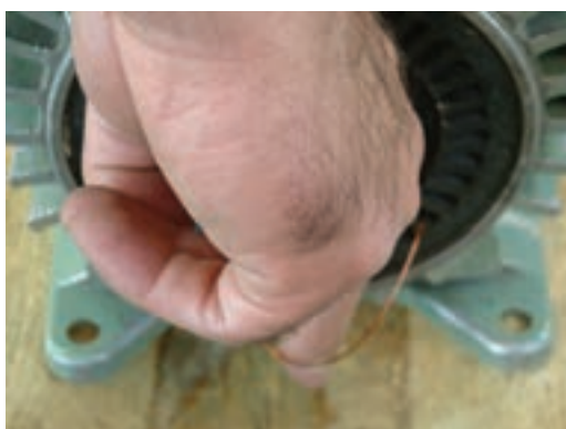
شکل ۳-۴- تعیین حدود قالب از طریق گام سیم‌بندی
