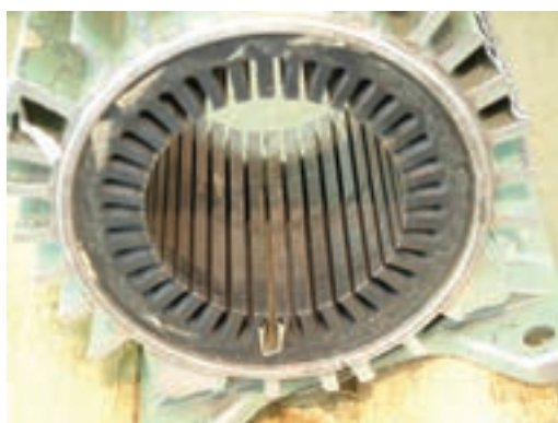
ب — اندازه کردن ابعاد عایق با ابعاد شیار شکل ۲-۲۸ — تنظیم عایق برشمان در شیارهای استاتور
