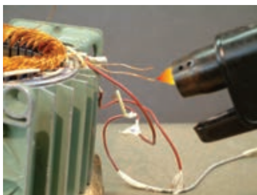
شکل ۴-۱ ب - پاک کردن لاک به روش سوزاندن
