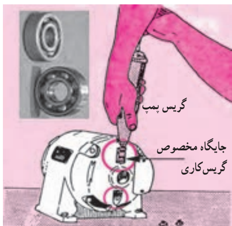
شکل ۱-۳۳ - گریس کاری بلبرینگ‌ها
