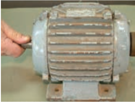
شکل ۱-۴۵- بررسی لقی بوش‌ها
