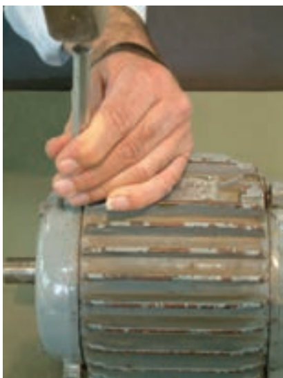
شکل ۱-۲۳- علامت‌گذاری روی پوسته و درپوش‌ها
