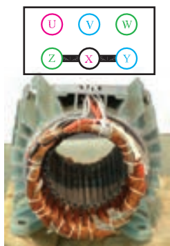
شکل ۶-۶- اتصال انتهای سه فاز به همدیگر
