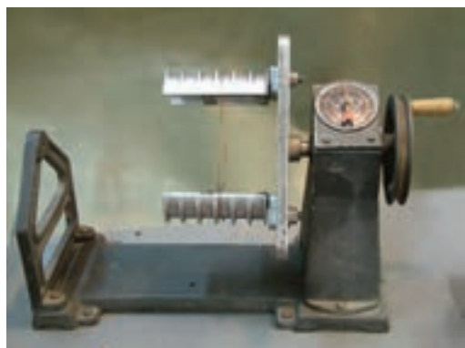
شکل ۳-۵- تنظیم قالب‌ها براساس اندازه‌ی کلاف
