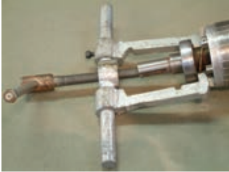
شکل ۱-۴۶- استقرار بلبرینگ کش روی محور روتور
