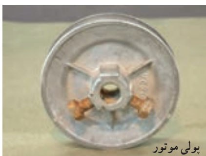
شکل ۱-۲۵- باز کردن پولی موتور
