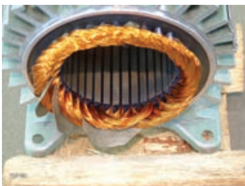
شکل ۲-۳۱- عایق کاری پیشانی کلاف‌ها
