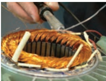
شکل ۴-۷- لحیم کاری محل اتصال سیم ها
