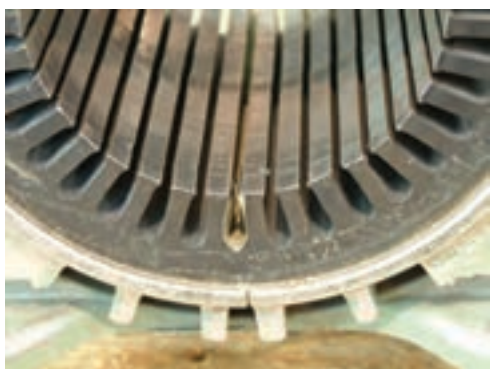
شکل ۲-۳۳- اندازه گیری محیط شیار
