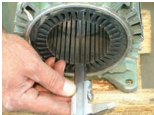
شکل ۲۶-۲- اندازه گیری محیط داخلی و طول شیار
