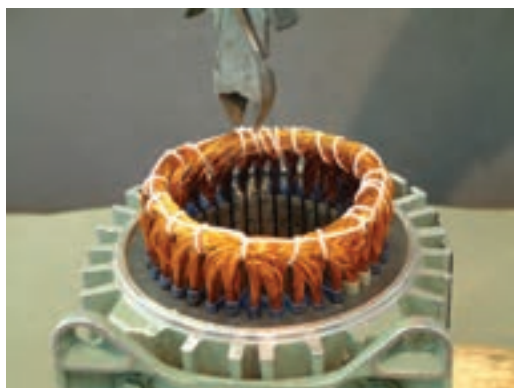
شکل ۲-۱۳ – چیدن نخ‌های کلاف‌بندی با سیم‌چین
