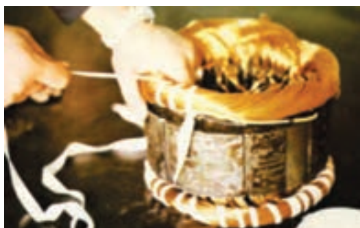
شکل ۴-۱۸– نواربندی سیم‌های استاتور
