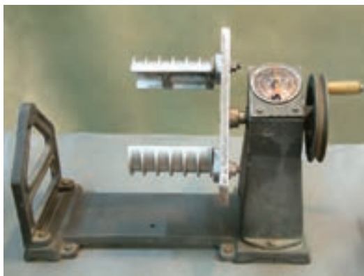
شکل ۳-۱۵- تنظیم اندازه‌ی قالب‌ها در کلاف پیچ
