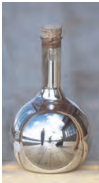
تشکیل آینه نقره‌ای هنگام اکسایش متانال
