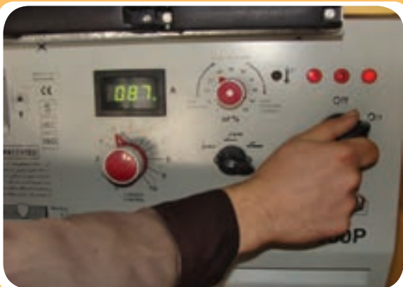
کلیدهای مختلف روی صفحه اصلی رکتی‌فایر جوشکاری
