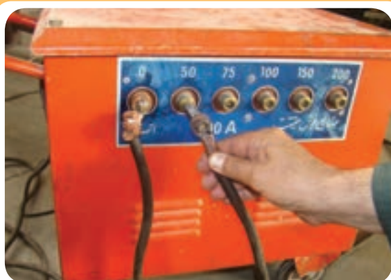
تنظیم آمپر در دستگاه ترانسفورماتور پله‌ای
