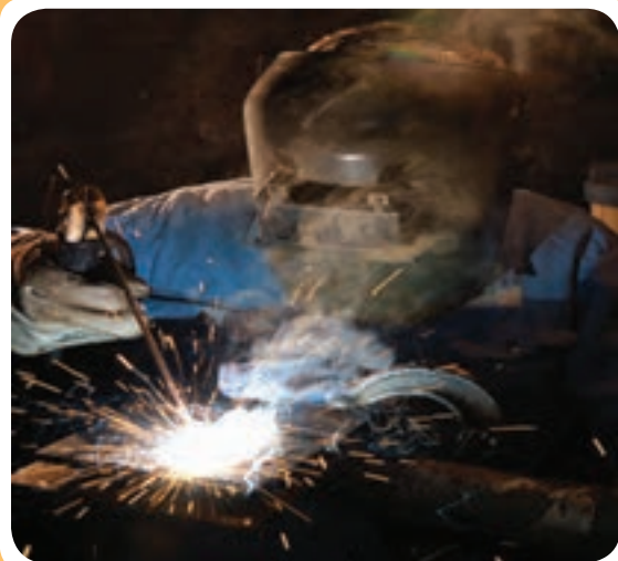
تخلیه بار الکتریکی بین نوک الکترود و سطح قطعه کار سبب ایجاد قوس می‌شود.
