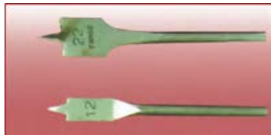
شکل ۱۲-۱۸. سر مته‌ی برگی ثابت.
