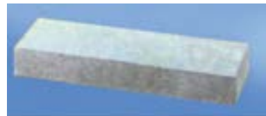
شکل ۱-۱۴- سنگ نفت یکنواخت.
