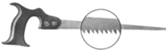
شکل ۵-۱۳- اره نوکی، با بزرگنمایی دندان‌ها.
