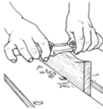
شکل ۴۴-۶- نمونه‌ی رندیدن قوس‌های دافلی.
