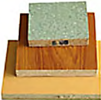
شکل ۳-۱۴۶- تخته فرده چوب با روکش مصنوعی.
