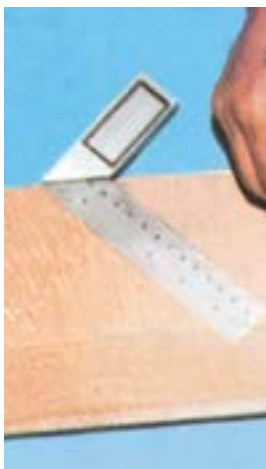
شکل ۶-۱۰۴- خط‌کشی فطوط ۴۵ درجه به وسیله‌ی گونیای معمولی.
