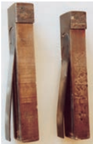
شکل ۲-۹- آهن نگهدارنده‌ی قطعه کار.
