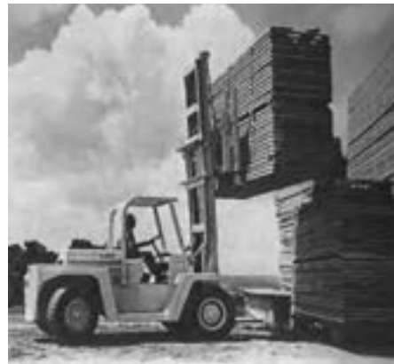
شکل ۳-۳۹- جابجایی دسته‌بندی به وسیله‌ی لیفت‌تراک.
