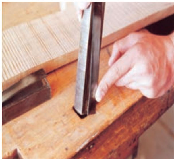
شکل ۲-۲۰- نمونه‌ی استقرار آهن نگهدارنده‌ی قطعه کار.
