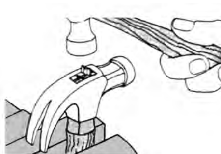
شکل ۷-۲۳- کوبیدن گوه به سر چکش.
