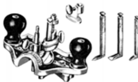
شکل ۶-۴۱- رنده‌ی کف طرح فرنگ همراه تیغه‌ها.
