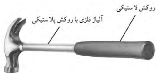
شکل ۷-۲۰- چکش فلزی همراه دسته فلزی.
