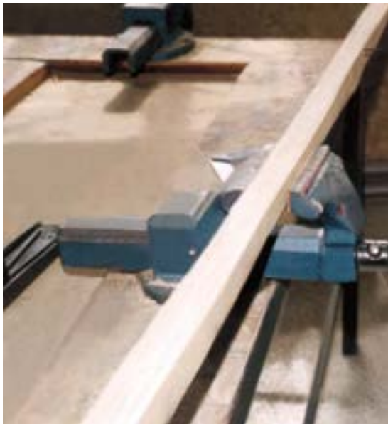
شکل ۸۳-۶. بستن قطعه کار به گیره میز کار.
