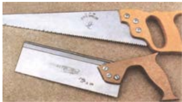
شکل ۵-۲- اره‌های دندانه‌رو به جلو.
