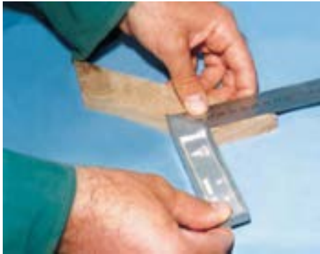
شکل ۵-۶۵- کنترل گونیاپی بودن قطعه کار.
