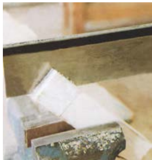
شکل ۵-۵۵- مالت افقی ارّه در پایان برش.
