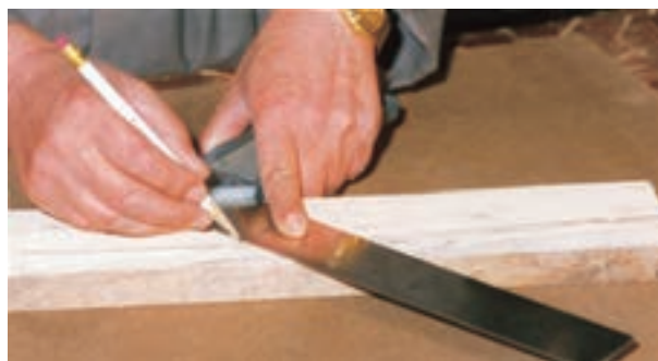
شکل ۶-۹۳- کار کردن با گونیای فارسی.
