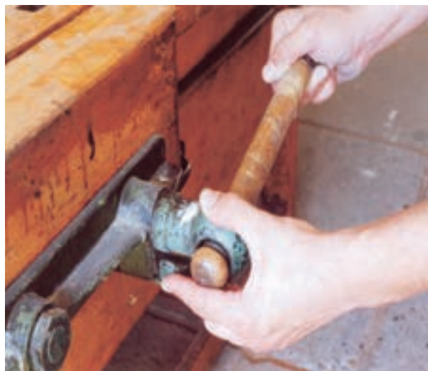
شکل ۲-۱۸- ضامن باز و بسته کردن آزاد گیره.
