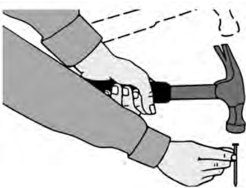
شکل ۳۱-۷. نمونه‌ی گرفتن میخ هنگام کوبیدن.
