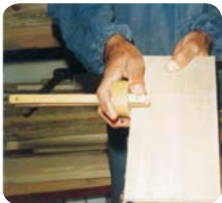
شکل ۶-۷۷. فم‌کشی روی چوب با فم‌کش تیره‌دار.
