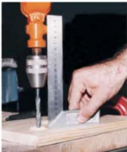
شکل ۱۲-۴۷- آزمایش گونمایی قرار گرفتن دریل.
