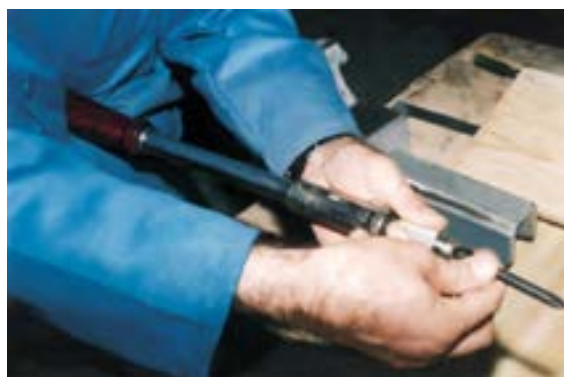
شکل ۸-۱۲- ممکم کردن نوک دریل فشاری.
