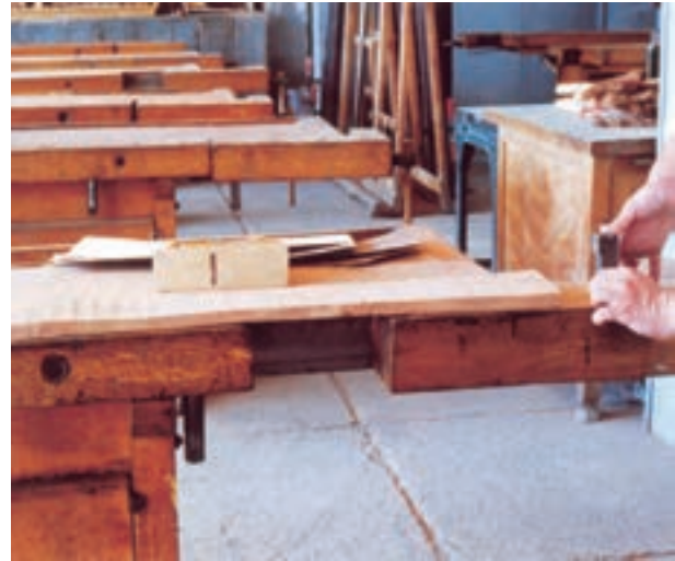
شکل ۲-۱۶- ثابت کردن قطعات روی میزکار، با استفاده از گیره و آهن نگهدارنده.
