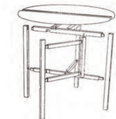
شکل (۲۴-۵) تصویر مجسم انفجاری میز با صفحه دو تکه کاربرد اتصالات گوشه‌ای کم و زبانه کوله‌دار و کم
