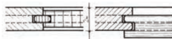
تنکه از صفحات مصنوعی با اتصال قلیف زبانه جدا و قاب چوبی
