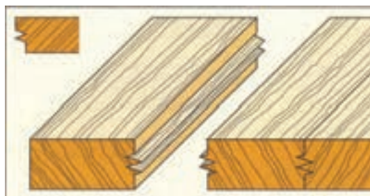
شکل (۳-۱۵۷) اتصال عرضی شانه‌ای ماشینی
