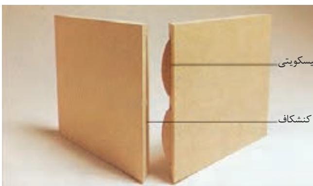
شکل (۳-۱۲۶) تصویر مجسم اتصال صفحه‌ای بیسکوییتی
