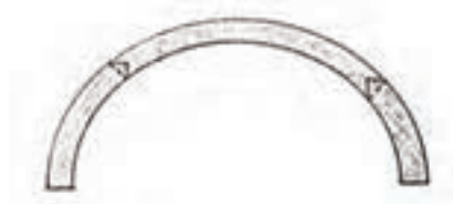
شکل (۳-۱۳۴) اتصال طولی قطعات قوس دار
