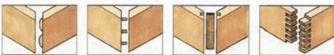
شکل (۵-۴۷) اتصال گوشه‌ای تصویر مجسم اتصالات انگشتی، قلیف زبانه جدا، دابل و بیسکوییتی
