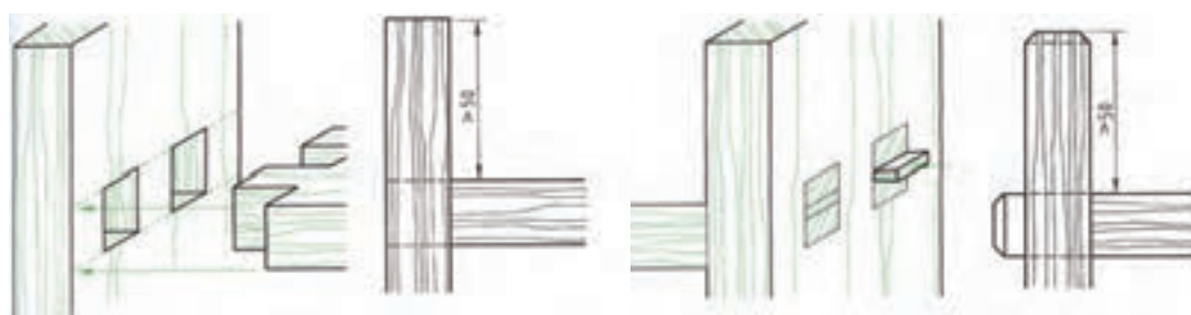
شکل ۵-۷۱: ترسیم اتصال میانی انگشتی در برش پیشانی
