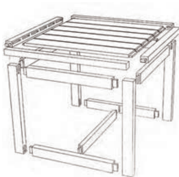
شکل (۵-۲۷) تصویر مجسم انفجاری میز کار با چوب ماسیو کاربرد اتصالات گوشه‌ای و میانی کم و زبانه کوله‌دار مخفی و کم و زبانه‌های متوالی
