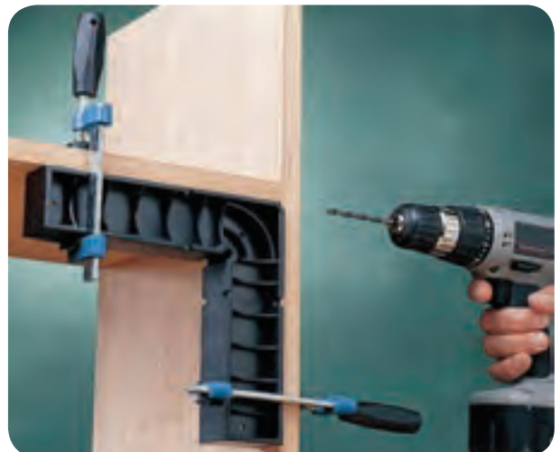
شکل ۱۷۰-۵- استفاده از شابلون برای جلوگیری از دوئیدگی
