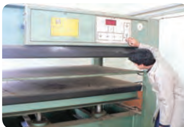
شکل ۸۵-۵: کنترل کار کردن صحیح پرس
