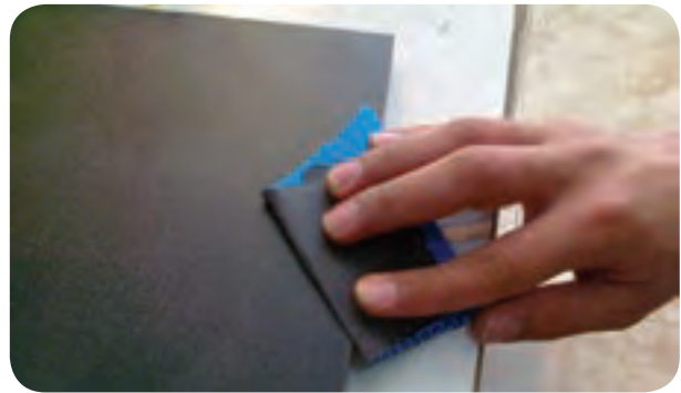
شکل ۴-۳۰ - پرداخت لبه لبه‌های نوار شده با سنباده
