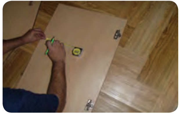
شکل ۱۵۰-۵- نصب لولای در کمد
