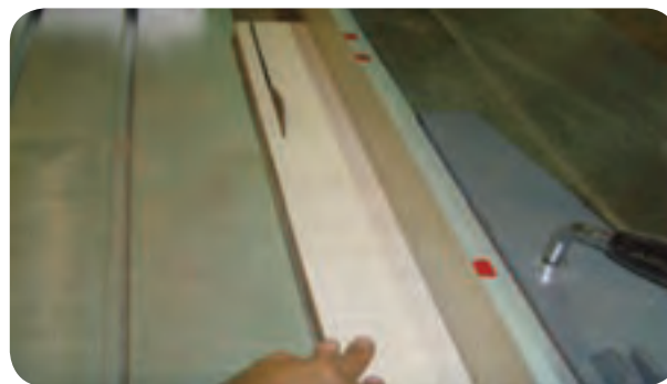
شکل ۱۰۴-۵- خطر پس‌زدن و پرتاب قطعه وجود دارد
