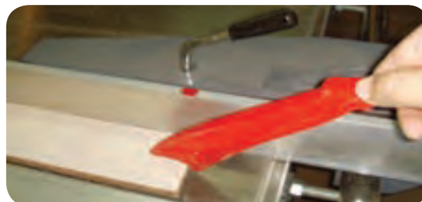
شکل ۱۰۵-۵- هدایت قطعه باریک به وسیله کمکی
