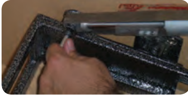
شکل ۵-۱۳۶ محکم کردن پایه‌های جک‌های تختخواب
