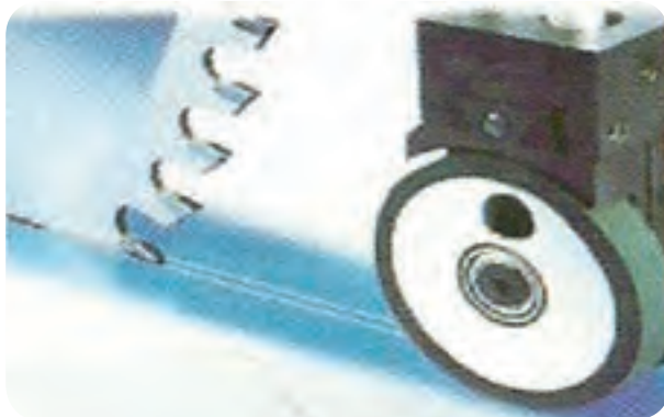
شکل ۳۸-۵- تیغه خطزن مخصوص
