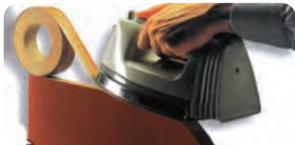
شکل ۴-۱۶ - نوار کردن لبه‌های قوس‌دار توسط اتو
