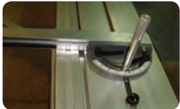
شکل ۵-۵۲- گونیای کوچک قابل تنظیم برای برشکاری
