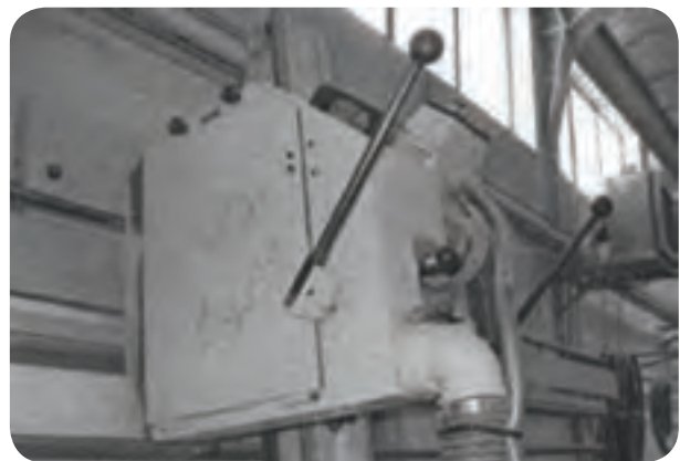
شکل ۳۹-۵- اهرم حرکت اره برای برش
