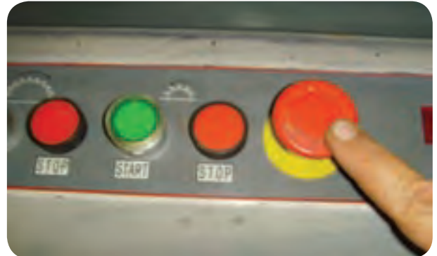
شکل ۵-۶۷- کلید خاموش کردن کلی ماشین دور کن
