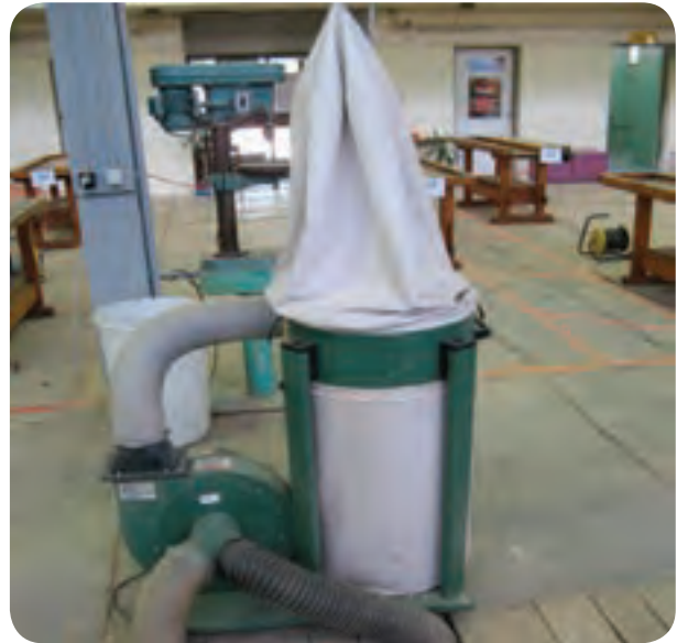
شکل ۲۴-۵- خروج ضایعات از طریق کانال پوشیده شده
