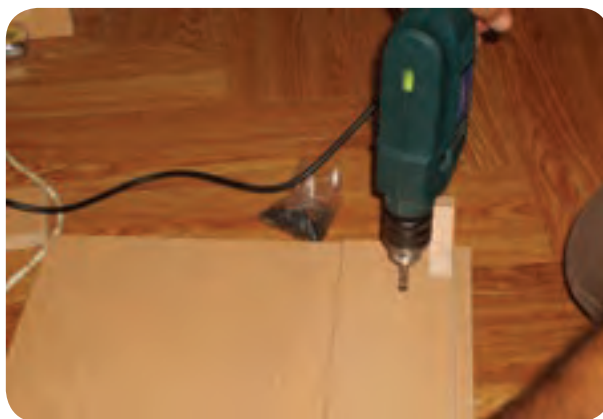
شکل ۱۴۶-۵- آماده‌سازی بدنه کمد لباس و نصب مانع
