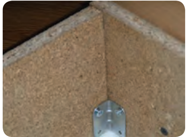
شکل ۱۵۵-۵- اتصال جلو و عقب جعبه به وسیله گونیای فلزی گوشه کار
