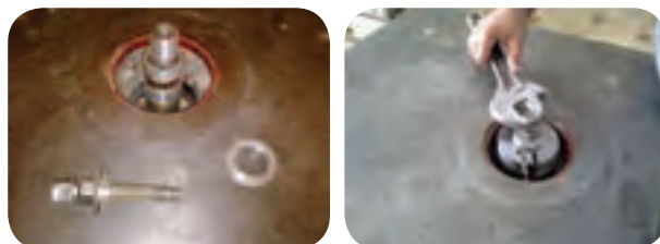
شکل ۲۸-۲- تنظیم کردن تویی در دستگاه فرز
