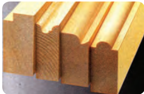
شکل ۴-۴-۴ چند نمونه لپه چسبان چوبی ابزار خورده
