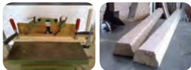
شکل ۲-۳۰- چوب ابزار خورده، ابزار زدن قطعه کار
