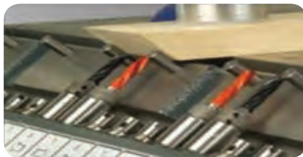
شکل ۳-۵ - سوراخ کاری قطعات زاویه دار
