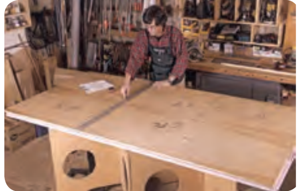
شکل ۴۷-۵- خط کشی صفحه ام دی اف برای برش
