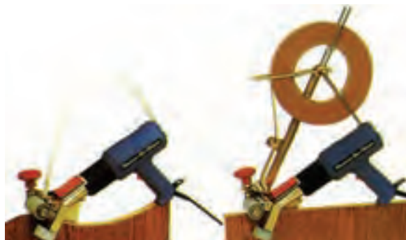
شکل ۴-۲۰ - نحوه نوار کردن کارهای مستقیم و قوسی
