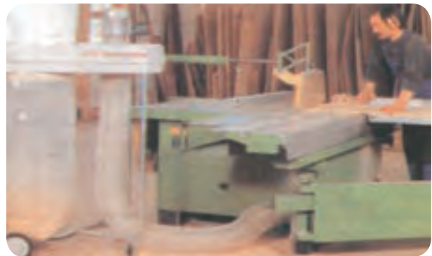
شکل ۲۵-۵- استفاده از حفاظ و تجهیزات ایمنی
