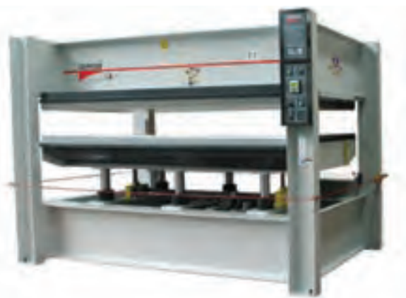
شکل ۵-۹۷- بندهای قطع اضطراری برق پرس در اطراف آن
