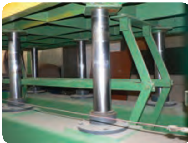
شکل ۸۹-۵- کنترل پیستون و سیلندرهای پرس
