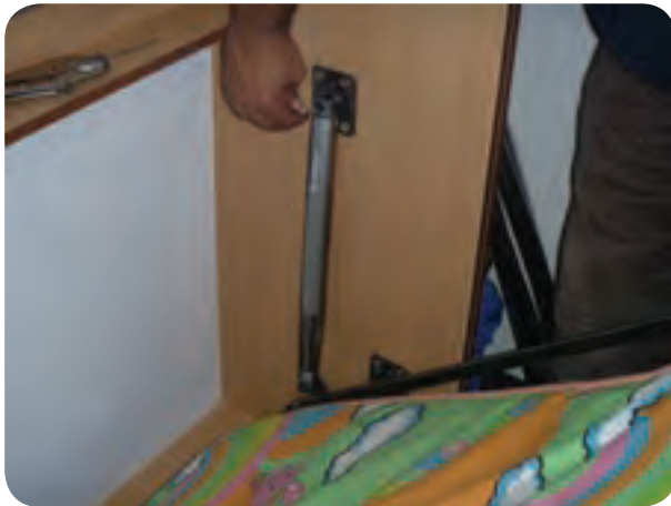
شکل ۵-۱۳۷ تنظیم فشار گاز سیلندر برای تعادل تختخواب
