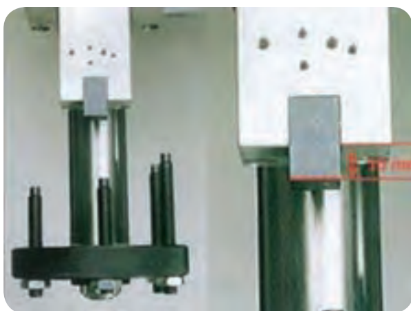
شکل ۳-۸ - سیستم تغییر عمق مته
