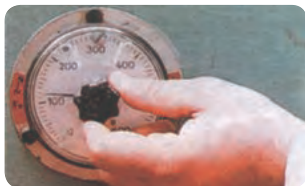
شکل ۷۹-۵ تنظیم فشارسنج پرس
