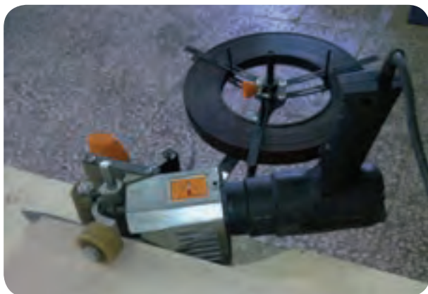
شکل ۴-۲۲ - نحوه نوار کردن قطعه کار به کمک سشوار نصب شده روی میز
