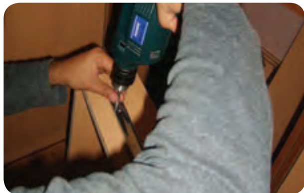
شکل ۱۷۶-۵- نصب ریل تکی به بدنه کشو
