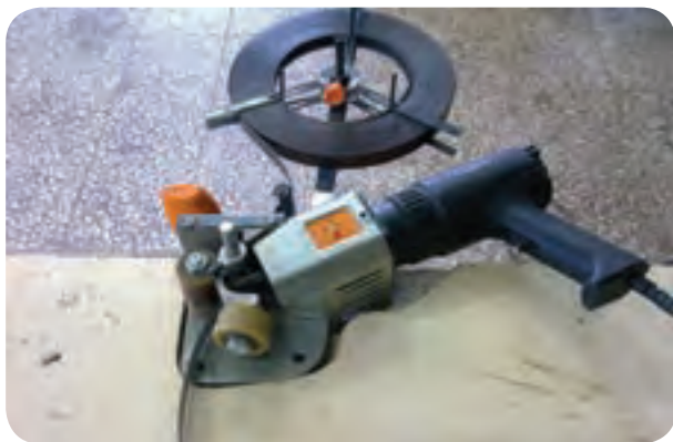
شکل ۴-۲۱ - نحوه استقرار سشوار روی میز
