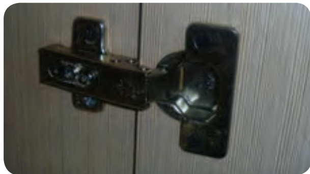
شکل ۵-۱۶۳- نصب لولای گازی فنردار به در کمد
