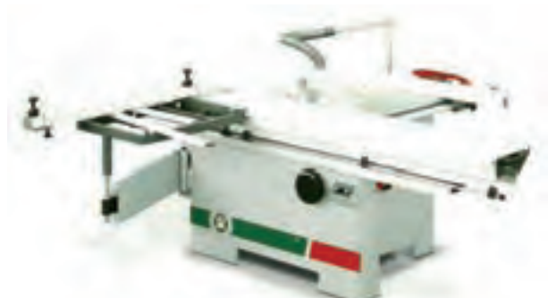
شکل ۳۰-۵- حفاظ طلقی قابل تنظیم ارّه دورکن
