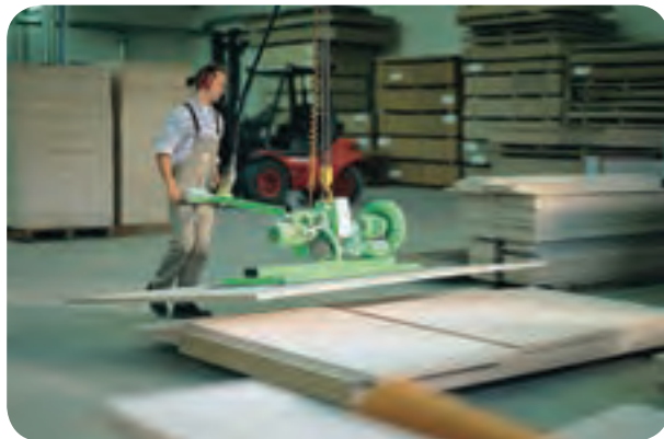
شکل ۴-۵- جرنقیل یا نقاله مکانیکی سقفی برای حمل صفحات بزرگ
