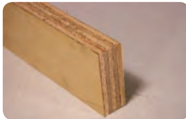
شکل ۴-۱-۴ تخته های چند لایه به صورت لایه لایه و به طور کلی، ناصاف اند.
