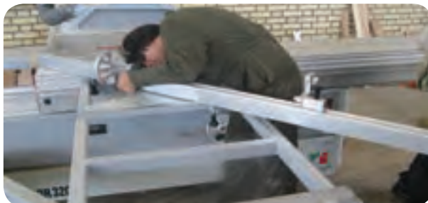
شکل ۵۰-۵- تنظیم دو کفشک کنترل اندازه گیری
