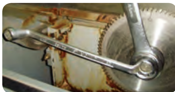
شکل ۵-۵۶- نحوه باز و بسته کردن تیغه اره
