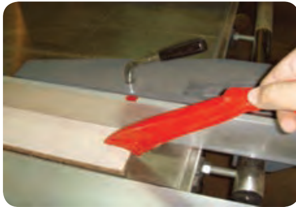
شکل ۵-۶۵- استفاده از وسیله کمکی هدایت قطعه باریک
