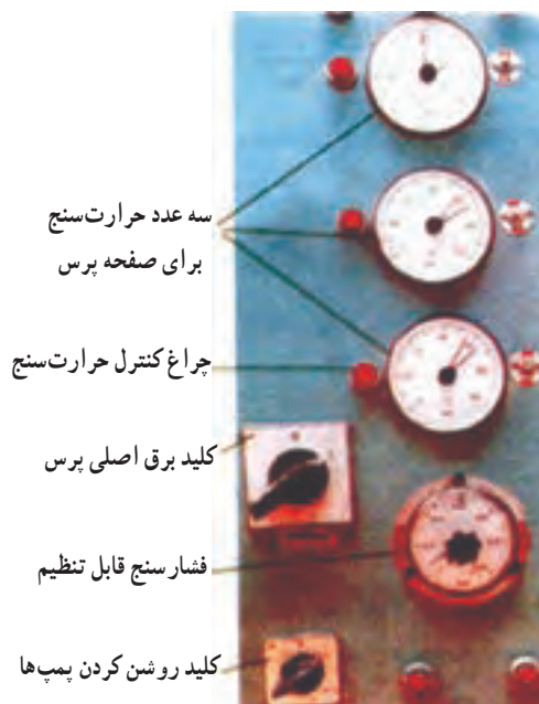
شکل ۸۷-۵- تنظیم اجزای پرس برای چسباندن روکش
