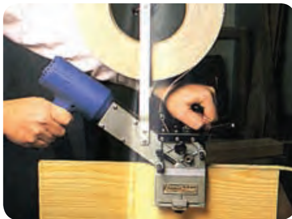
شکل ۴-۱۹ - نحوه نوار کردن با سشوار
