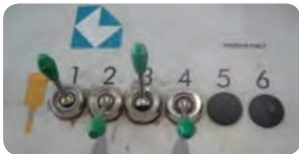
شکل ۳-۶ - کلیدهای بالا و پایین برنده جک‌ها
