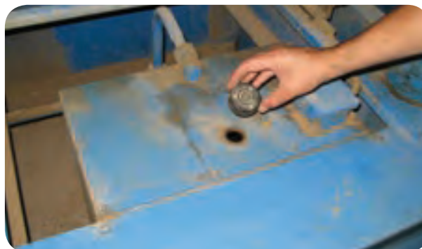
شکل ۸۸-۵- کنترل و تعویض روغن هیدرولیک مخزن
