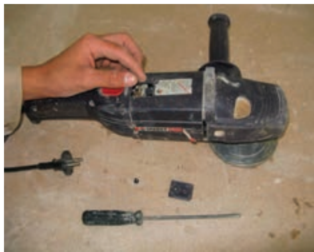
شکل ۲۴-۱۳- زغال دستگاه را هر چند وقت یک بار بازدید شود.
