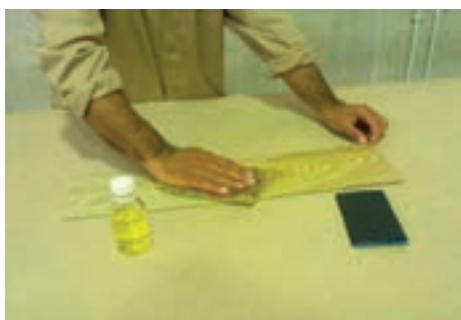
شکل ۱۲-۳۳- استفاده از پوست آب شماره ۴۰۰ برای پرگیری سطح کار.
