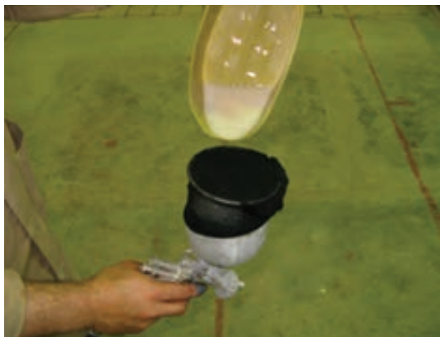
شکل ۳۹-۸- استفاده از جوراب نازک به عنوان صافی.
