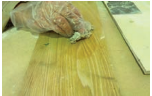
شکل ۴۰-۶- رنگ بتونه بایستی با قسمت نمودار هم‌رنگ باشد.
