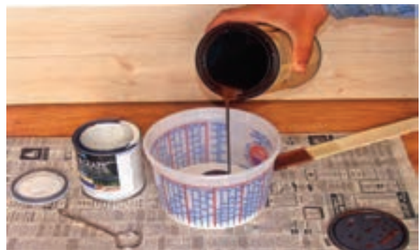
شکل ۱۹-۲ ترکیب رنگ (روغنی سیاه و رنگ روغنی سفید).
