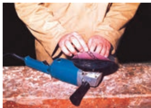
شکل ۵-۳۰- نمونه چسباندن سنباده به صفحه ی دستگاه.
