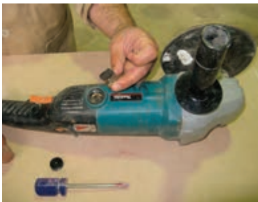
شکل ۳۵-۵- بازدید ذغال دستگاه سنباده دیسکی.
