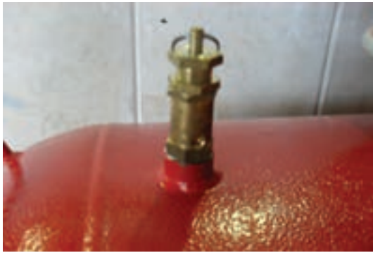
شکل ۱۰-۷- سوپاپ کمپرسور برای فروغ هوای اضافی.
