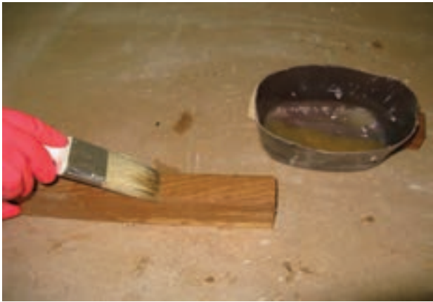
شکل ۳۹-۱۳- زدن سیلر به سطح کار با قلم‌مو.
