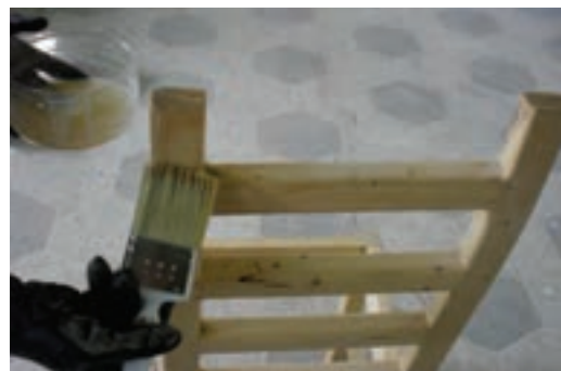
شکل ۱۳-۱۲- زدن کیلر به صندلی با قلم‌مو.
