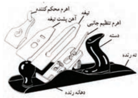
شکل ۳-۵۱- قسمت‌های مختلف رنده دو تیغ آهنی.
