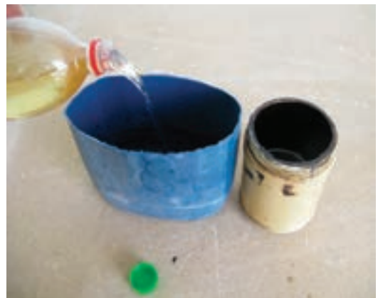
شکل ۶۳-۱۳- مل کردن آستری شاپان با نفت.
