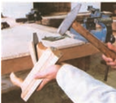
شکل ۳-۵۵- پر تیغ و کم تیغ کردن رنده چوبی.
