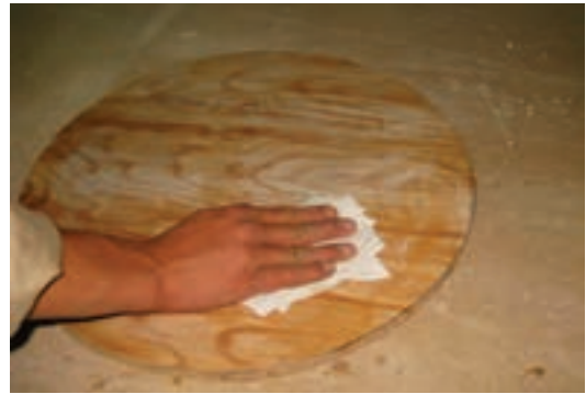
شکل ۶۲-۱۳- گرفتن گرد و غبار از سطح کار.
