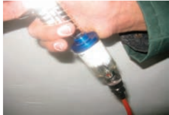
شکل ۲۶-۸- محل اتصال شیلنگ باد به پیستوله.
