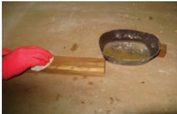
شکل ۳۸-۱۳- سیلرکاری با کهنه رنگ‌کاری.
