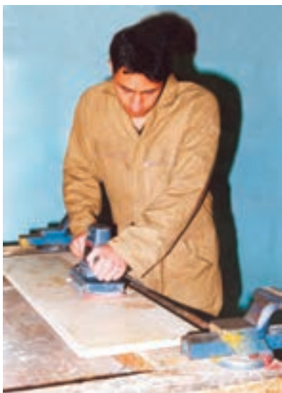
شکل ۵-۴۳- سنباده‌کاری در جهت الیاف.
