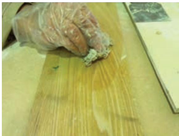
شکل ۴۶-۱۲- زدن آستری بر روی یک تخته نراد با کهنه رنگ‌کاری.
