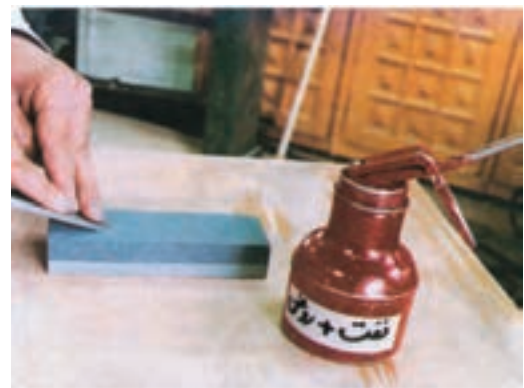
شکل ۳۱-۳- روغن زدن یا نفت زدن روی سنگ.
