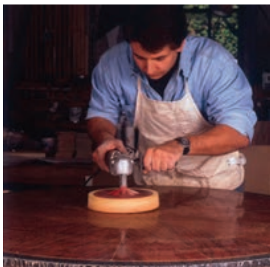
شکل ۱۲-۲۴- پولیش‌کاری سطح پلی استر فورده.
