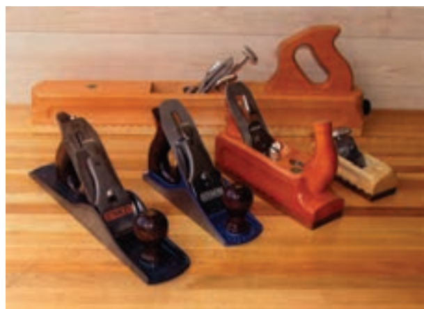
شکل ۲۲-۳- انواع رنده‌های چوبی و آهنی.
