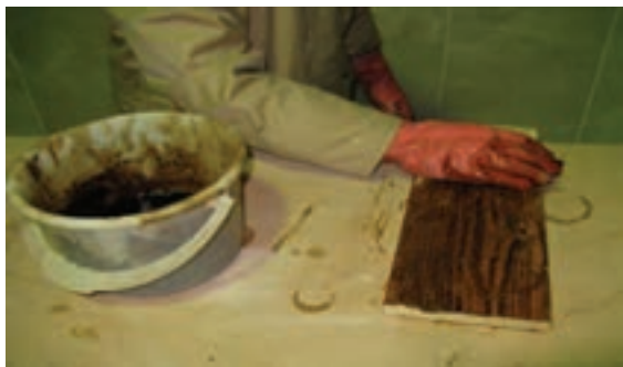
شکل ۴۳-۶- زدن آستری هم‌رنگی برای تغییر رنگ اولیه چوب.
