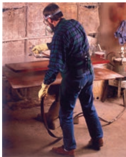
شکل ۱۲-۲۲- پاشیدن پلی استر ایستاده به سطح کار.
