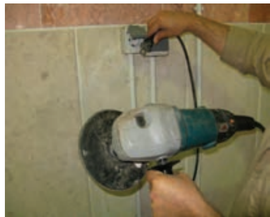
شکل ۲۰-۱۳- کشیدن دوشافه ماشین پوست گرد از پریز.
