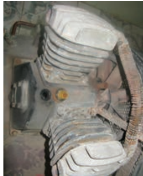
شکل ۸-۷- مخزن روغن یک کمپرسور دو سیلندر.
