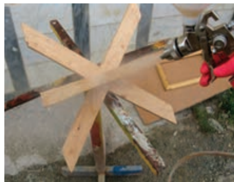
شکل ۱۴-۱۲- زدن کیلر به کار با پیستوله.
