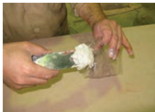
شکل ۳۱۳-۶- قراردادن بتونه سربشی داخل پلاستیک.
