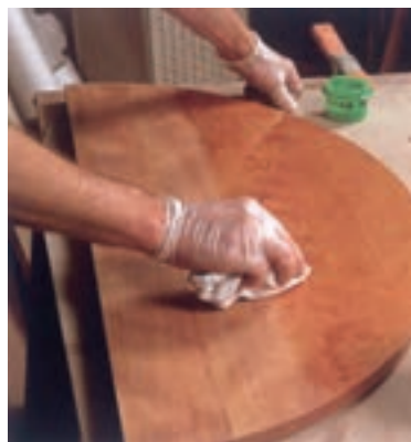
شکل ۳-۳۸- استفاده از پارچه نم‌دار در لیسسه‌کاری.
