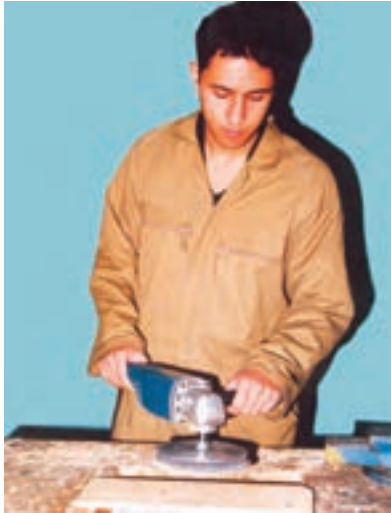
شکل ۵-۳۱- فشار یکنواخت به سطح کار.
