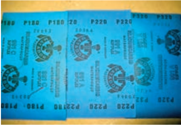
شکل ۱۱-۱۲- چند نمونه سنباده پوست آب با شماره‌های مختلف.
