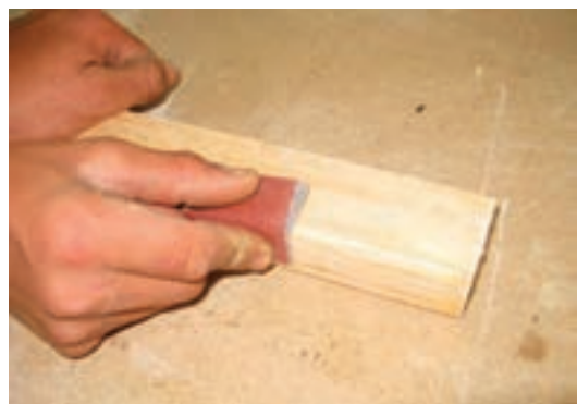
شکل ۱۷-۱۳- سنباده‌کاری روی قسمت افزارخورده لبه چوب نراد.
