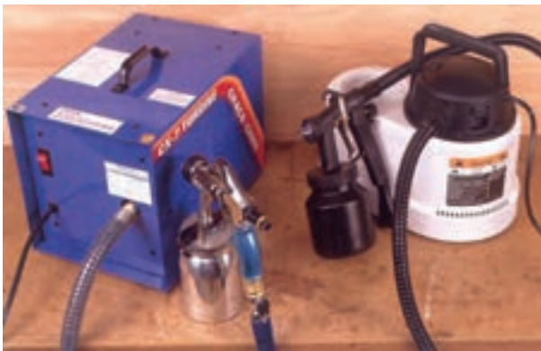
شکل ۷-۴- دو نوع کمپرسور قابل حمل و سبک.
