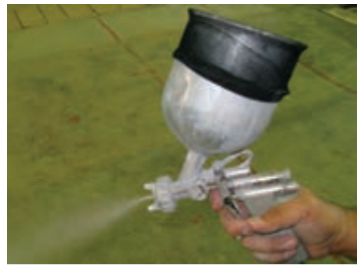
شکل ۹-۱- گرد و غبار ناشی از کار با پیستوله.
