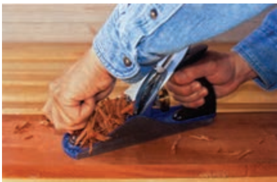
شکل ۷-۱۳- پرداخت کاری با رنده دستی.
