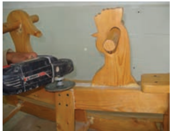
شکل ۱۹-۱۳- سنباده کاری با ماشین پوست دیسکی.
