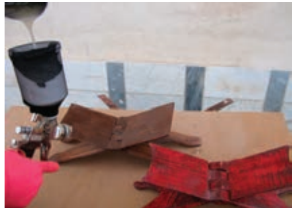
شکل ۵۸-۱۲- زدن سیلر به سطح کار با کهنه رنگ‌کاری.
