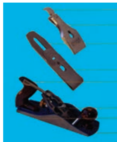
شکل ۲۳-۳- رنده آهنی و تیغه‌های آن.
