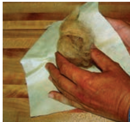
شکل ۸-۶- استفاده از پارچه در لاک و الکل کاری.
