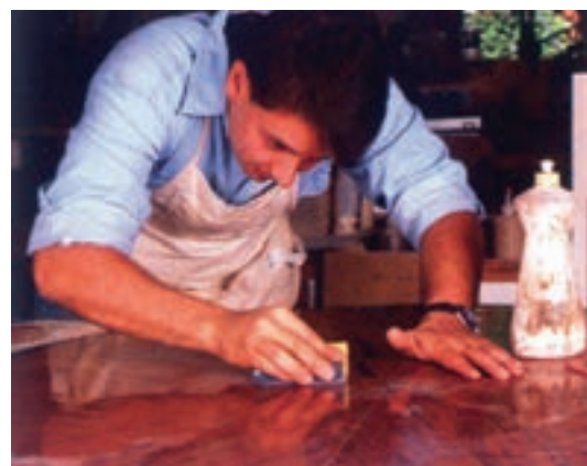
شکل ۱۲-۲۳- سنباده‌کاری سطح پلی استر فورده.
