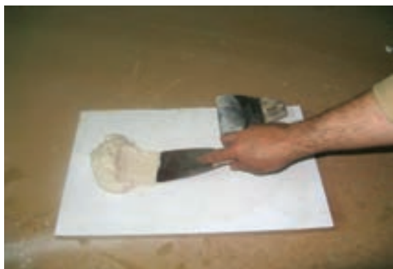
شکل ۱۸-۶- تخته بتونه برای سافت بتونه.
