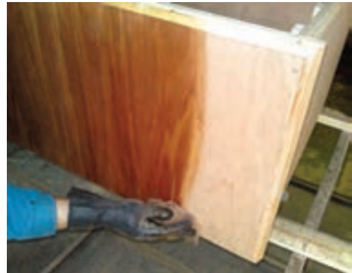
شکل ۳۱-۸- زدن آستری هم‌رنگی از پای به بالا.
