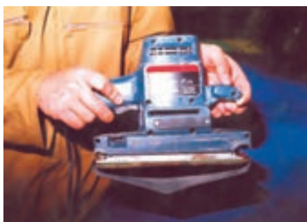
شکل ۵-۴۴- گیره نگهدارنده بایستی سالم باشد، در غیر اینصورت سنباده شل می‌شود.
