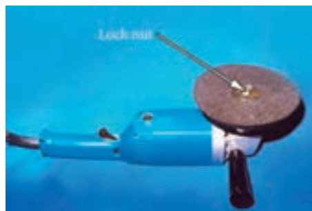
شکل ۳۴-۵- با بازکردن مهره (روی صفحه دیسک) صفحه ماشین باز می‌شود.
