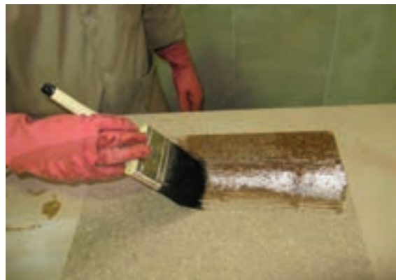
شکل ۱۰-۱۰- روغن اندود کردن سطح نئوپان با روغن الیف با استفاده از قلم‌موی پهن.
