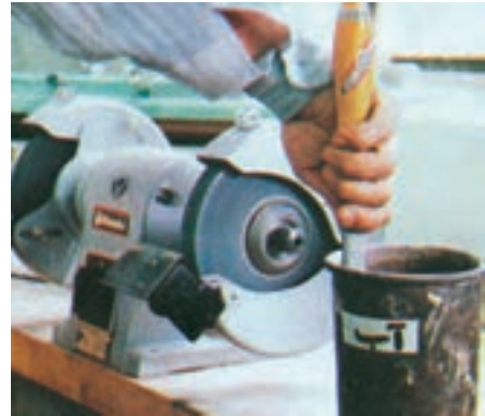
شکل ۳۰-۳- لبه‌ی تیغه را مرتب با آب فنگ کنید تا نسوزد.
