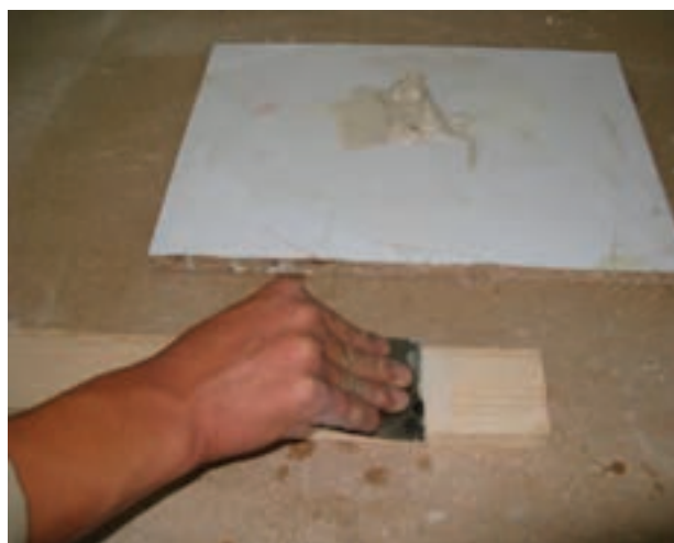
شکل ۵۹-۱۳- زدن بتونه هم‌رنگی به چوب نراد.
