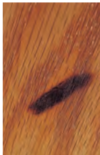
شکل ۱۱-۱ اثر اکسیداسیون روی سطح.
