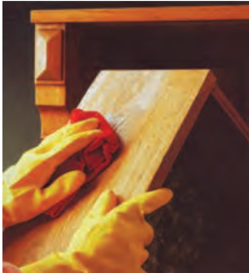
شکل ۲۲-۱۱- پاک کردن سطح کار پس از آستری.
