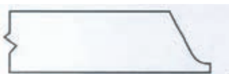
حالت لبه J شکل یکطرفه
