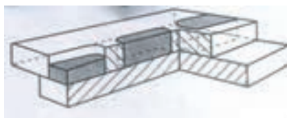
جوش دکمه‌ای (لوبیایی شکل)
