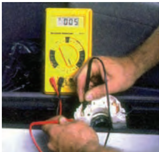
شکل ۹۷-۱- آزمایش سوئیچ روشنایی
