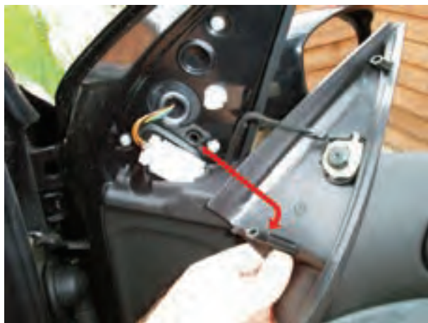
شکل ۱۶۵-۲ خارهای روی قاب و محل نصب آن
