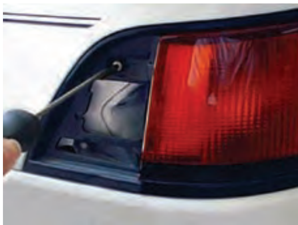
شکل ۱-۵۶- باز کردن پیچ‌های قاب چراغ
