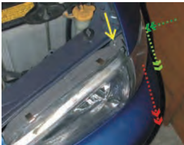
شکل ۱-۳۸- نحوه‌ی جداکردن چراغ جانبی روشنایی
