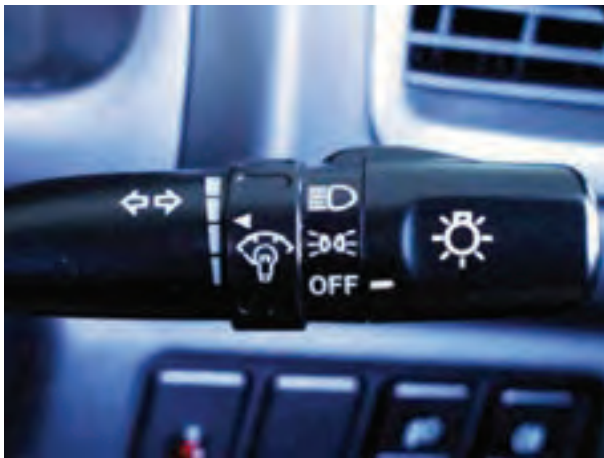
شکل ۱-۷۲- سوئیچ چراغ‌های روشنایی (طرح دسته‌ی راهنما)
