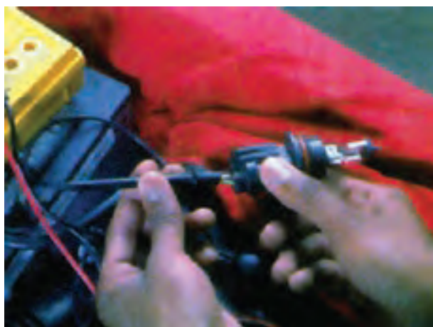
شکل ۱۴۲-۱- آزمایش لامپ چراغ‌های بزرگ جلو
