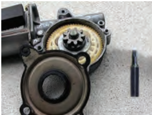
شکل ۱۲۴-۲- اجزای داخل جعبه دنده‌ی تعدیل دور
