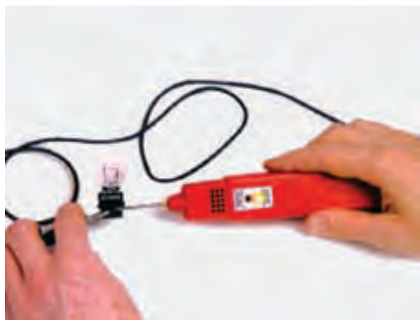
شکل ۲۱۹-۱- آزمایش لامپ چراغ صندوق عقب خودرو
