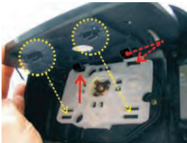
شکل ۱۶۲-۲- زائده‌ها و خارهای اتصال آینه به صفحه‌ی زیرین
