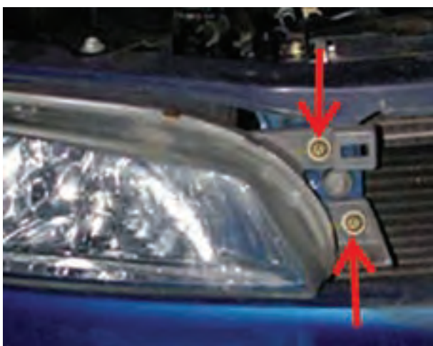
شکل ۱-۴۰- پیچ‌های نگه‌دارنده‌ی چراغ‌های بزرگ جلو
