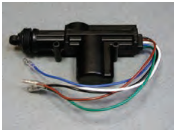
شکل ۲۴-۲- عملگر الکتریکی پنج سیمی
