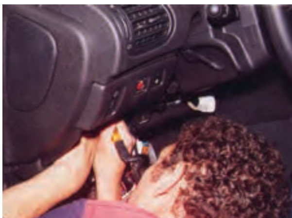
شکل ۲-۹۵ آزمایش برقراری جریان الکتریکی مدار
