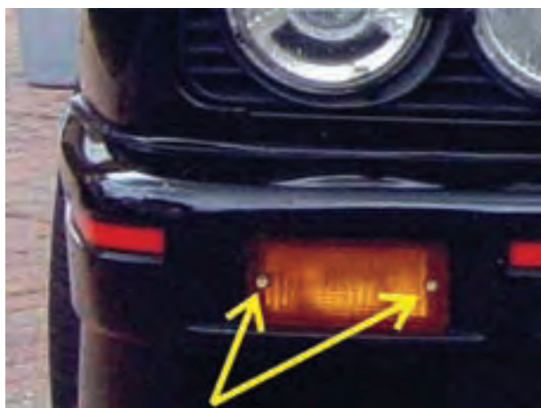
شکل ۱-۵۰ پیچ‌های اتصال تلق چراغ راهنما
