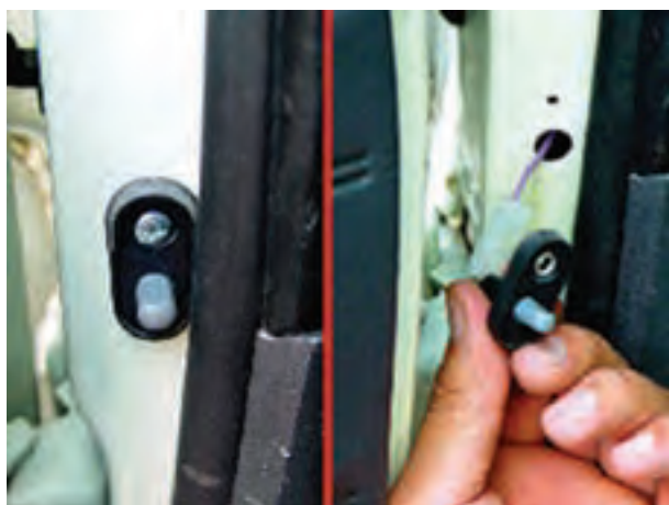
شکل ۱۹۲-۱- باز کردن سوئیچ لای در
