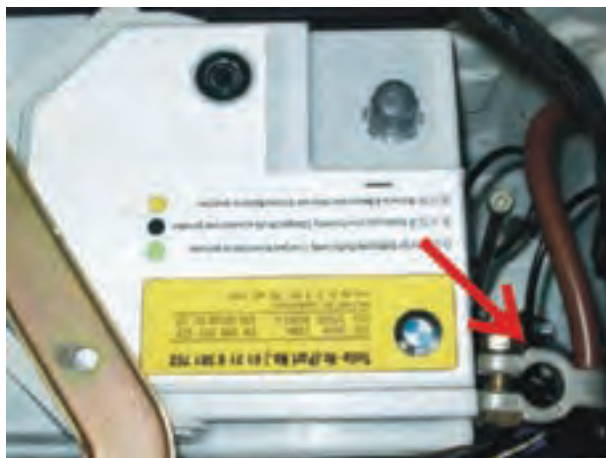
شکل ۲-۱۰۹- باز کردن اتصال منفی باتری
