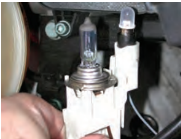
شکل ۱-۴۹ - پایه‌ی مشترک لامپ‌های چراغ روشنایی و پارک
