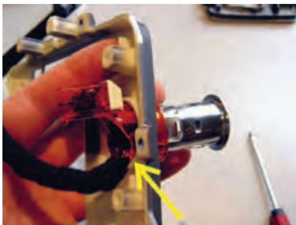
شکل ۲۳۲-۱- خارج کردن فنکدک
