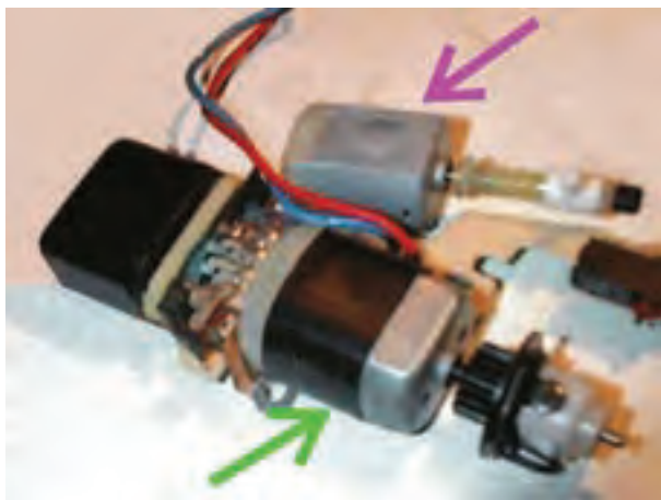
شکل ۱۶۰-۲- الکتروموتورهای مورد استفاده در یک نوع آینه‌ی جانبی
