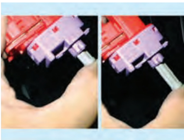
شکل ۱-۱۹۹- عملکرد پلانجر سوئیچ جعبه‌ی داشبورد
