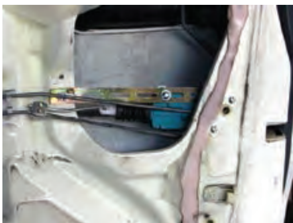
شکل ۳۷-۲- نحوه‌ی اتصال عملگر الکتریکی
