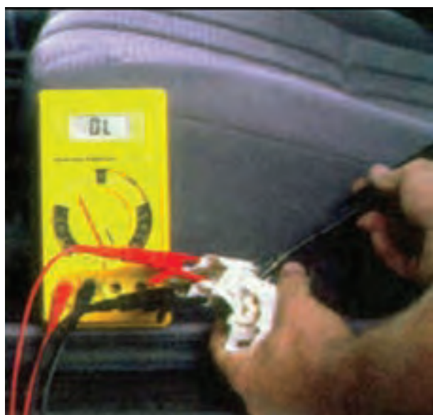
شکل ۹۸-۱- آزمایش حالت استپ موقت دسته ی راهنما
