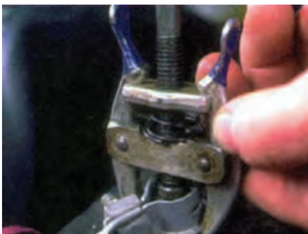
شکل ۱-۸۹- باز کردن بست اتصال بدنه‌ی باتری
