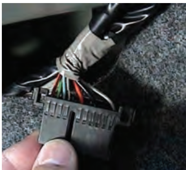
شکل ۱-۱۳۵- سوکت اتصال سیم‌کشی مدار به دستگاه الکتریکی
