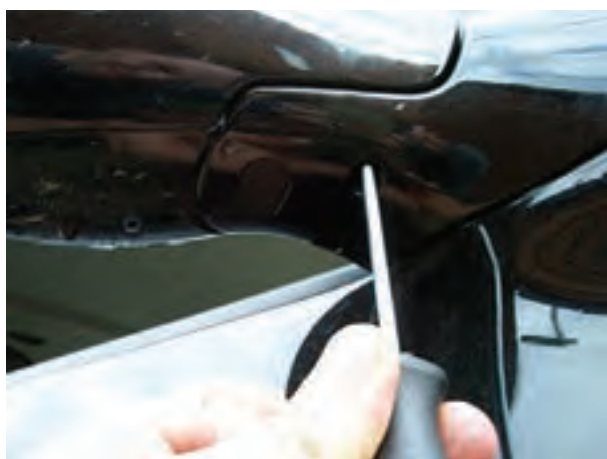
شکل ۱۷۶-۲- بازکردن پیچ روی پایه ی بیرونی آینه
