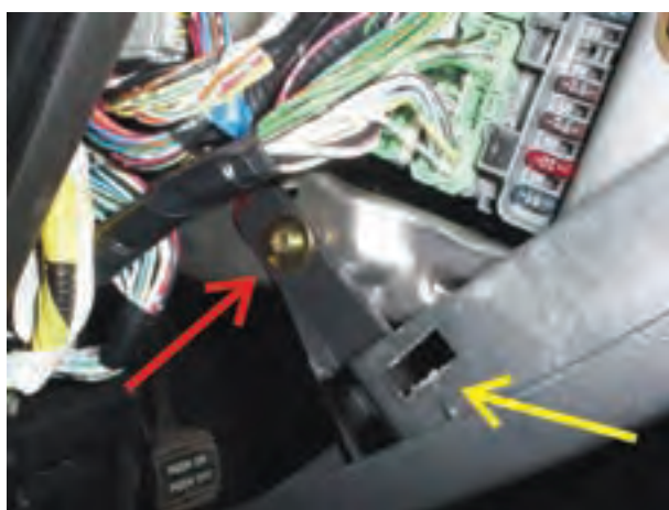
شکل ۱-۸۳- محل قرار گرفتن خار و پیچ اتصال قاب زیرین
