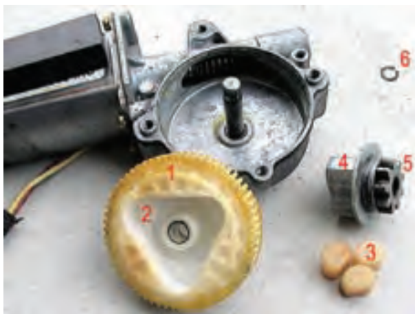
شکل ۱۲۵-۲- اجزای داخل پوسته‌ی گیربکس تعدیل دور
