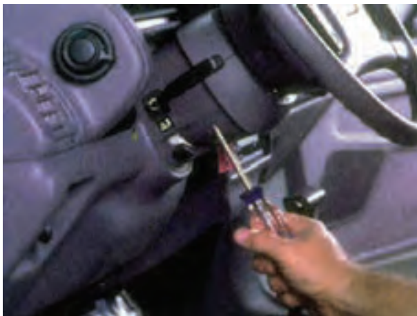
شکل ۱-۹۰- باز کردن پیچ‌های قاب سوئیچ روشنایی
