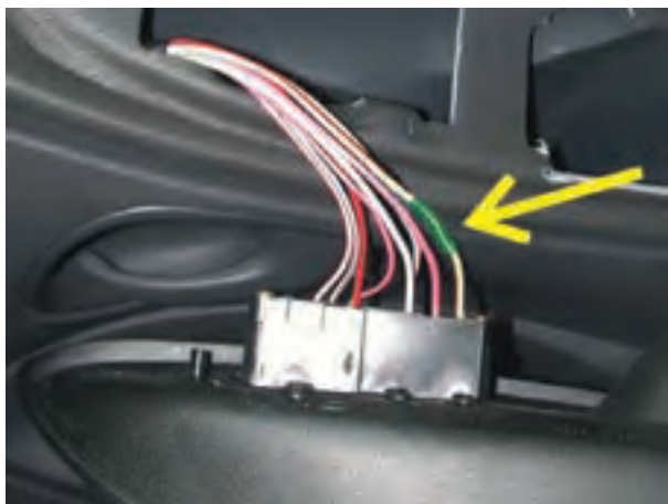
شکل ۱۵۳-۲- عایق‌کاری محل اتصال سیم قطع شده
