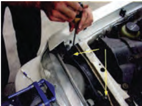
شکل ۱۶۷-۱- تنظیم های چراغ بزرگ جلو
