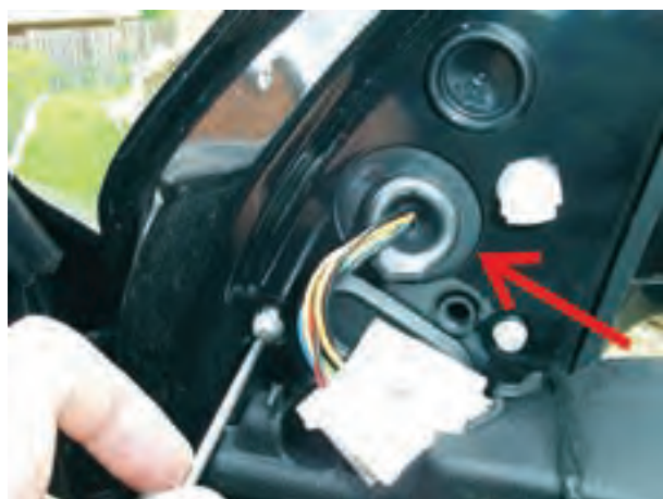
شکل ۱۷۸-۲ – باز کردن پیچ نگه‌دارنده‌ی پایه‌ی اصلی آینه
