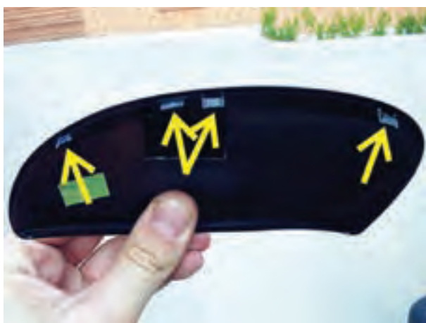
شکل ۱۷۳-۲- صفحه‌ی پوشش محل پیچ‌ها و خارهای روی آن
