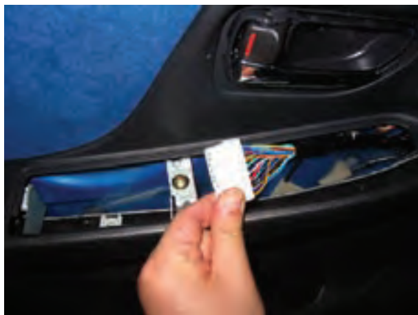
شکل ۱۸۵-۲- سوکت اتصال دسته سیم به سوئیچ‌ها
