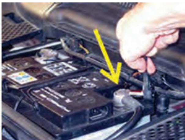
شکل ۱۴۱-۲- باز کردن کابل اتصال بدنه‌ی باتری
