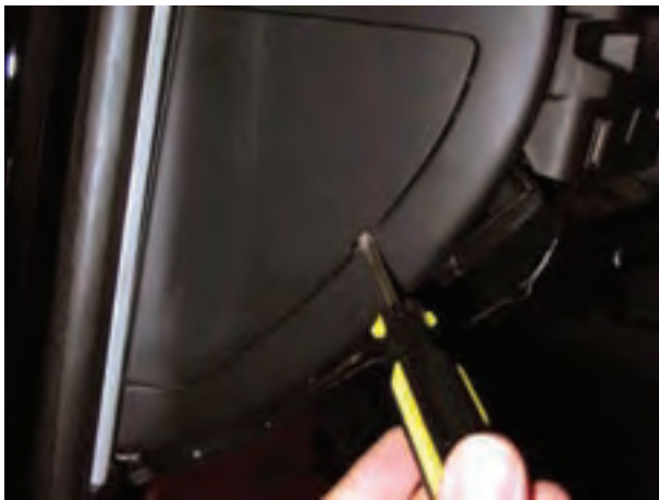
شکل ۱۱۸-۱- آزاد کردن خار پوشش محافظه‌ی جعبه‌ی فیوز
