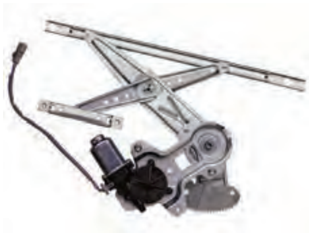
شکل ۲-۹۹- مکانیزم شیشه بالابر یک نوع خودرو
