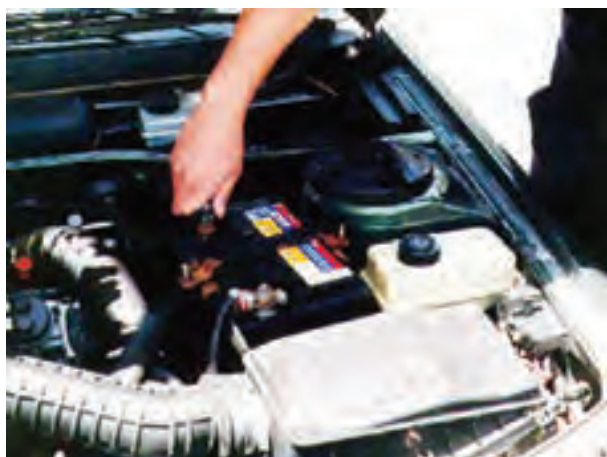
شکل ۱۶۴-۲ بازکردن کابل اتصال بدنه‌ی باتری
