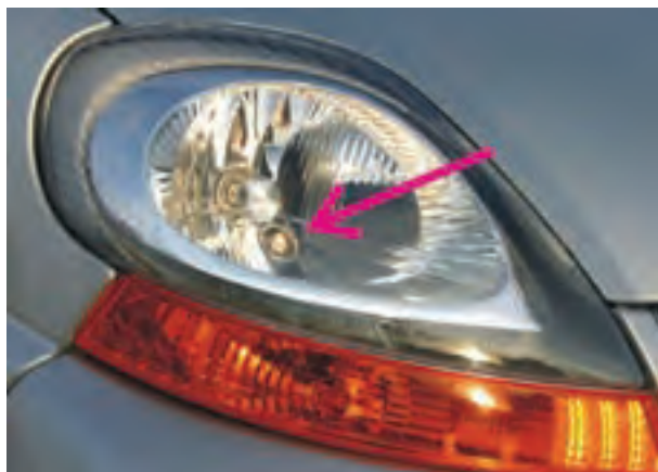
شکل ۲۲-۱- چراغ جانبی (پارک) تعبیه شده در داخل کاسه‌ی چراغ جلو در یک نوع خودرو
