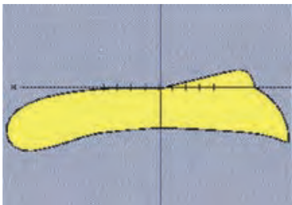
شکل ۱۵۴-۱- الگوی مناسب پخش نور دستگاه تنظیم نور چراغ‌ها
