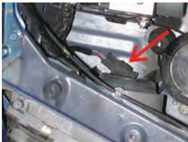
شکل ۳۷-۱- کاتوجویی اتصال سیم‌کشی چراغ‌های روشنایی
