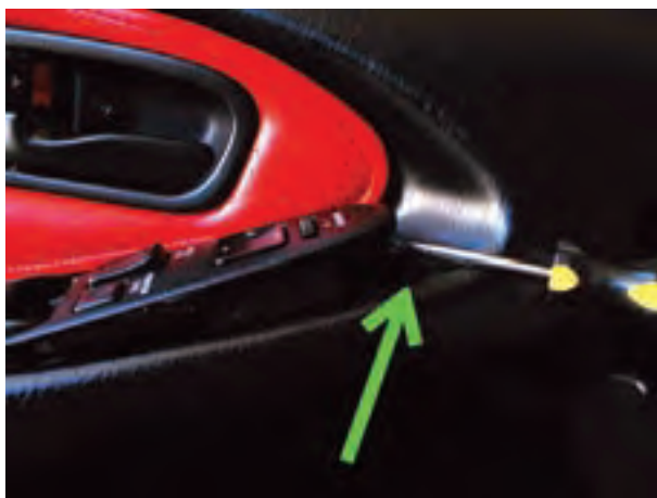
شکل ۱۴۲-۲- خارج کردن قاب سوئیچ شیشه بالابر
