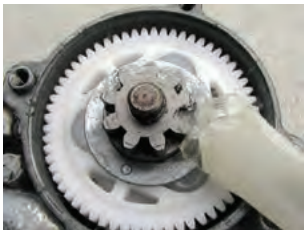
شکل ۱۳۰-۲- روغن کاری چرخ دنده ها
