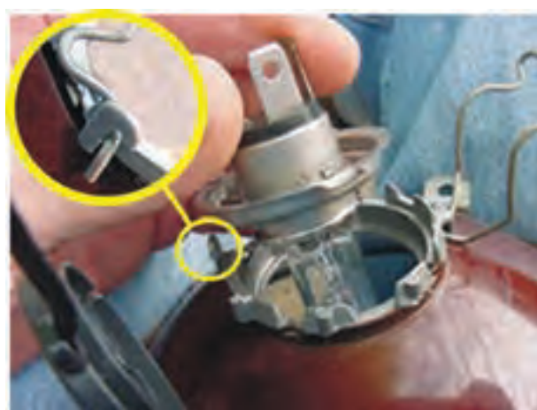
شکل ۱-۴۳- نحوه‌ی ثابت شدن لامپ درون کاسه‌ی چراغ
