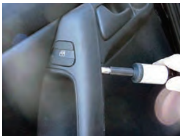
شکل ۲-۱۱۰- جدا کردن قاب سوئیچ شیشه بالابر
