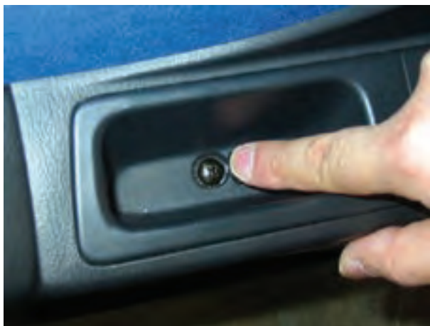
شکل ۱۸۲-۲ پیچ اتصال قاب سوئیچ به بدنه
