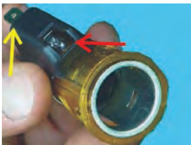
شکل ۱-۲۲۴- لامپ فندک و ترمینال الکتریکی آن
