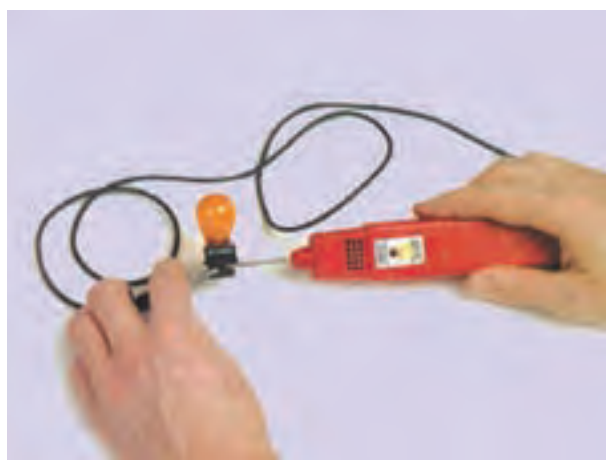
شکل ۱۸۲-۱- آزمایش لامپ چراغ راهنما
