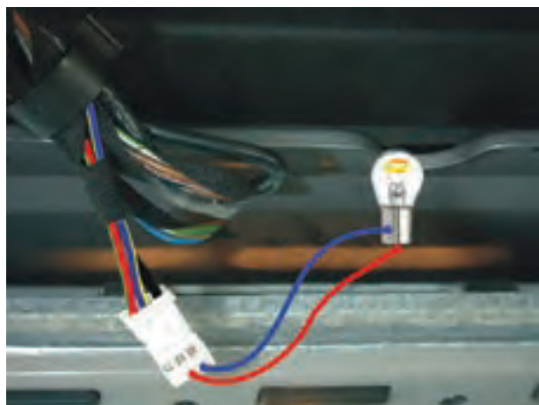
شکل ۱-۲۳۶- آزمایش سیم کشی مدار فندک
