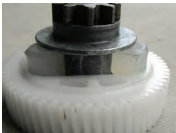
شکل ۱۲۸-۲ سوار کردن چرخ دنده‌ی فلزی
