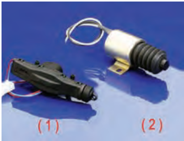
۱- موتوردار ۲- سولفونیدی شکل ۹-۲- دو نوع عملگر سیستم قفل مرکزی
