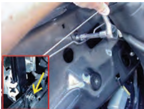
شکل ۱۲۰-۲- باز کردن پیچ ریل شیشه بالابر
