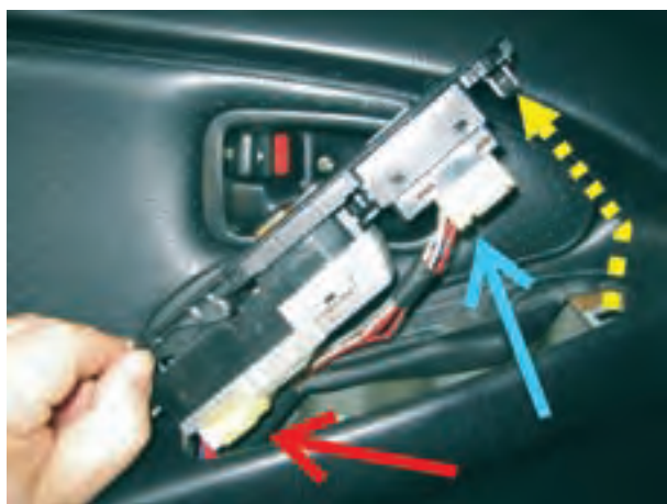
شکل ۱۸۶-۲- اتصال سیم‌کشی مدار الکتریکی به سوئیچ‌های روی پانل در سمت راننده در یک نوع خودرو
