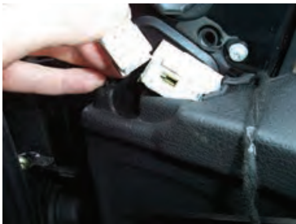
شکل ۱۶۶-۲- جدا کردن سوکت سیم کشی آینه
