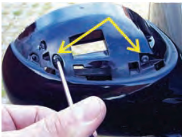
شکل ۱۷۴-۲- باز کردن پیچ‌های قاب بیرونی آینه
