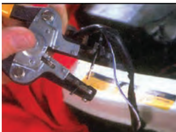
شکل ۱۴۷-۱- استفاده از ابزار سیم لخت کن
