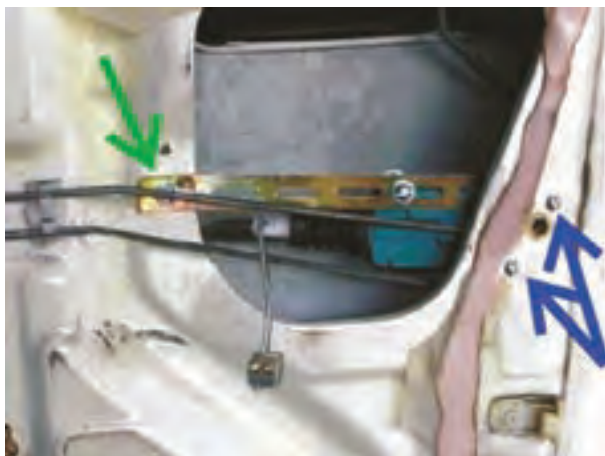
شکل ۳۹-۲- باز کردن پیچ‌های اتصال عملگر الکتریکی
