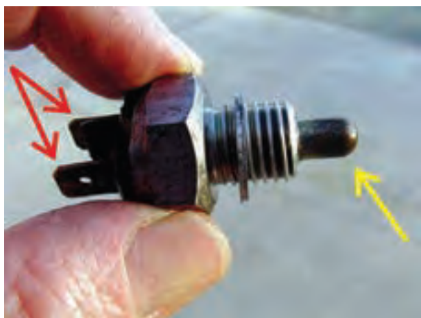
شکل ۱۰۴- پلانجر و ترمینال‌های سوئیچ دنده عقب
