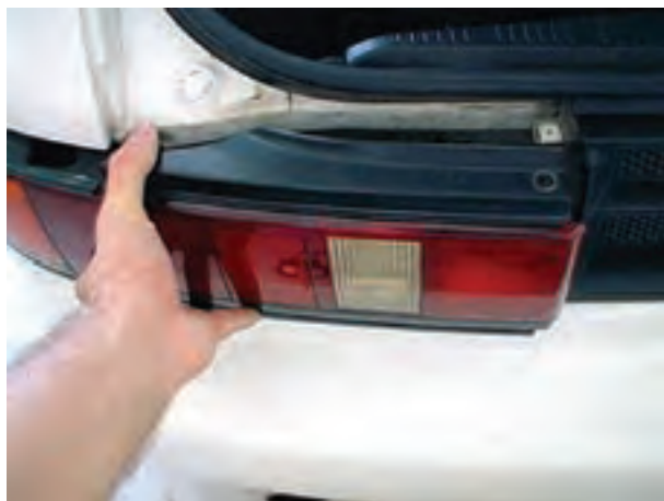
شکل ۱-۵۸- جدا کردن چراغ عقب از بدنه‌ی خودرو
