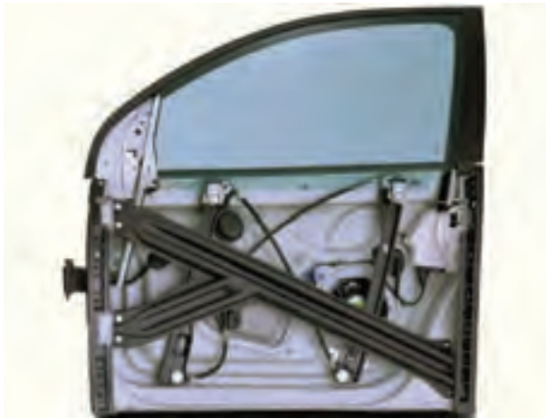
شکل ۲-۹۶- شیشه بالابر الکتریکی
