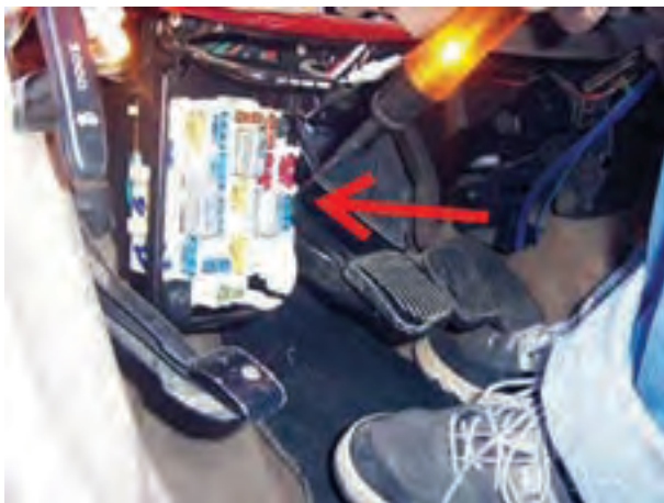
شکل ۱۲۰-۱- آزمایش جعبه‌ی فیوز با چراغ آزمایش
