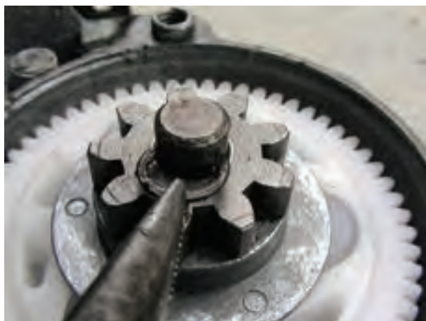
شکل ۱۲۹-۲ جانداختن خار فنری
