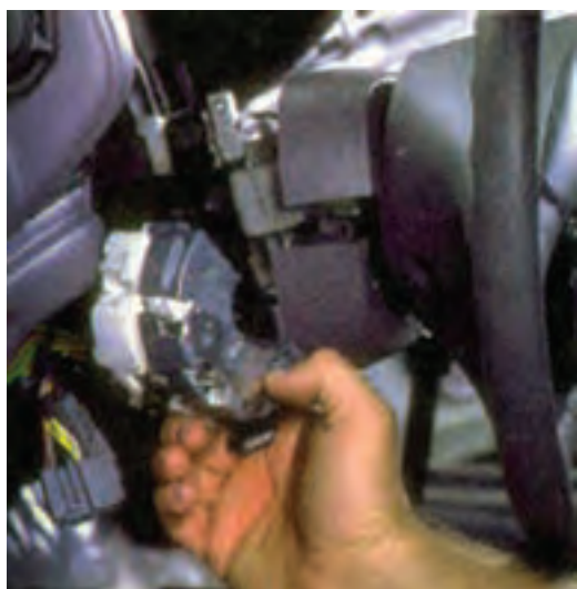
شکل ۹۶-۱- خارج کردن سوئیچ روشنایی از محل خود
