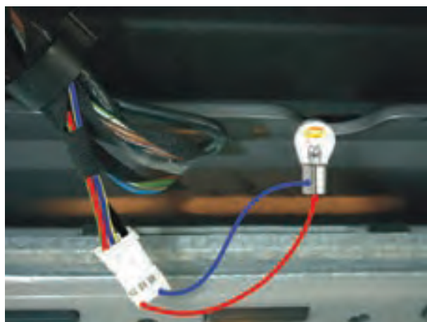
شکل ۱-۲۳۷- آزمایش سیم کشی مدار چراغ فندک
