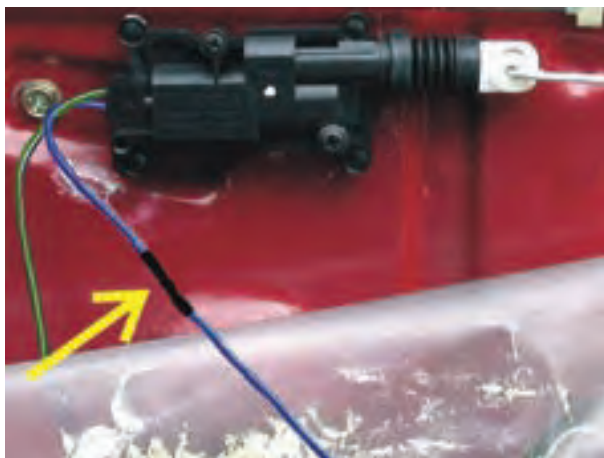
شکل ۲-۴۹- عایق کاری محل اتصال سیم‌ها به یکدیگر
