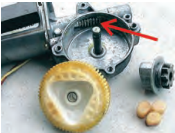
شکل ۲-۹۸- اجزای داخلی جعبه دنده
