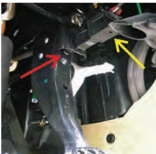
شکل ۱-۷۷- محل نصب سوئیچ مکانیکی ترمز
