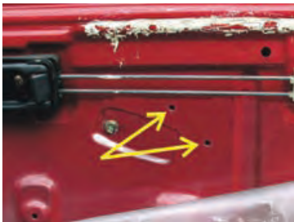
شکل ۲-۲۷ سوراخ کاری بدنه‌ی داخلی در خودرو
