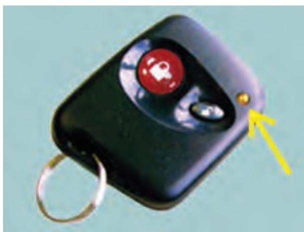
شکل ۲-۷- دیود نوری روی قاب ریموت کنترل
