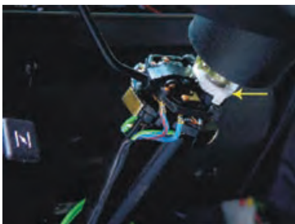
شکل ۸۰-۱- فیبری برگردان سوئیچ راهنما
