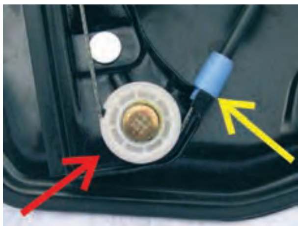
شکل ۱۰۴-۲- قرقره روی ریل شیشه بالابر
