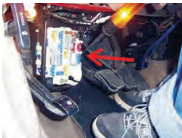
شکل ۱۸۹-۲- آزمایش پایه‌های فیوز
