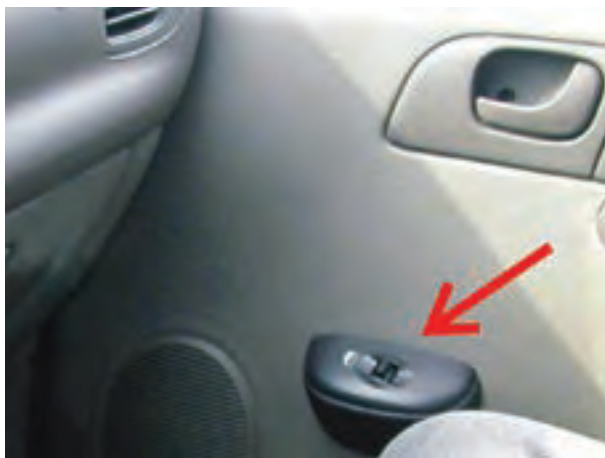
شکل ۱۳۳-۲- سوئیچ شیشه بالابر در جلو سمت سرنشین
