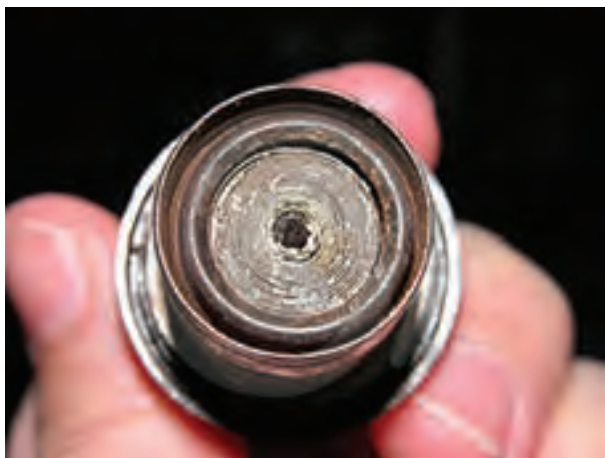
شکل ۱-۲۲۵- المنت حرارتی داخل سوئیچ فشاری
