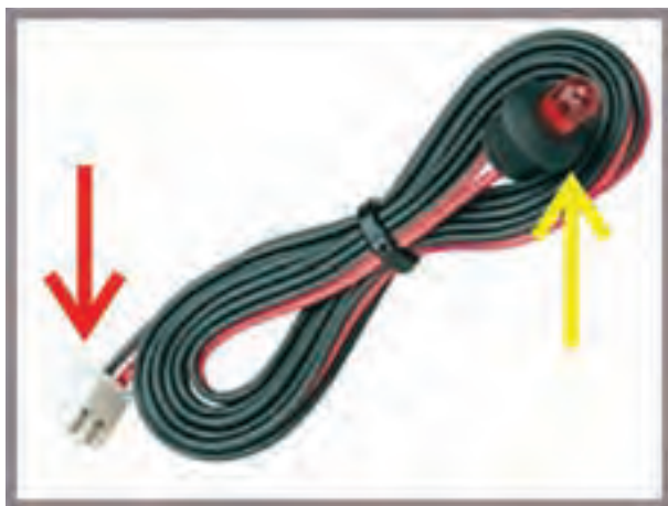
ب- دیود نوری (LED) مدار دزدگیر شکل ۲-۹۰
