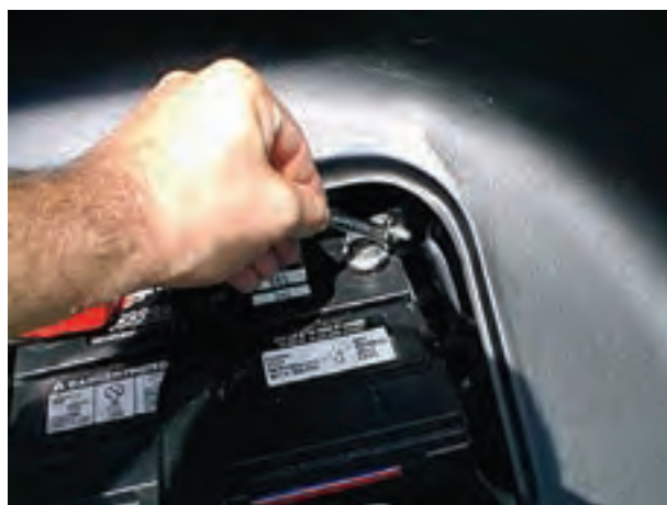
شکل ۱-۵۲ باز کردن بست ترمینال منفی باتری
