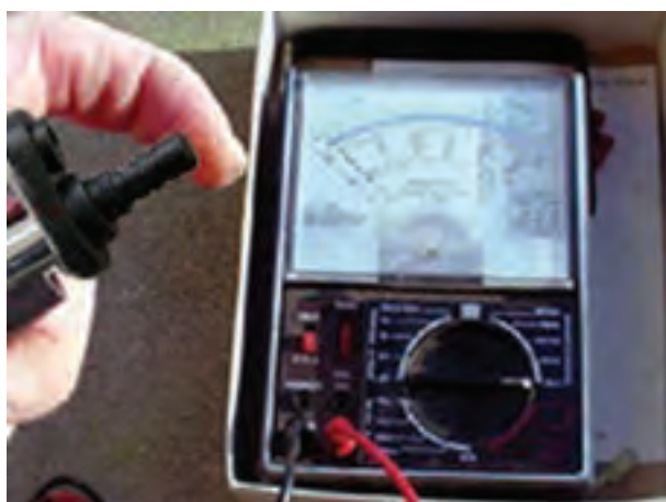
شکل ۱۹۶-۱- آزمایش سوئیچ لای در
