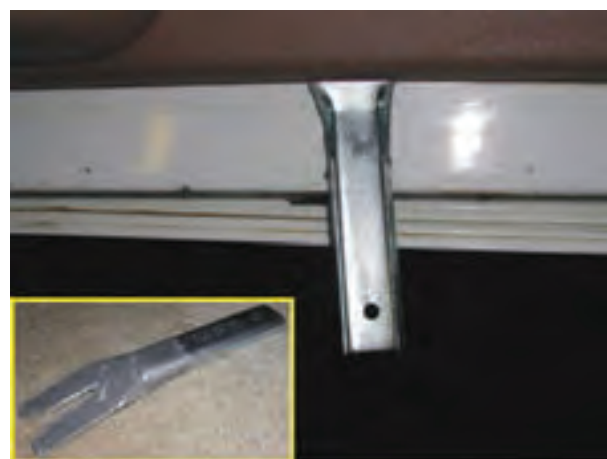
شکل ۲-۳۵- اهرم خاردرآر و نحوه‌ی استفاده از آن
