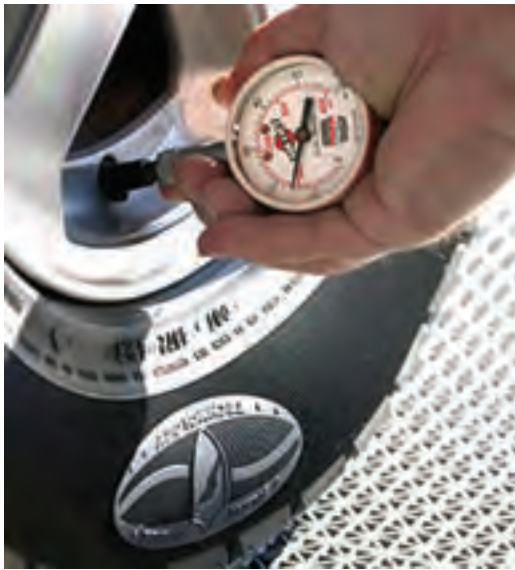
شکل ۱۵۸-۱- کنترل فشار باد تایر
