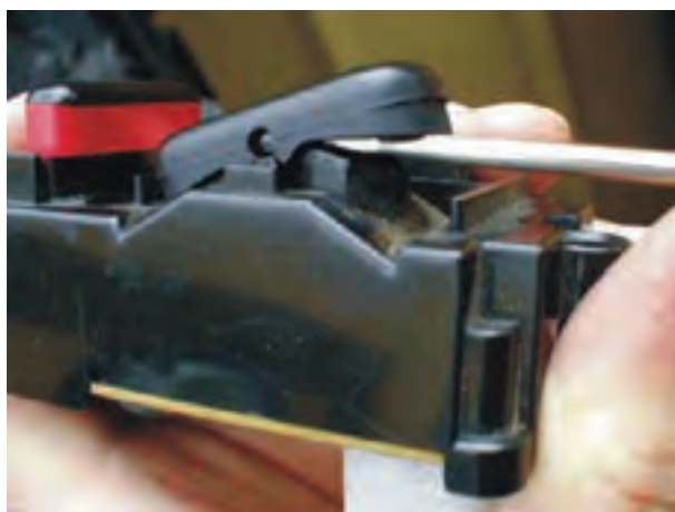
شکل ۲-۱۴۵- تعویض شستی معیوب
