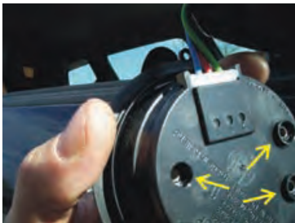
شکل ۱۷۲-۲- جدا کردن محفظه‌ی موتورهای الکتریکی
