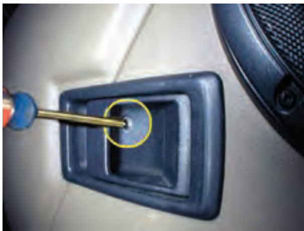
شکل ۳۶-۲- باز کردن قاب دستگیره‌ی قفل در
