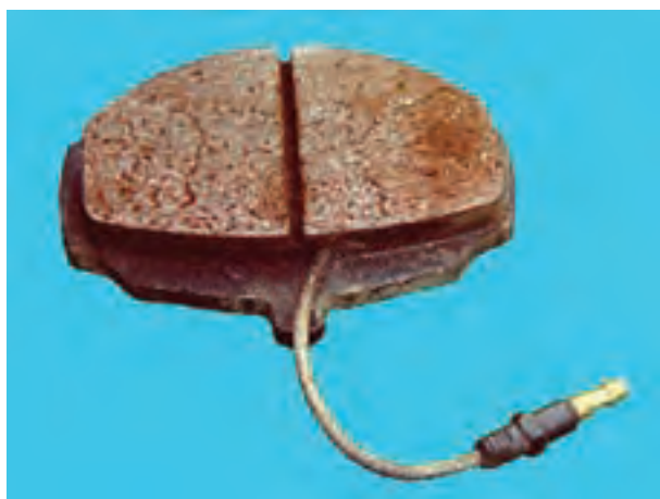
شکل ۲۰۴-۱- لنت ترمز دیسکی با اتصال الکتریکی آن
