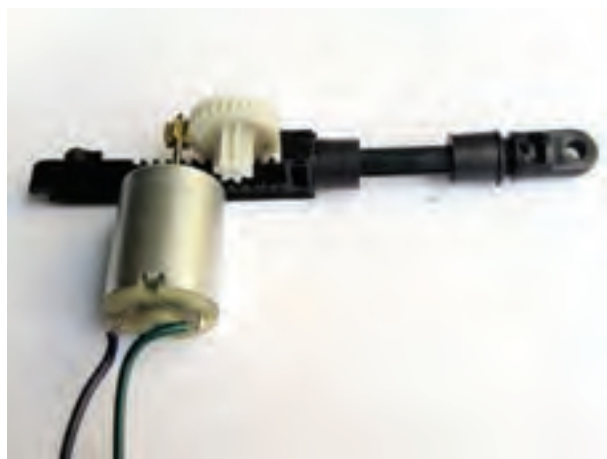
شکل ۲۰-۲- نحوه‌ی ارتباط چرخ‌دنده‌ها هنگام تبدیل دور
