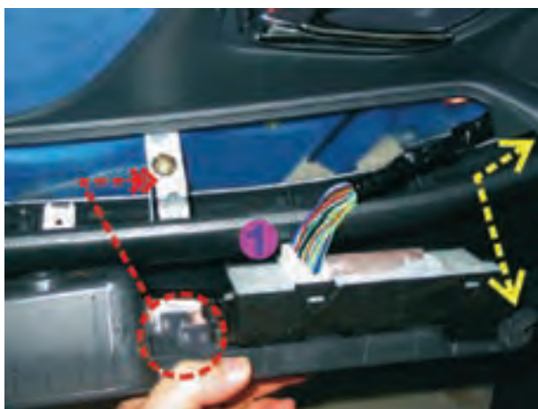
شکل ۱۸۴-۲ خارهای فلزی روی قاب سوئیچ‌ها و محل قرار گرفتن آنها
