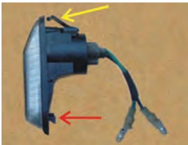
شکل ۱-۶۸- خار و فنر روی کاسه‌ی چراغ
