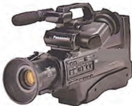
شکل ۴-۱۲ دوربین فیلمبرداری آنالوگ VHS
