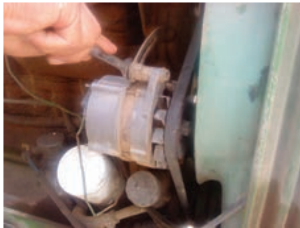
شکل ۳۸-۶ سفت کردن پیچ تنظیم آلترناتور
