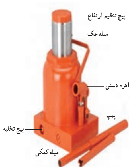
شکل ۹-۴- اجزای جک روغنی
