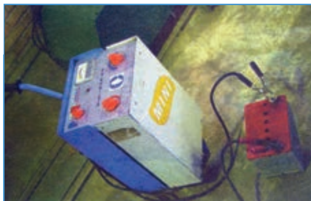
شکل ۱۸-۶- اتصال کابل‌های شارژر به باتری
