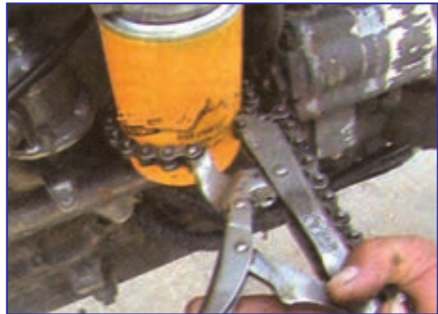
شکل ۱۶-۷- باز کردن صافی روغن با آچار مخصوص
