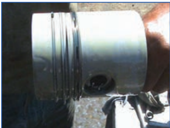
شکل ۱۴۰-۴- روغن کاری همه رینگ‌ها و پیستون
