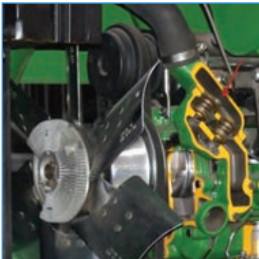
شکل ۲۴-۳ - طرز صحیح قرار گرفتن ترموستات
