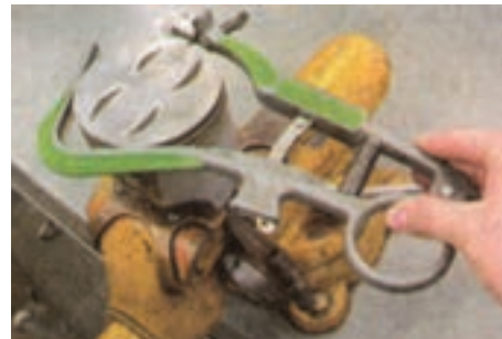
(ب) کاربرد ابزار تمیزکننده شیار رینگ‌ها
