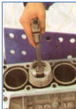
شکل ۱۲۷-۴- طرز قرار دادن رینگ داخل سیلندر
