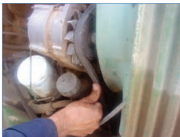
شکل ۳۶-۶- فشار دادن تسمه با شست
