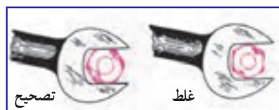
شکل ۲۹-۳- طرز درگیر کردن آچار تخت با مهره
