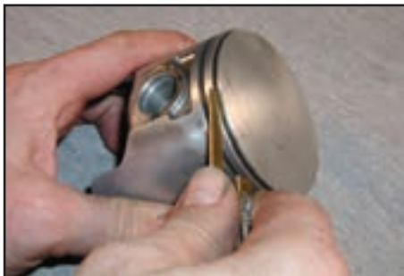
(د) تمیز کردن شیار با ابزار برنجی
