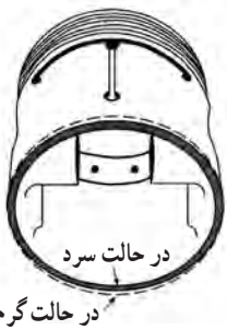
شکل ۱۹-۲- وضعیت پیستون در حالت گرم و سرد
