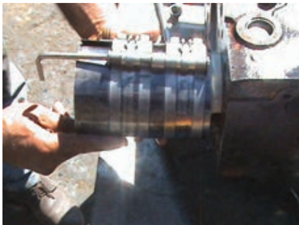
شکل ۱۹۸-۴- جمع کردن رینگها با رینگ جمع کن
