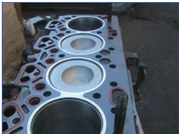
شکل ۵۲-۴- قرار دادن واشر سرسیلندر روی بدنه سیلندر
