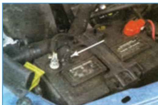
شکل ۳-۶- محل درجه شیشه‌ای در باتری خشک و طرز تعیین شارژ یا دشارژ بودن باتری توسط آن
