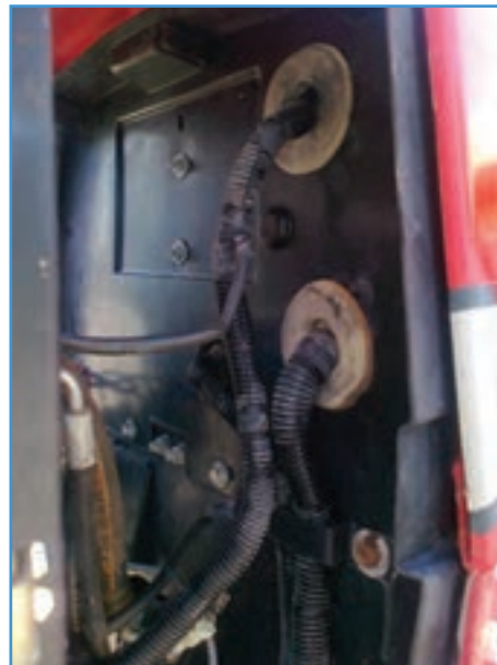
شکل ۵۷-۶- چند نمونه از سیم‌کشی که سیم‌ها در آنها با نظم کنار هم قرار گرفته‌اند.
