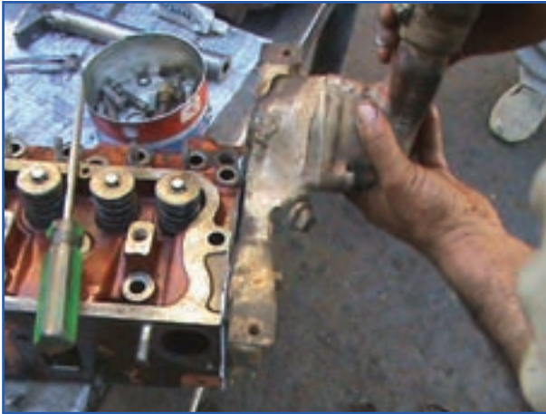
ب) باز کردن محافظه ترموستات تراکتور MF399
