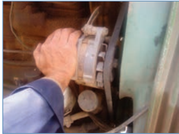
شکل ۳۰-۳- فشار دادن مولد به سمت موتور
