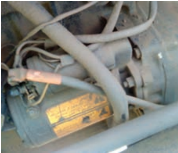
شکل ۴۳-۶- اتصال سیم‌ها از دینام به آف‌تامات
