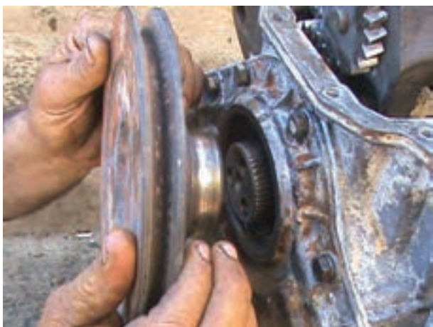
شکل ۴-۵۷- خارج کردن پولی میل لنگ
