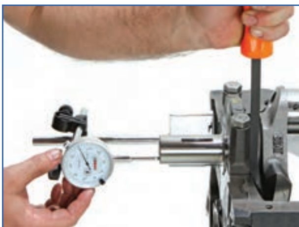
شکل ۱۷۹-۴- اندازه‌گیری لقی طولی میل‌لنگ با ساعت اندازه‌گیری
