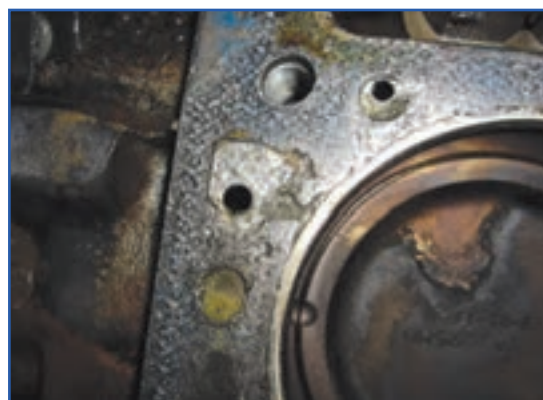
شکل ۴۲-۴- واشر سرسیلندر چسبیده به سیلندر
