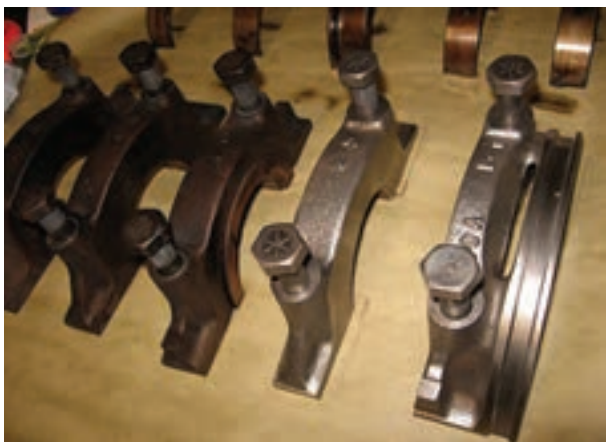
شکل ۱۵۴-۴- چیدن کپه یاتاقان‌ها
