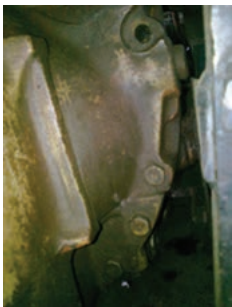
شکل ۱۱-۳- پیچ‌های اتصال موتور به جعبه‌دنده قسمت پایین
