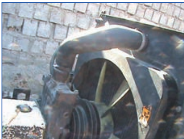
الف) باز کردن لوله لاستیکی رادیاتور
