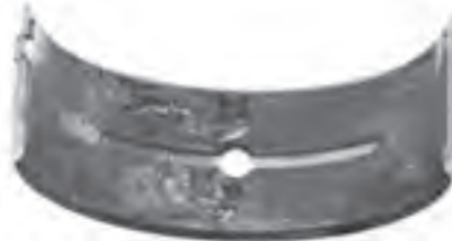
شکل ۱۶۷-۴ نقاط ذوب‌شده روی یاتاقان
