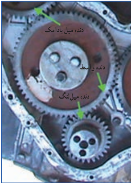
شکل ۱۲-۲- نسبت دنده میل بادامک به میل لنگ
