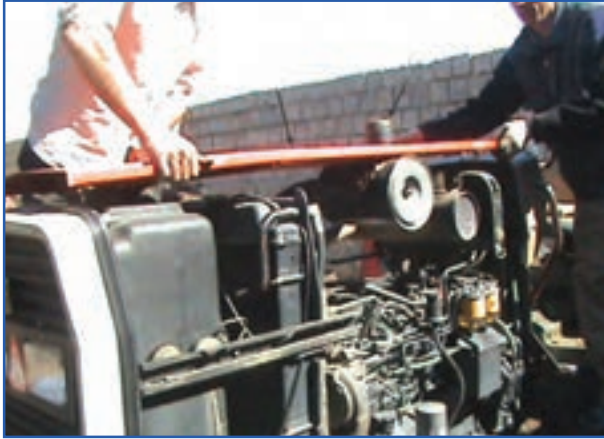
شکل ۱-۴- برداشتن کاپوت از روی موتور
