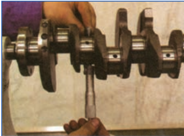
شکل ۱۶۲-۴- اندازه‌گیری قطر محورهای میل‌لنگ
