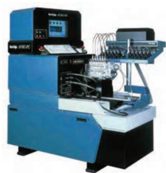
شکل ۲۴-۴- دستگاه آزمودن و تنظیم پمپ انژکتور
