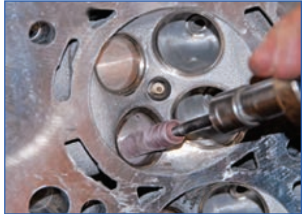
الف) نحوه تمیز کردن محفظه پشت سوپاپ
