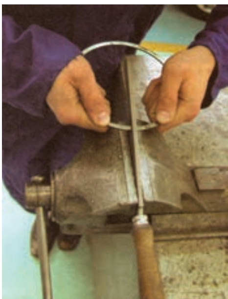
شکل ۱۳۰-۴- ساییدن دهانه رینگ با سوهان
