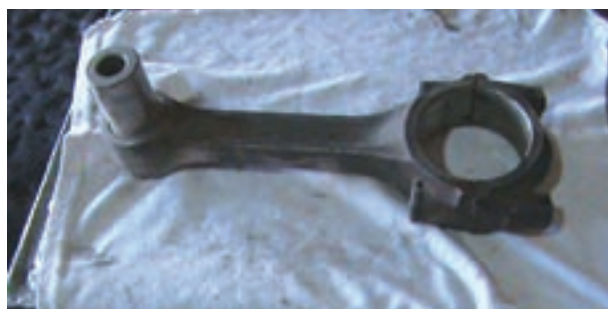
شکل ۱۲۱-۴ امتحان کردن انگشتی روی شاتون
