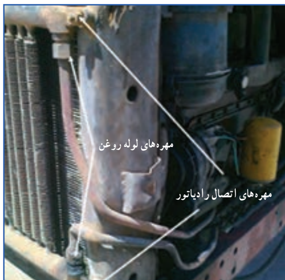
شکل ۳۸-۷- مهره های لوله روغن سمت رادیاتور روغن
