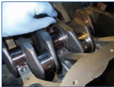
شکل ۱۸۳-۴- خارج کردن بغل یاتاقانی
