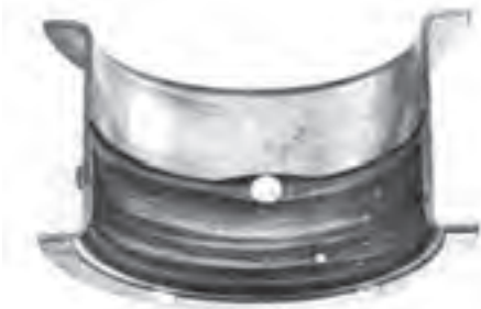
شکل ۱۶۵-۴ خط به دلیل نفوذ ذرات ریز و درشت بین میل‌لنگ یاتاقان
