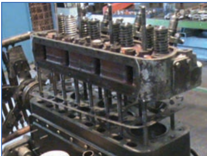
شکل ۲-۵- وضعیت قرار گرفتن واشر سرسیلندر
