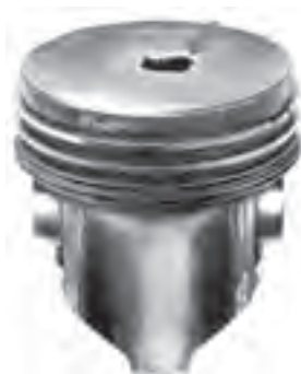
شکل ۴-۱۰۲- سوراخ شدن سر پیستون
