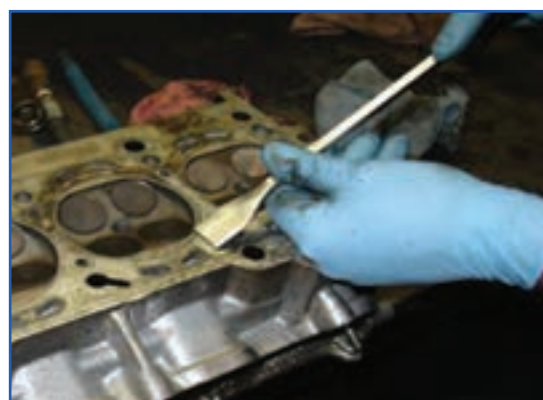
شکل ۴۲-۴- واشر سرسیلندر چسبیده به سیلندر
