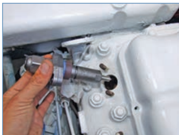
شکل ۲۳-۴- خارج کردن انژکتور
