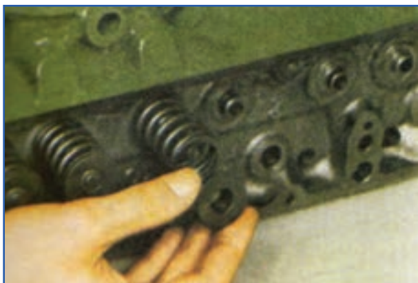
شکل ۴-۲۰- نحوه برداشتن بشقابک فنر سوپاپ
