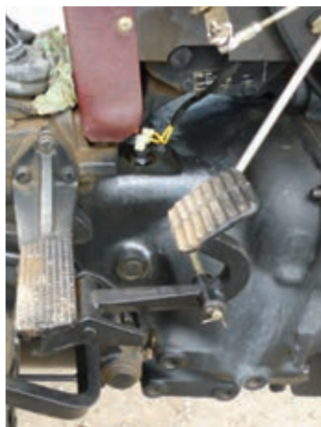
شکل ۱۱-۳- پیچ‌های اتصال موتور به جعبه‌دنده قسمت پایین
