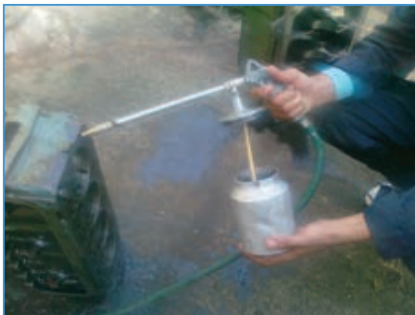
شکل ۱-۳- باز کردن مخزن پیستوله شستشو
