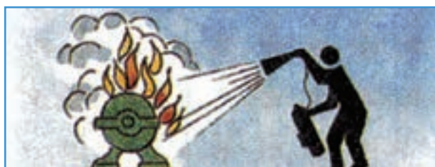
شکل ۱۴-۱- خاموش کردن آتش با دی اکسید کربن
