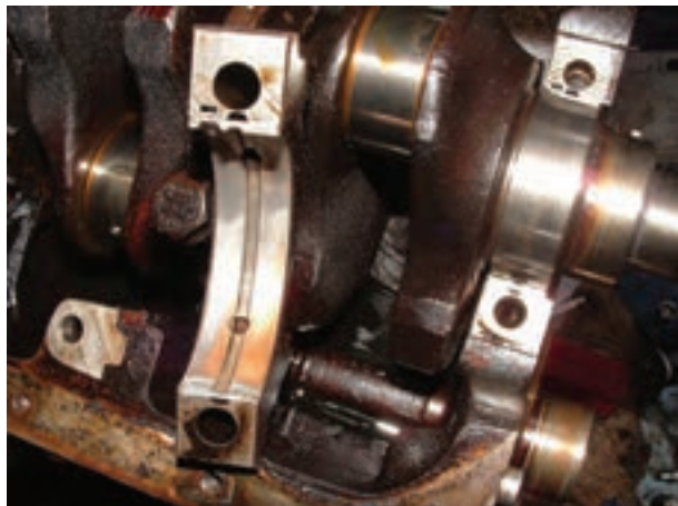
شکل ۱۸۲-۴- باز کردن کپه یاتاقان ثابت
