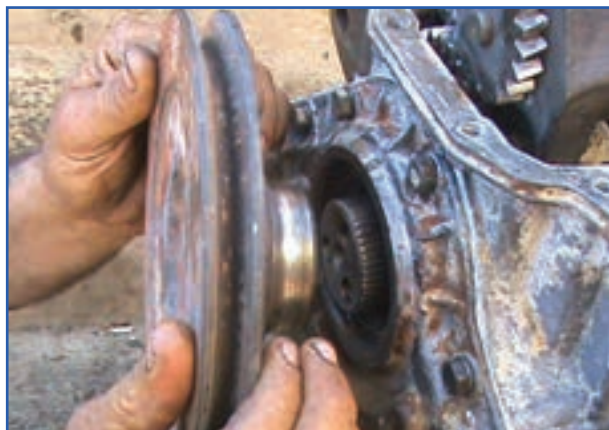
شکل ۴۶-۷- جازدن چرخ تسمه سر میل لنگ
