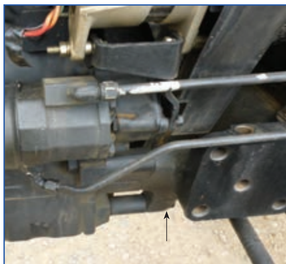
شکل ۱۷-۳- محل پیچ‌های اتصال موتور به جلوی تراکتور
