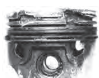
شکل ۴-۱۰۰- تخریب شدید جای رینگ
