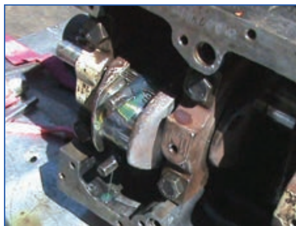
شکل ۲۰۳-۴- جا زدن شاتون روی میل لنگ
