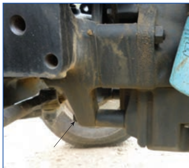
شکل ۱۷-۳- محل پیچ‌های اتصال موتور به جلوی تراکتور
