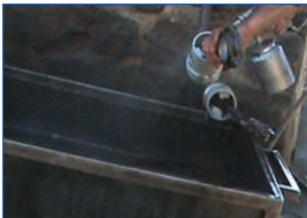
شکل ۱۳۶-۴- شستشوی پیستون و شاتون با پیستوله نفت شوی
