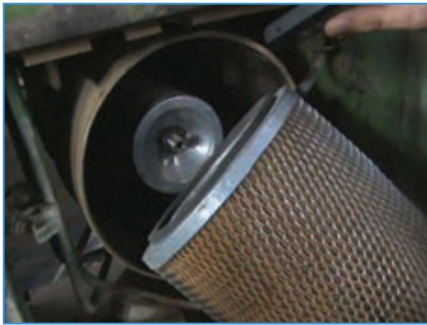
شکل ۵-۵ - صافی خشک و محل قرار گرفتن آن
