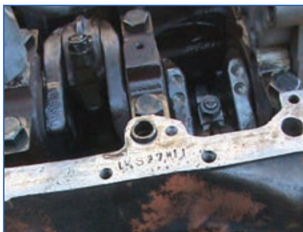
شکل ۸۲-۴- محفظه میل‌لنگ بدون بلمپ روغن
