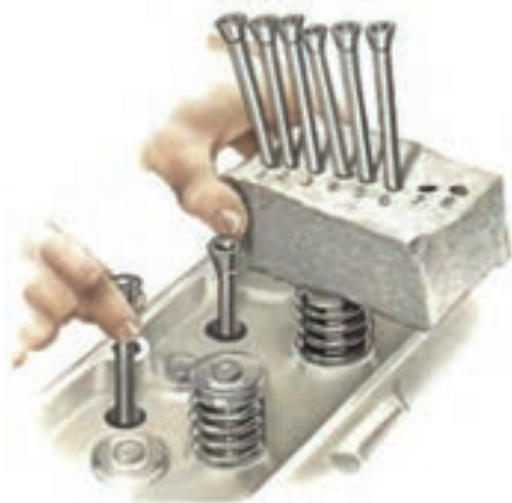
ب) به ترتیب قرار دادن میل تایپت
