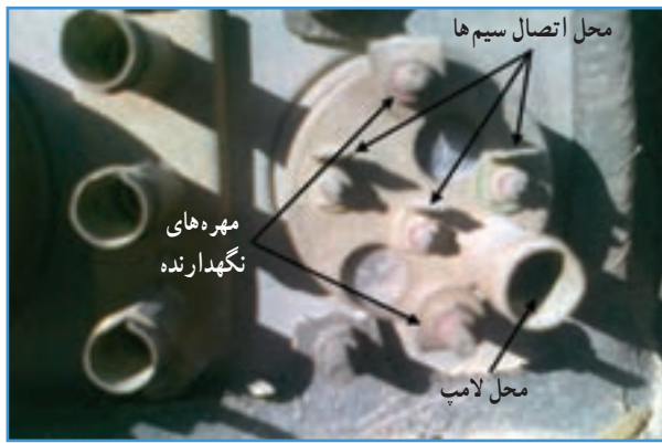
شکل ۸۶-۶- درجه نشان‌دهنده سطح گازوئیل در باک از پشت داشبورد
