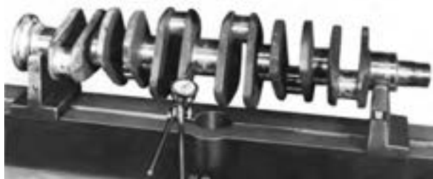
شکل ۱۶۰-۴- دستگاه اندازه‌گیری تاب میل‌لنگ
