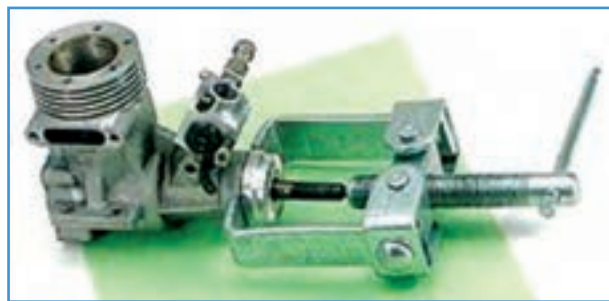
شکل ۷۷-۳- خارج کردن بلبرینگ با بلبرینگ کش
