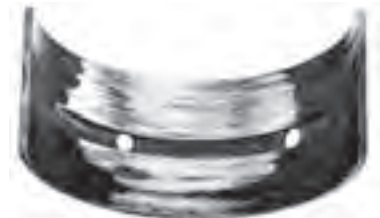
شکل ۱۶۶-۴ سایش یاتاقان به دلیل لقی کم بین میل‌لنگ و یاتاقان
