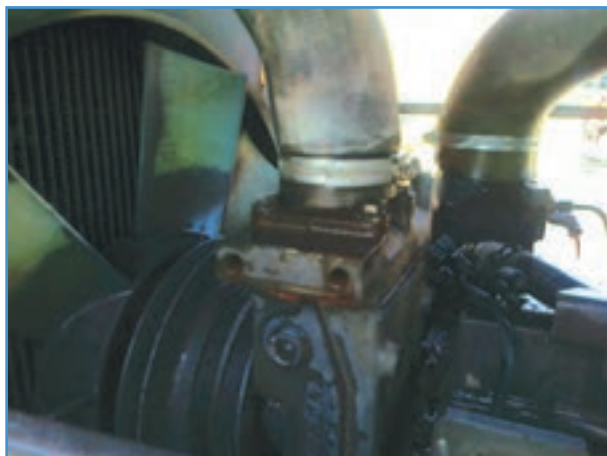
شکل ۱۱-۳- محل بست شیلنگ محفظه ترموستات
