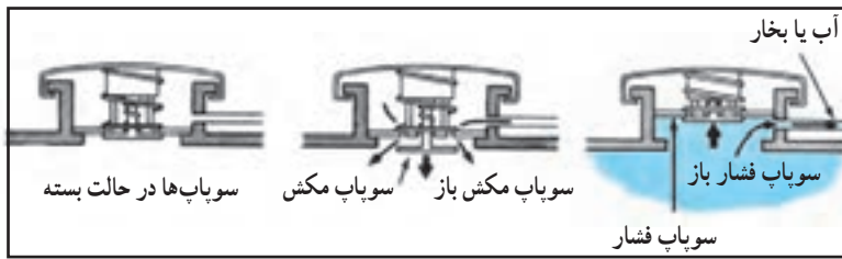
الف) وضعیت سوآپ‌های در رادیاتور
