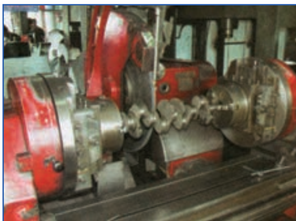
شکل ۱۶۴-۴- دستگاه میل‌لنگ تراشی
