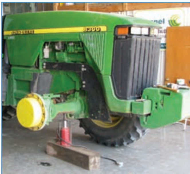
شکل ۱۱-۴- قرار دادن جک روغنی زیر جسم سنگین
