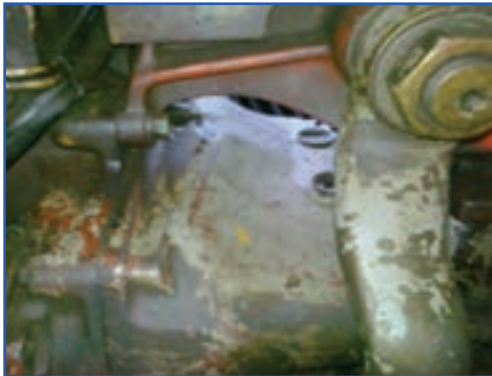
شکل ۹-۳- پیچ‌های اتصال موتور به جعبه‌دنده قسمت بالا
