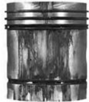
الف) خط و خش روی پیستون
