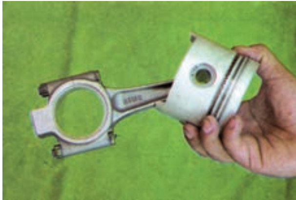
شکل ۱۲۶-۴- طرز آزمایش لقی شاتون روی انگشتی
