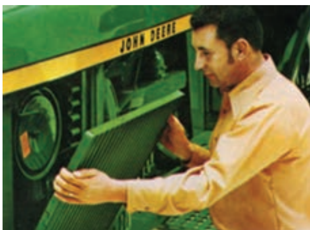
شکل ۱۰-۵ باز کردن شبکه بغل
