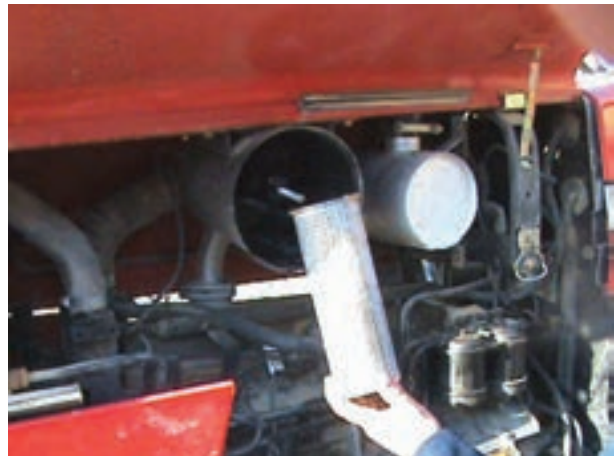
(الف) خارج کردن صافی ثانویه
