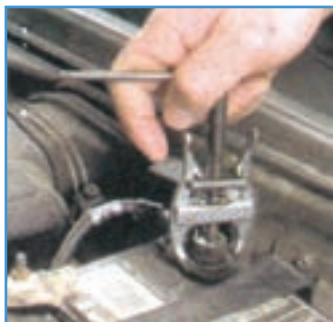
شکل ۶-۷ جدا کردن بست منفی باتری
