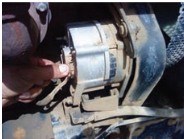
شکل ۲۸-۶- جدا کردن فیش از آلترناتور
