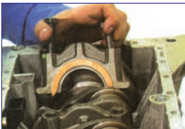
شکل ۱۸۱-۴- برداشتن کپه یاتاقان دارای بغل یاتاقانی
