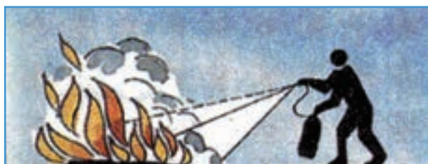
شکل ۱۳-۱- روش خاموش کردن آتش با پودر
