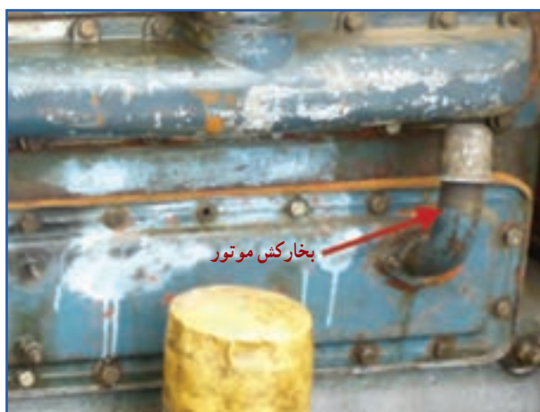
شکل ۲۶-۷- تهویه محفظه کارتر تراکتور U650M
