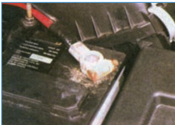
شکل ۲۱-۶- سولفاته کردن بست مثبت باتری
