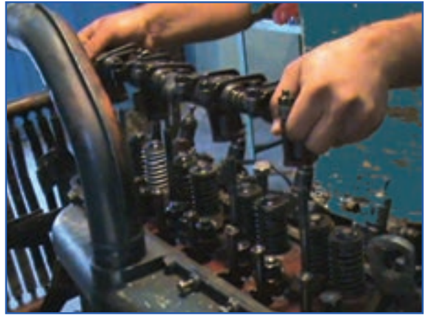
شکل ۹-۴- برداشتن محور اسبک و اسبک‌ها تراکتور U650
