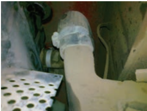
شکل ۱۵-۳- اتصال شیلنگ رادیاتور
