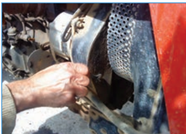
شکل ۳۲-۶ باز کردن روکش محافظ تسمه
