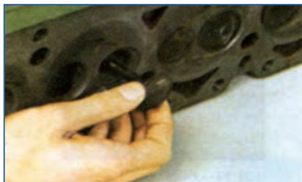
شکل ۲۳-۴- نحوه خارج کردن سوپاپ‌ها
