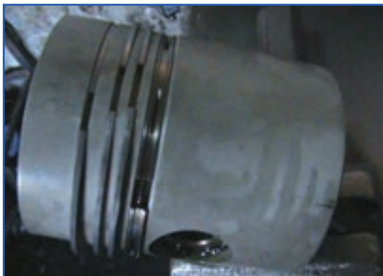
شکل ۱۳۹-۴- ترتیب قرار گرفتن رینگ‌ها روی شیار پیستون
