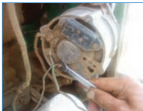
شکل ۳۵-۶- بستن سیم نازک
