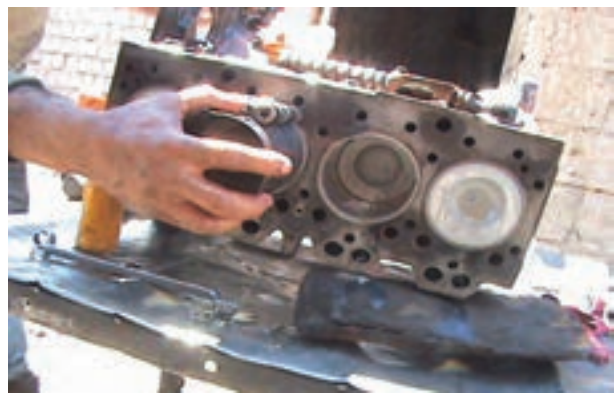
شکل ۱۹۹-۴- چسباندن رینگ جمع کن به سیلندر
