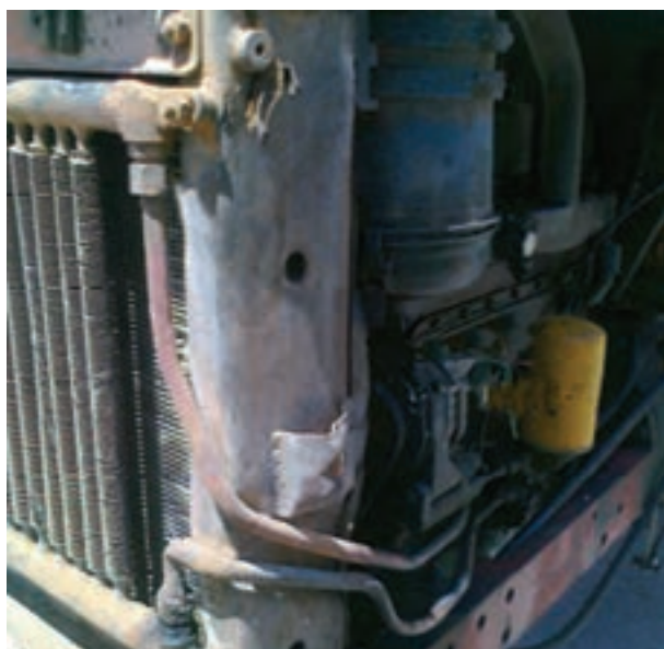
شکل ۱۲-۳- محل مهره‌های رادیاتور روغن
