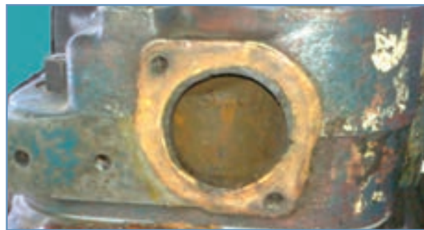
شکل ۲۳-۳ - واشر ترموستات قبلی
