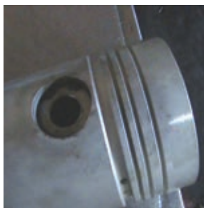
شکل ۱۲۳-۴ میزان داخل شدن انگشتی در پیستون
