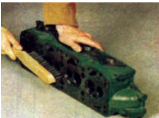
ب) کربن گرفتن سطح سرسیلندر شکل ۳۶-۴- برس زدن کف سرسیلندر
