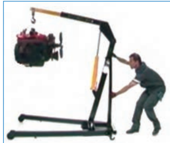
شکل ۱۸-۴- کاربرد از جرثقیل متحرک دستی
