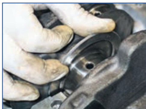
شکل ۱۸۴-۴- جازدن بغل یاتاقانی
