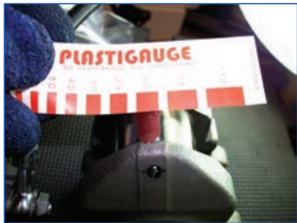
شکل ۱۷۶-۴- اندازه گیری دو بهنی پلاستی گیج شابلون
