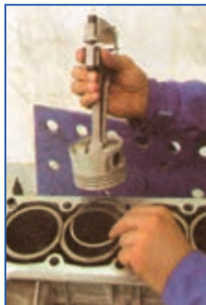
شکل ۱۲۷-۴- طرز قرار دادن رینگ داخل سیلندر
