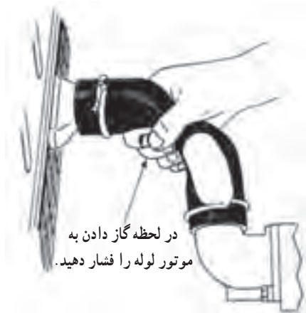
شکل ۲۰-۳- نحوه فشار دادن شیلنگ بالای رادیاتور
