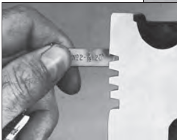
شکل ۹۳-۴- طرز اندازه‌گیری لقی رینگ در شیار رینگ‌ها با فیله
