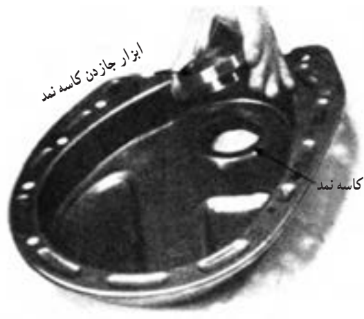
شکل ۴۳-۷- نحوه جازدن کاسه نمد روی سینی جلو
