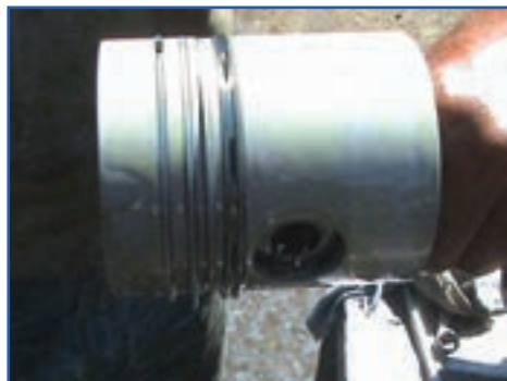
شکل ۱۹۲-۴- روغن‌کاری رینگ‌ها، پیستون و یاتاقان
