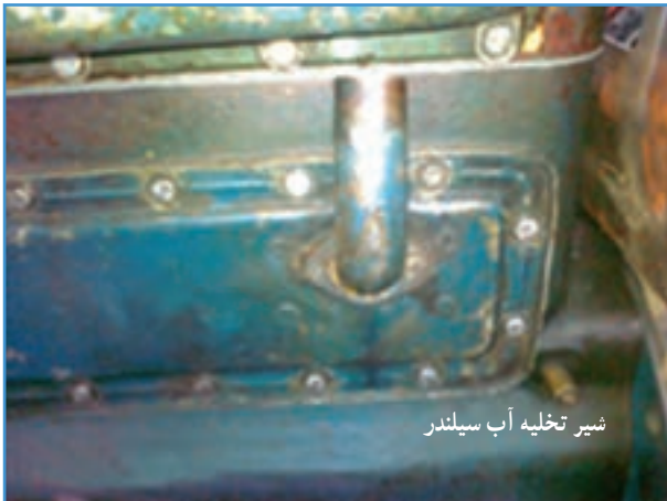
شکل ۳-۸- شیر تخلیه آب سیلندر تراکتور U650
