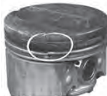
شکل ۴-۹۹- شکستن رینگ و تخریب جای رینگ
