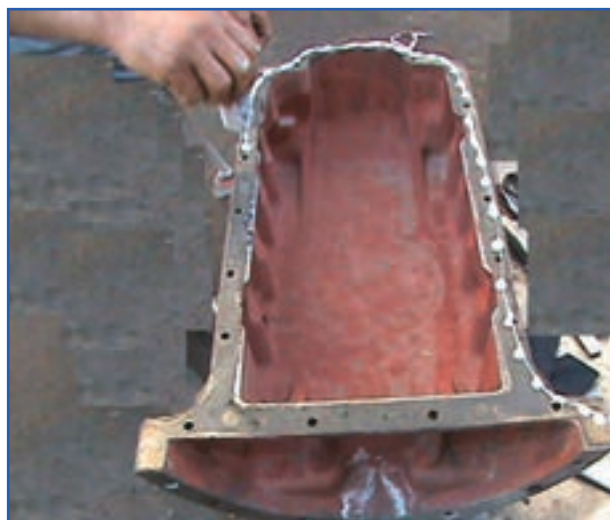
شکل ۳۲-۷- چسب زدن به محل قرارگیری واشر کارتر
