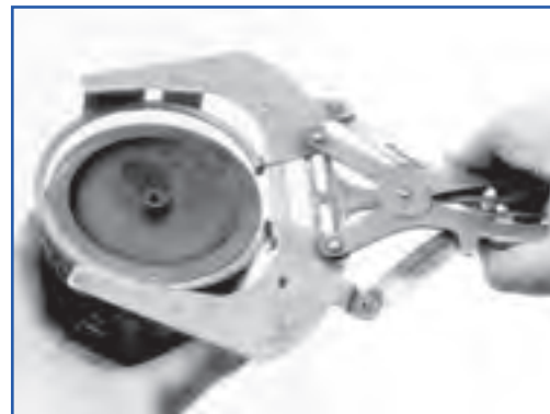
ب) طرز قرار گرفتن رینگ باز کن روی رینگ
