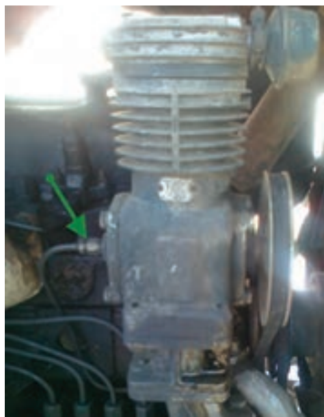
شکل ۵-۸- لوله روغن کاری کمپرسور در تراکتور U650
