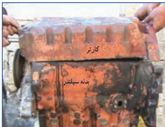
ب) برداشتن کارتر
