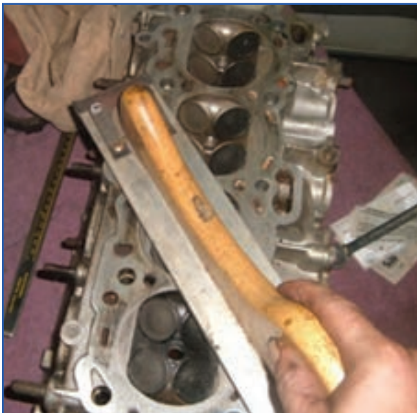
شکل ۴۴-۴- تمیز کردن سرسیلندر با سوهان نرم
