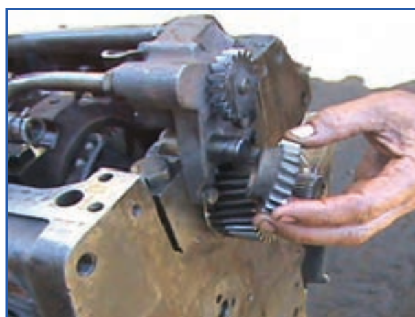
شکل ۸۰-۴- خارج کردن چرخ‌دنده بلمپ روغن
