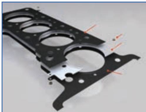
شکل ۴-۴۹ - ساختمان واشر سرسیلندر
