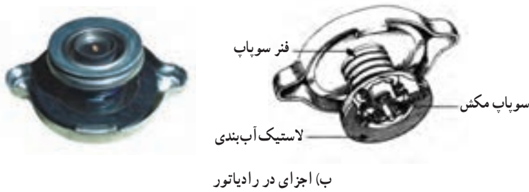
شکل ۳-۵- در رادیاتور و طرز کار سوآپ‌های آن
