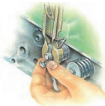
شکل ۴-۱۸- نحوه خارج کردن خار سوپاپ
