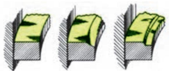
شکل ۱۳۲-۴- فرم خاص در لبه داخلی رینگ
