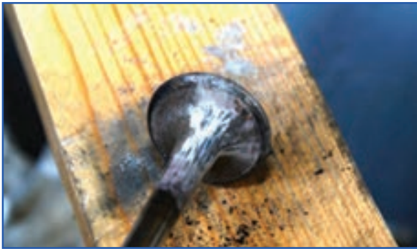
(ب) سوپاپ تمیز شده با کاردک
