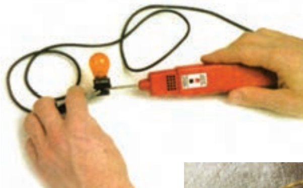
الف) لامپ آزمایش باتری دار
