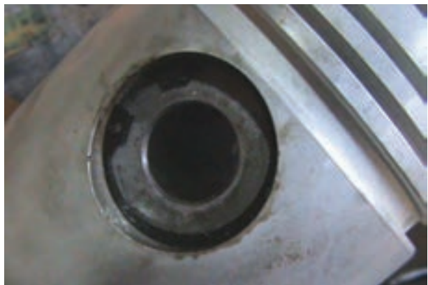
شکل ۱۲۵-۴- جا افتادن خار انگشتی در شیار پیستون
