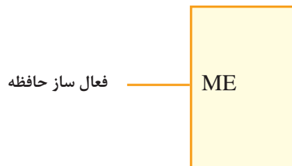
شکل ۷-۲۷- فعال ساز حافظه یک خط کنترل است.
