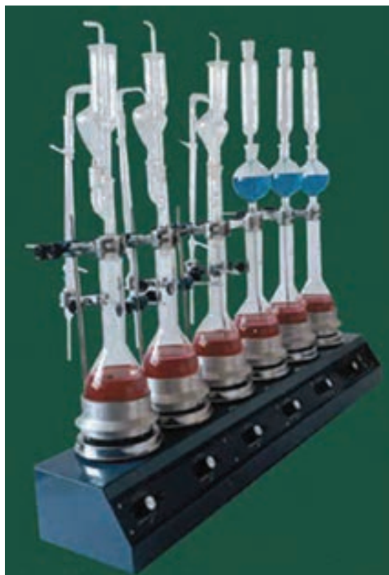
شکل ۴-۱- دستگاه اندازه‌گیری پروتئین (کلدال)
