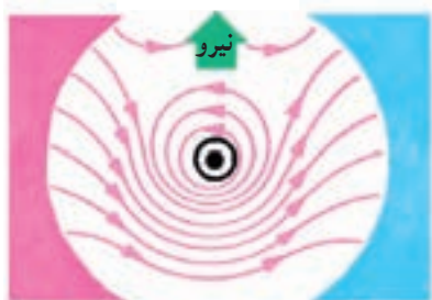
شکل ۳۶-۵ اثر میدان مغناطیسی بر سیم حامل جریان
