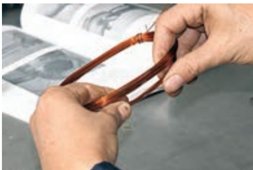
شکل ۱۶-۶- مرتب کردن سیم‌ها جهت کلاف گذاری
