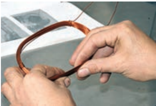
شکل ۱۵-۶- طریقه در دست گرفتن کلاف
