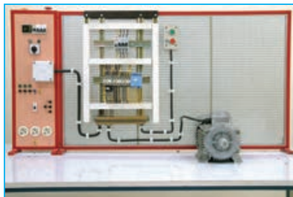
شکل ۳-۵- راه اندازی موتور سه فاز آسنکرون به صورت ستاره - مثلث اتوماتیک
