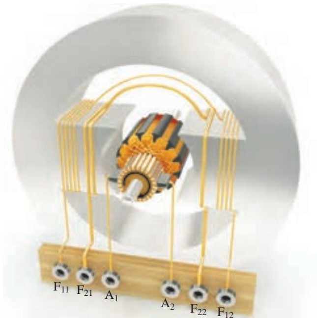
شکل ۳-۳۵ طرح ساختمانی ژنراتور کمپوند
