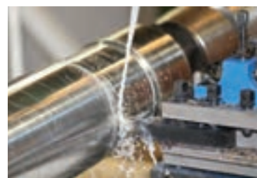
شکل ۲-۳۱ قطعه در حال تراش بدون براده برداری
