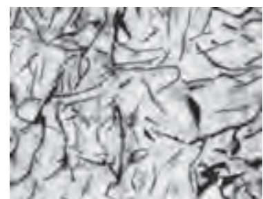
شکل ۲-۴۹ چدن خاکستری با گرافیت ورقه‌ای
