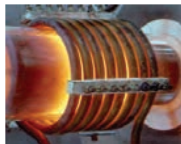
شکل ۲-۴۶ سختی سطحی به روش القایی
