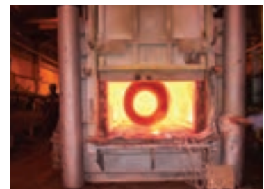
شکل ۲-۴۳ کوره عملیات حرارتی کارگاهی
