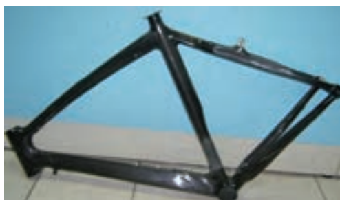
شکل ۱-۱۸ بدنه یک دوچرخه از الیاف کربن
