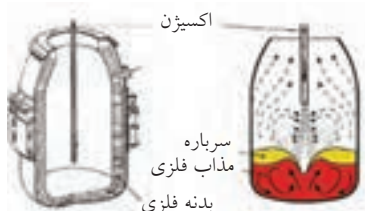
شکل ۲-۸ کوره L-D یکی از روش‌های تولید فولاد.
