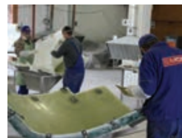
شکل ۱-۱۶ قالب‌گیری و تولید قطعات فایبرگلاس
