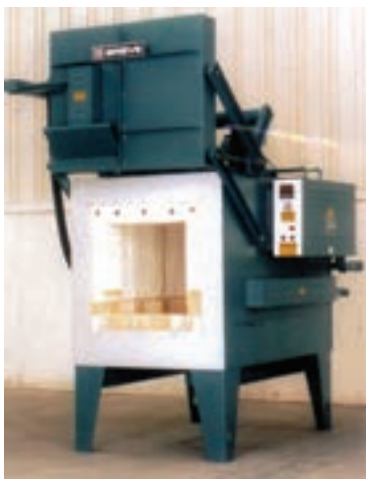
شکل ۸-۴ دیواره کوره از جنس سرامیک
