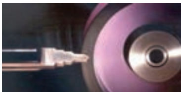
شکل ۱-۳۳ ابزار تیزکن از جنس الماس
