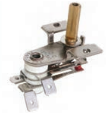
شکل ۱-۴۲ یک نوع ترموستات را نشان می‌دهد. ورقه‌های فلزی با جنس‌های مختلف و ضریب انبساط حرارتی مختلف اساس کار این وسیله است.
