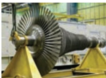
شکل ۲-۳۵ کاربرد فولادهای نسوز در تولید توربین‌های گازی
