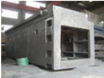
شکل ۲-۵۰ پایه یک ماشین ابزار از جنس چدن خاکستری
