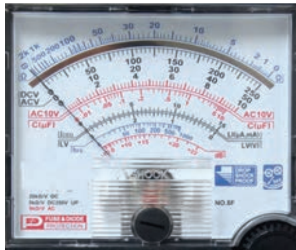
شکل ۲-۱۵- صفحه مدرج یک نمونه مولتی متر آنالوگ
