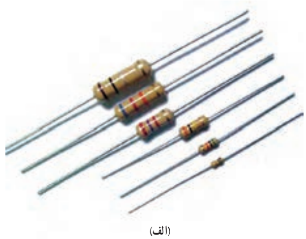
شکل ۴۵-۱- توان قابل تحمل مقاومت‌ها
