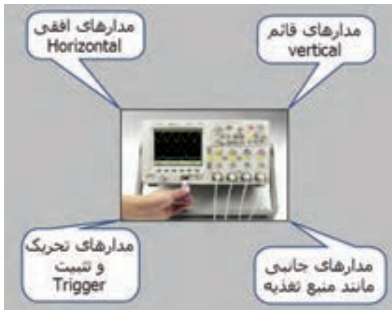
شکل ۵-۷ مدارهای داخلی اسیلوسکوپ
