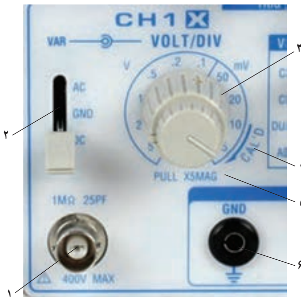
شکل ۱۴-۵- سلکتورها، ولوم‌ها و ترمینال‌های ورودی اسیلوسکوپ
