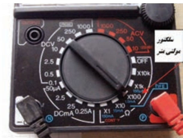
شکل ۱۴-۲- یک نمونه کلید سلکتور مولتی متر عقربه‌ای
