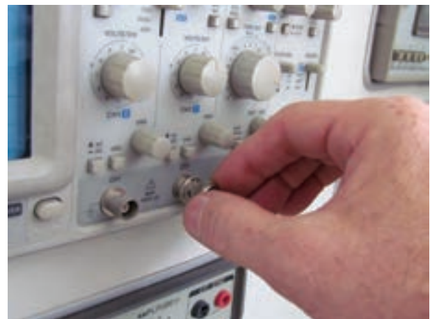
شکل ۵-۱۲ چگونه اتصال BNC به اسیلوسکوپ
