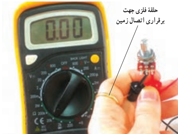
شکل ۳-۸- اتصال مقاومت متغیر به مولتی‌متر دیجیتالی
