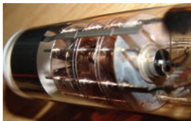
شکل ۴-۵. ساختمان داخلی تفنگ الکترونی
