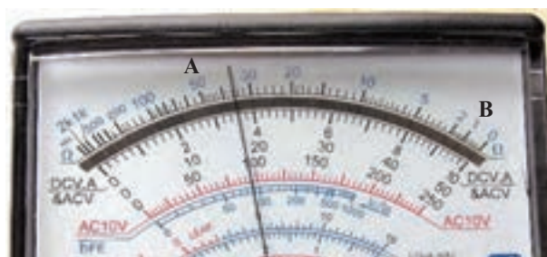
شکل ۲۲-۲- منطقه مناسب برای خواندن مقدار مقاومت
