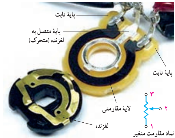
شکل ۲-۳- ساختمان داخلی مقاومت
