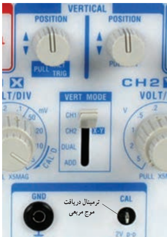
شکل ۱۸-۵- قسمت‌های مشترک و سایر تنظیم‌کننده‌های قسمت عمودی
