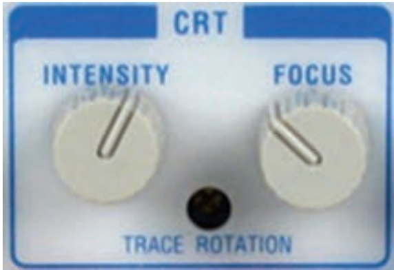
شکل ۵-۶ ولوم‌های تنظیم شدت نور و تمرکز اشعه
