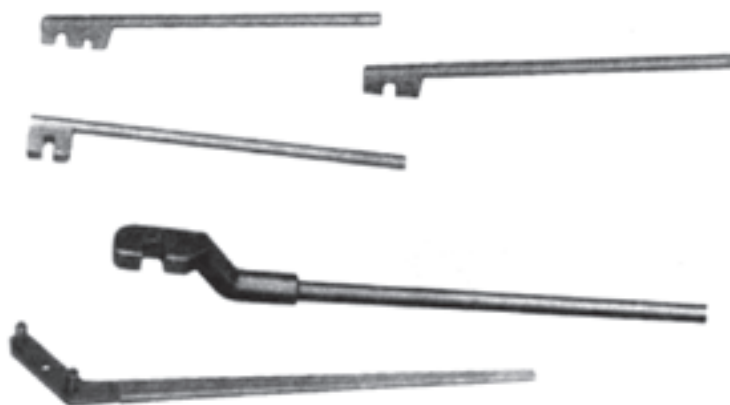
شکل ۵۹-۲ چند نمونه آچار F
