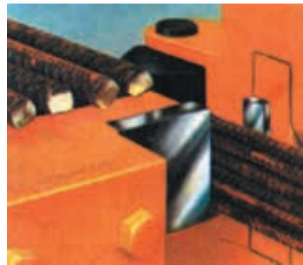
شکل ۵۶-۲- یک نمونه ماشین برقی برش میل‌گرد
