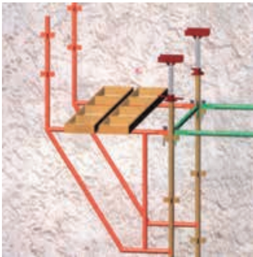
شکل ۷-۴۵ - سکوی کار برای داربست فلزی
