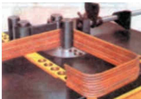
شکل ۶۶-۲- دستگاه خاموت خم کن برقی
