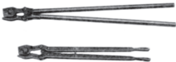
شکل ۵۳-۲- قیچی‌های دستی ساده برای برش میل‌گرد فولادی
