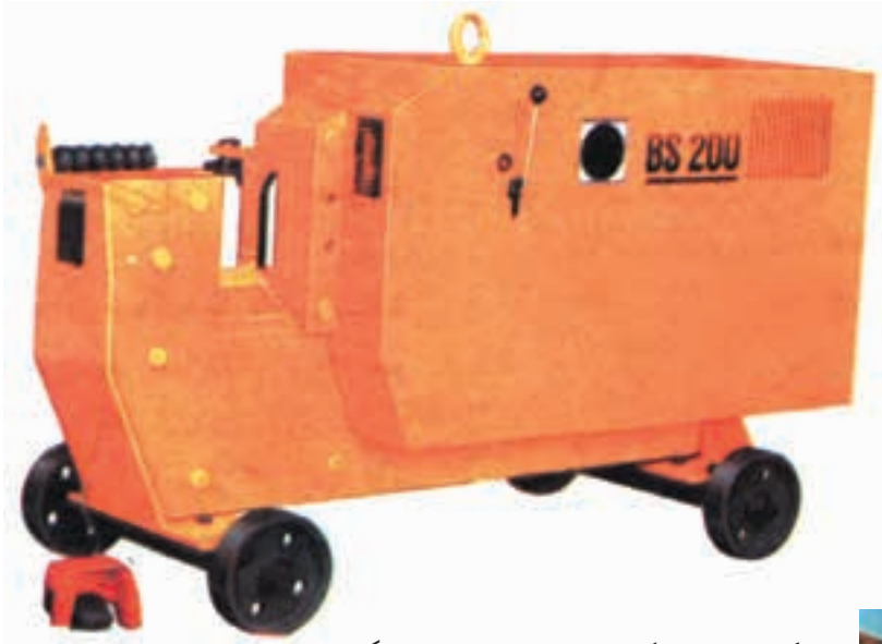
شکل ۵۶-۲- یک نمونه ماشین برقی برش میل‌گرد
