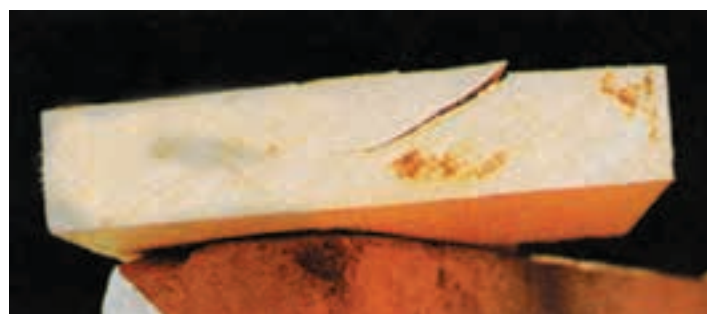
شکل ۳۵-۱- ورقه شدن چوب به وضوح دیده می‌شود.
