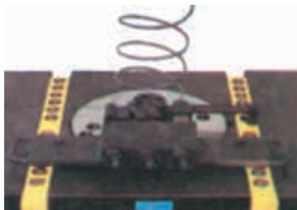
شکل ۶۸-۲- دستگاه خاموت خم کن برقی (ماربیچی)
