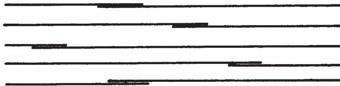
شکل ۴۰-۲- محل های اتصال میل گردها تا آنجا که ممکن است پراکنده باشند.
