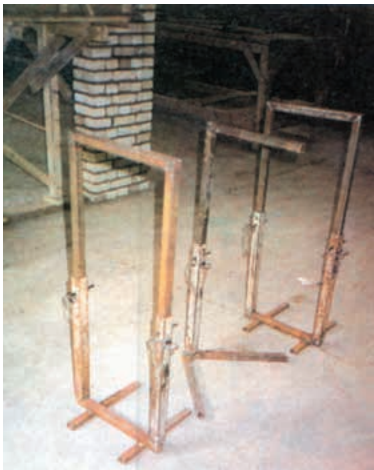
شکل ۹۴-۲- خرک های فلزی برای مونتاژ میل گرد
