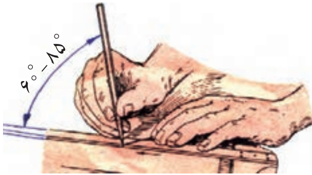
شکل ۵-۲- زاویه‌ی مناسب مداد
