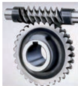
(الف) مکانیزم پیچ حلزون
