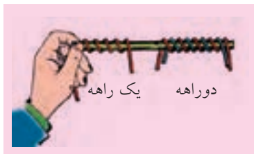
(ب) تشکیل پیچ یک‌راهه و دوراهه
