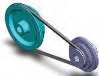
(ب) مکانیزم چرخ‌تسمه
