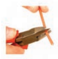
ب - سیم چین در حال بریدن یک سیم
