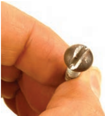
شکل ۳-۴- اثرات استفاده نامناسب از ابزار
