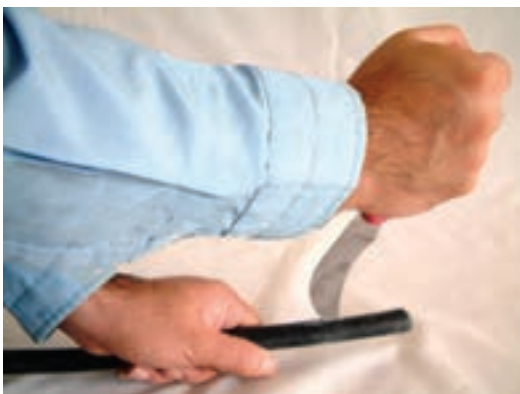
شکل ۳-۱۶- طرز صحیح روکش برداری از کابل
