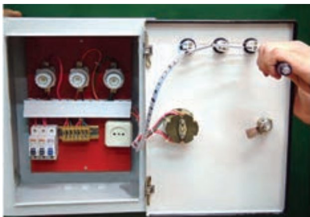
شکل ۹-۱۷- مونتاژ و تست تابلو
