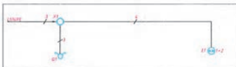
شمای فنی مدار کلید دوپل
