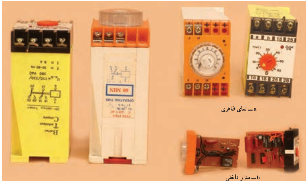
شکل ۸-۲۳- نمای ظاهری و مدار داخلی تایمر الکترونیکی
