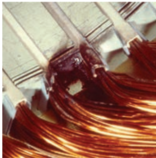
شکل ۲-۲ - اتصال سیم‌های حامل جریان با بدنه فلزی یک موتور الکتریکی
