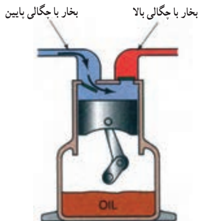
شکل ۳-۴- پیستون رو به پایین حرکت می کند.
