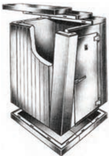
شکل ۲۱-۱۰- اتاق سرد جازدنی - که در محل قابل مونتاز است. پنل‌ها از فوم با فلز در هرسو ساخته شده‌اند. این جعبه پیش ساخته می‌تواند در بیرون یا داخل قرار گیرد.
