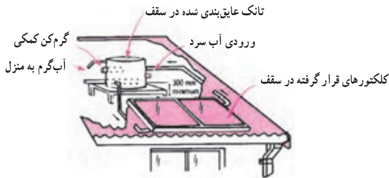
شکل ۹-۱۳- سیستم ترموسیفونی با مخزن مجزا (فشار ثابت)
