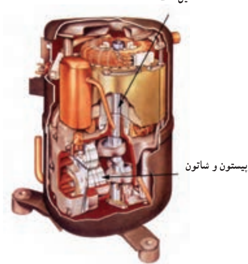
(ب) برش کمپرسور بسته
