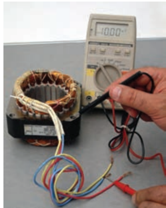
شکل ۸-۱۰- تست اتصال بدنه
