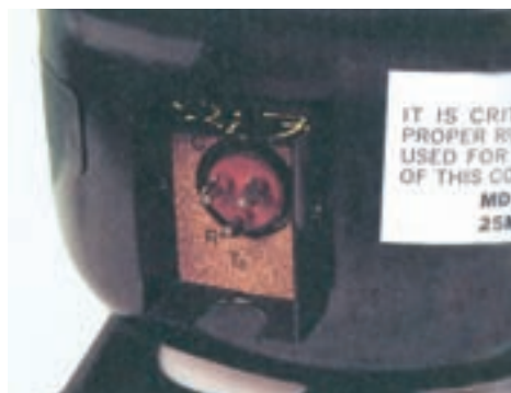
(د) جعبه ترمینال موتور کمپرسور
