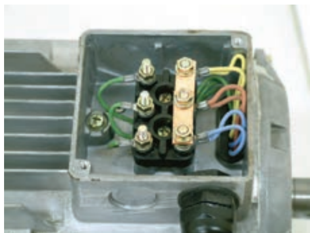
شکل ۹-۱۳ اتصال ستاره سیم‌پیچ‌های موتور
